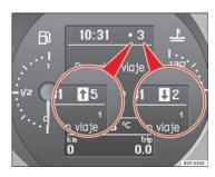
Fig. 38 Gear display
