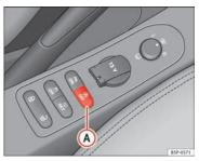
Fig. 120 The Start-Stop function button.
