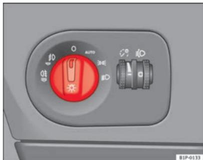
Fig. 71 Pormenor do painel de instrumentos: comando das luzes, faróis de nevoeiro e luz de nevoeiro traseira
