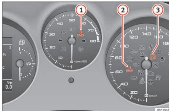
Fig. 49 Avisos de controlo e de advertência do painel de instrumentos em veículos com GPL.
