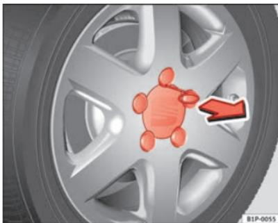
Fig. 155 Substituição de pneu: Retirar o embelezador da roda
