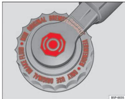
Fig. 151 Tampão do reservatório do líquido dos travões no compartimento do motor
