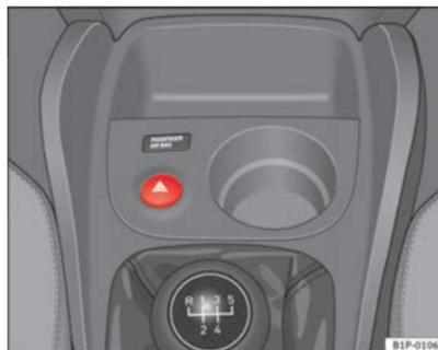
Fig. 75 Painel de instrumentos: comutador das luzes de emergência
