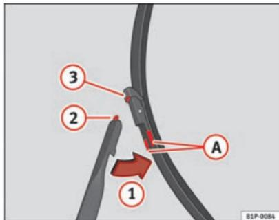
Fig. 148 Substituição das escovas do limpa pára-brisas
