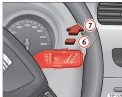
Fig. 84 Manípulo do limpa/lava-vidros: limpa-vidros traseiro
