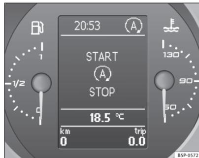
Fig. 120 Indicação no visor do painel de instrumentos durante o funcionamento Start-Stop.
