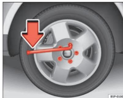
**Fig. 156** Substituição de pneu: desapertar os parafusos da roda
