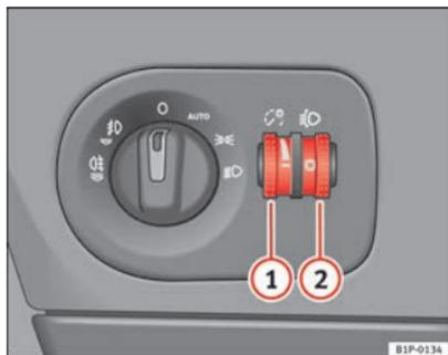
Fig. 73 Painel de instrumentos: reguladores da iluminação dos instrumentos, dos comandos e do alcance dos faróis
