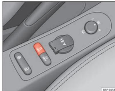
**Fig. 116** Pormenor da consola central: tecla ESC (ESP)
