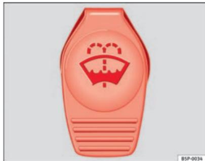
Fig. 147 Tampão do reservatório do limpa-vidros no compartimento do motor.
