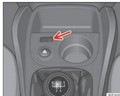
Fig. 26 Aviso de controlo da desactivação do airbag do passageiro
