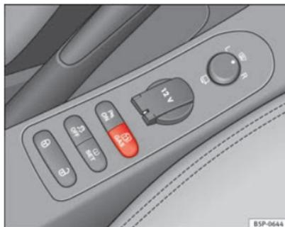
Fig. 118 Consola central: comutador de controlo do sistema de gás.
