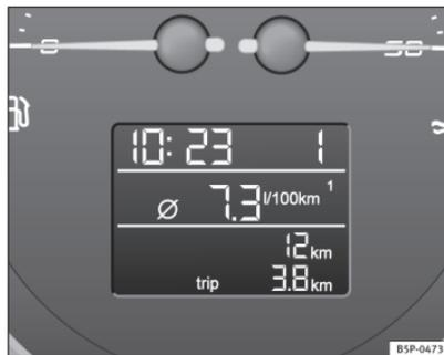
Fig. 42 Visor digital do painel de instrumentos: indicador consumo médio de combustível.
