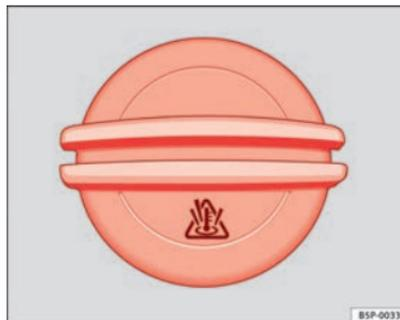
**Fig. 146** Tampão do reservatório de expansão do líquido de refrigeração no compartimento do motor
