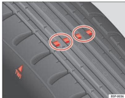
**Fig. 152** Indicadores de desgaste no perfil do pneu
