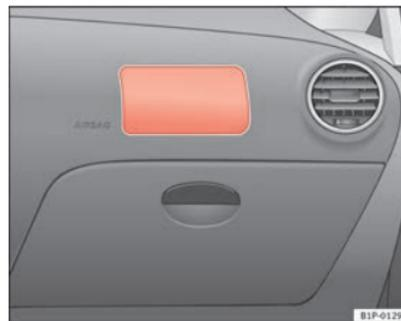
**Fig. 18** Airbag do passageiro no painel de instrumentos
