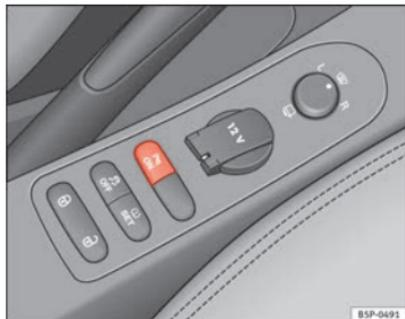
Fig. 130 Consola central: Interruptor de auxílio de estacionamento
