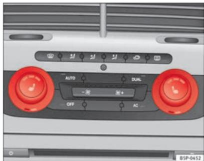
**Fig. 92** Aquecimento dos bancos dianteiros com Climatronic
