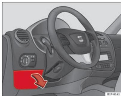
Fig. 160 Tampa da caixa dos fusíveis no lado esquerdo do painel de instrumentos
