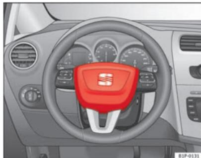
**Fig. 17** Airbag do condutor no volante
