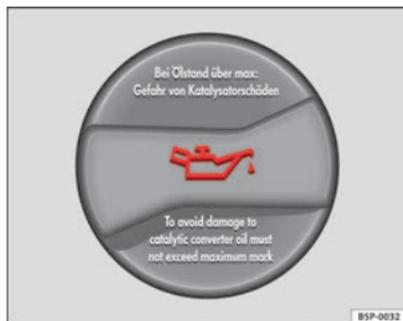
Fig. 145 Tampa do bocal de enchimento do óleo do motor no compartimento do motor
