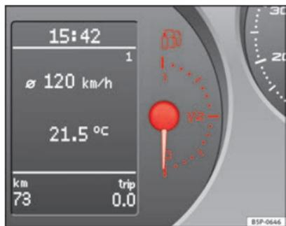
Fig. 35 Painel de instrumentos: indicador do nível de gás.
