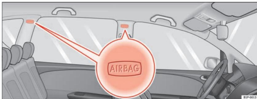
**Fig. 23** Localização de montagem dos airbags da cabeça do lado esquerdo do veículo
