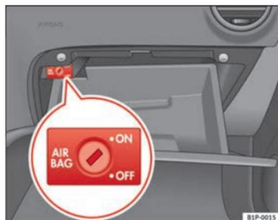
Fig. 25 No porta-luvas: comutador com chave para activar e desactivar o airbag do passageiro
