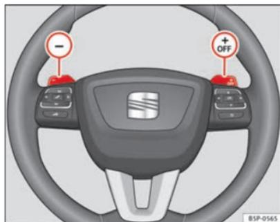
Fig. 128 Volante com pautas para a caixa de velocidades automática
