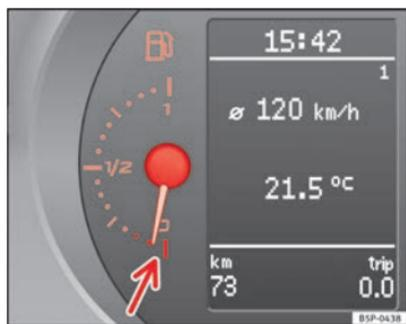
Fig. 33 Painel de instrumentos: indicador do nível do depósito de combustível
