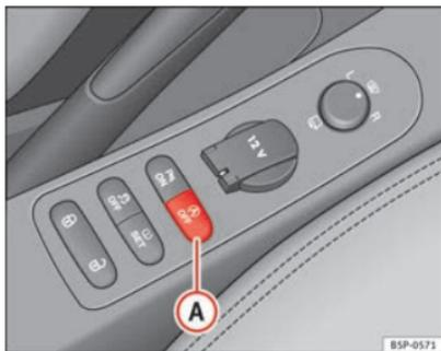
Fig. 119 Pormenor do botão do funcionamento Start-Stop.
