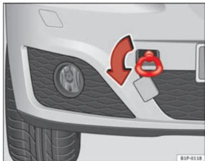
Fig. 182 Enroscamento da argola de reboque na parte dianteira direita do veículo
