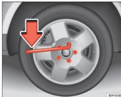
Fig. 156 Cambio di una ruota: allentare le viti della ruota
