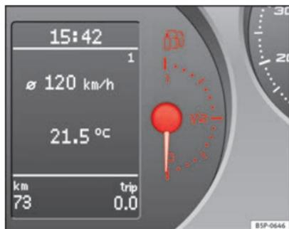
Fig. 35 Quadro strumenti: Indicatore del livello del GPL
