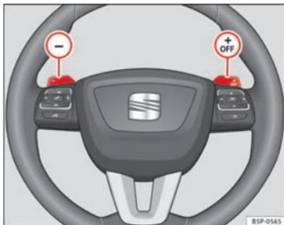
Fig. 128 Volante con leve per il cambio automatico
