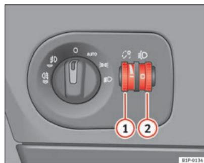
Fig. 73 Plancia porta-strumenti: regolatori dell'intensità di illuminazione degli strumenti e degli interruttori e regolatore assetto fari
