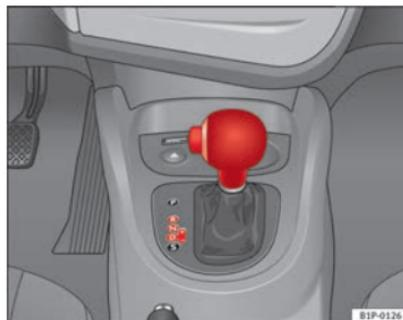
**Fig. 125** Disattivazione del bloccaggio della leva selettoria
