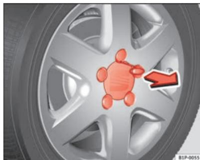
**Fig. 155** Cambio di una ruota: rimuovere il coprimozzo della ruota
