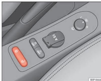
**Fig. 57** Dettaglio della console centrale: interruttore della chiusura centralizzata
