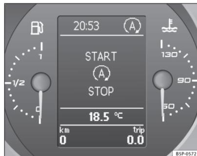
Fig. 120 Indicazione nel display del quadro strumenti durante la modalità Start-Stop.
