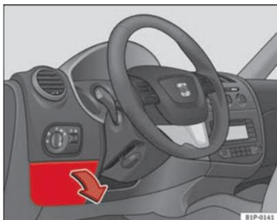
**Fig. 160** Lato sinistro della plancia portastrumenti: copertura della scatola dei fusibili
