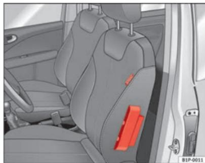
**Fig. 21** Airbag laterale all'interno del sedile del conducente
