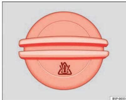
**Fig. 146 Vano motore: tappo del serbatoio di compensazione del liquido di raffreddamento**
