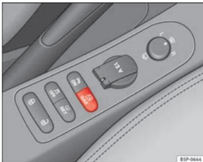
Fig. 118 Console centrale: tasto di commutazione dell'impianto a gas.
