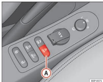
Fig. 119 Dettaglio del pulsante della modalità Start-Stop.
