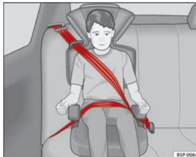
Fig. 29 Seggiolino rivolto nel senso di marcia, montato sul sedile posteriore
