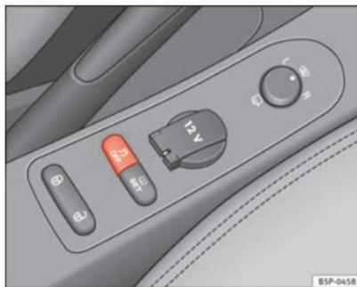
Fig. 116 Dettaglio della console centrale: tasto ESC (ESP)
