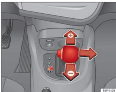
Fig. 127 Cambio del rapporto di marcia con Tiptronic
