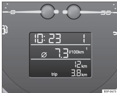
Fig. 42 Display digitale del quadro strumenti: Indicatore consumo medio di carburante
