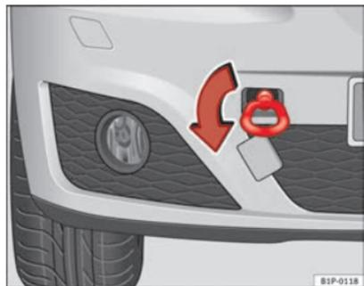
**Fig. 182** Lato anteriore destro del veicolo: montaggio dell'anello per traino anteriore
