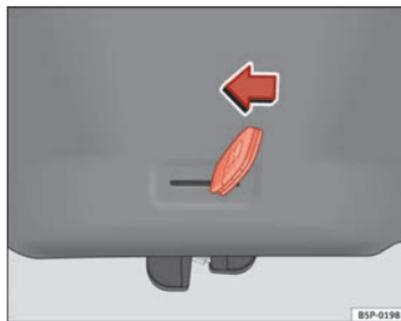
**Fig. 66** Portellone posteriore: apertura d'emergenza
