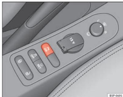
Fig. 130 Console centrale: Interruttore del sistema di assistenza per il parcheggio
