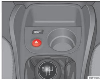
Fig. 75 Plancia portastrumenti: interruttore lampeggio di emergenza
