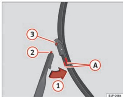
Fig. 148 Sostituzione delle spazzole dei tergicristalli
