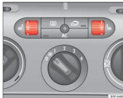
**Fig. 91** Rotelle zigrinate per il riscaldamento dei sedili anteriori
