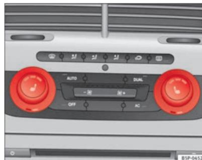
**Fig. 92** Riscaldamento sedili anteriori con Climatronic
