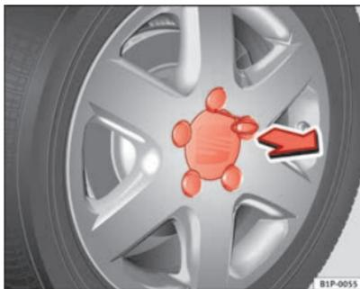
**Fig. 155** Cambio de rueda: Retirar el embellecedor de la rueda
