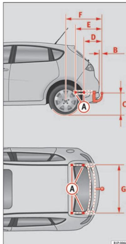
Fig. 137 Puntos de fijación del dispositivo de remolque
