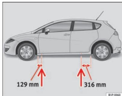
**Fig. 157 Puntos de apoyo del gato**
