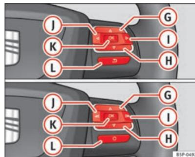
Fig. 52 Mandos en el volante (en función de la versión del modelo)
