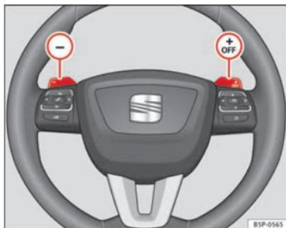
Fig. 128 Volante con palancas para cambio automático
