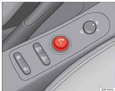
Fig. 99 Encendedor alojado en la toma de corriente de la consola central anterior
