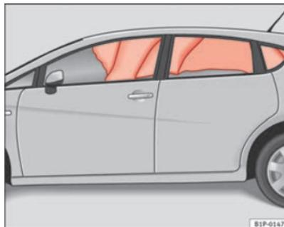
**Fig. 24** Airbags para la cabeza inflados
