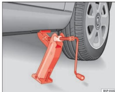
**Fig. 158 Colocación del gato**
