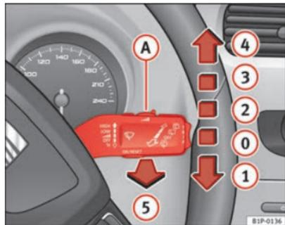
Fig. 81 Palanca del limpia-lavacristales
