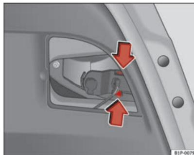
Fig. 172 Desmontaje del portalámparas
