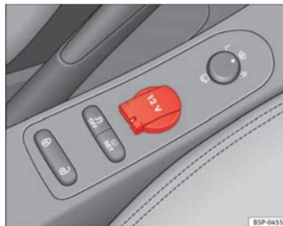
Fig. 100 Toma de corriente de 12 voltios de la consola central delantera
