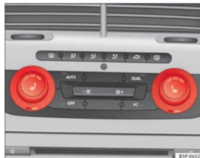
Fig. 92 Calefacción asientos delanteros con Climatronic
