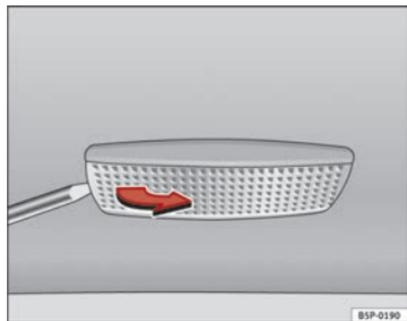
Fig. 178 Desmontaje luz del parasol
