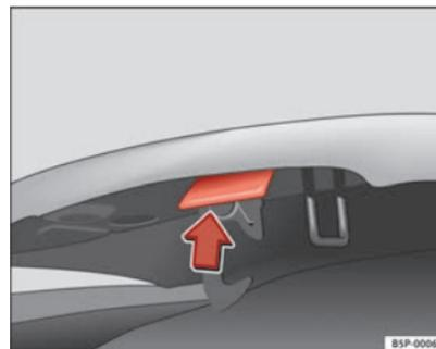
Fig. 143 Gancho apertura capó motor.
