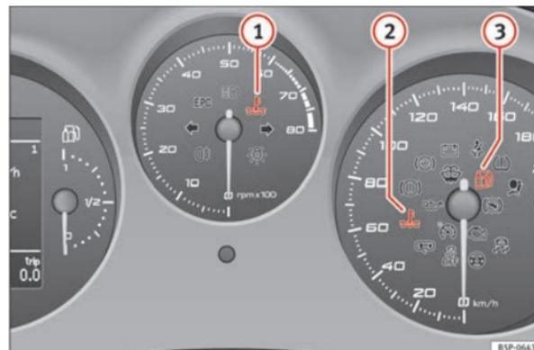
Fig. 49 Testigos de control y de advertencia del cuadro de instrumentos en vehículos con GLP.
