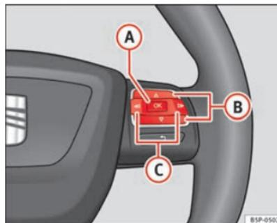
Fig. 44 Mandos en volante: tecla A para confirmar opciones del menú y teclas B para cambiar de menú
