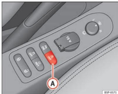
Fig. 119 Detalle del pulsador del funcionamiento Start-Stop.
