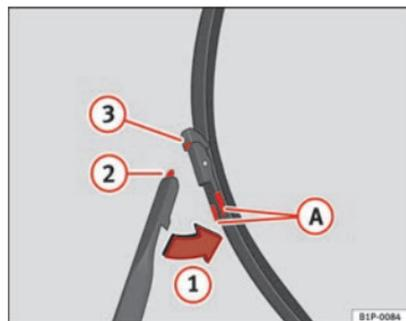
Fig. 148 Cambio de las escobillas del limpiaparabrisas
