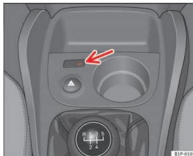
Fig. 26 Testigo de control de la desactivación del airbag del acompañante
