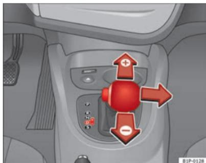
Fig. 127 Cambiar con tiptronic
