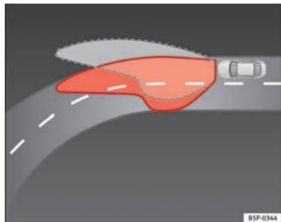
Fig. 74 Iluminación de la curva con faros autodireccionables
