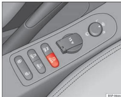
Fig. 118 Consola central: conmutador de control del sistema de gas.
