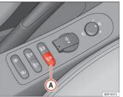
Fig. 119 The Start-Stop function button.
