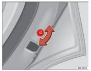
Fig. 60 Childproof lock on the right hand side door
