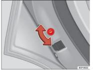
Fig. 59 Childproof lock on the left hand side door
