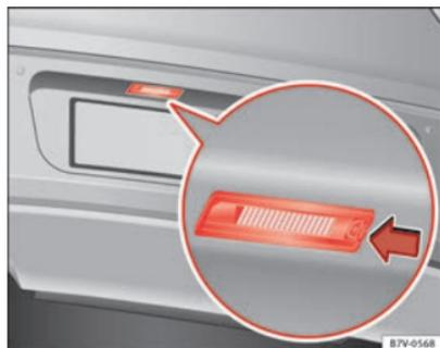
Fig. 157 Nel paraurti posteriore: luce targa
