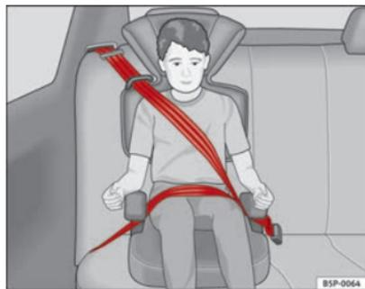
Fig. 32 Seggiolino rivolto nel senso di marcia, montato sul sedile posteriore
