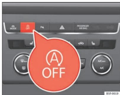
Fig. 92 Console centrale: tasto del sistema Start-Stop
