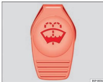
Fig. 70 Nel vano motore: tappo del serbatoio del lavacrystalli.
