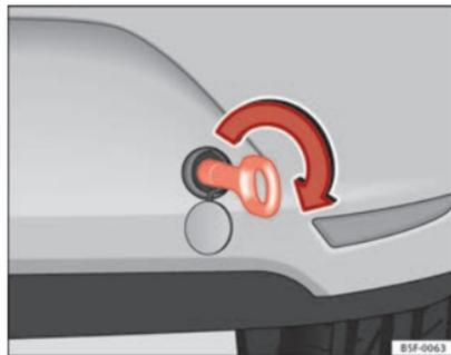
Fig. 135 Paraurti posteriore destro: Occhio di traino avvitato
