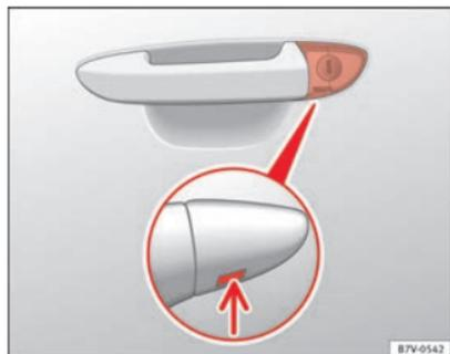
**Fig. 54** Maniglia della porta del conducente: Serratura di chiusura nascosta.
