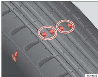
**Fig. 120** Spessore del battistrada dello pneumatico: indicatori di usura
