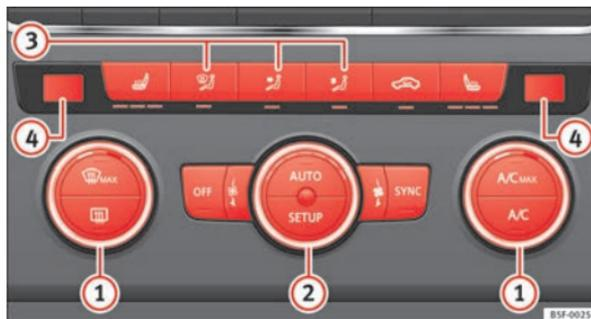
Fig. 85 Sulla console centrale: comandi del Climatronic.
