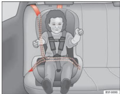
**Fig. 31** Seggiolino del gruppo 1 montato sul sedile posteriore; il bambino siede rivolto verso il senso di marcia
