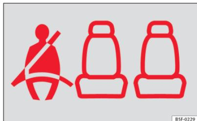
Fig. 7 Indicazione dello stato delle cinture dei posti posteriori sul quadro strumenti.
