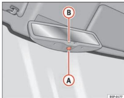
Fig. 72 Specchietto retrovisore interno fotocromatico\*
