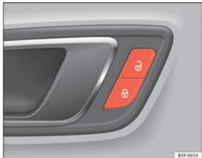
Fig. 52 Porta del conducente: interruttore della chiusura centralizzata
