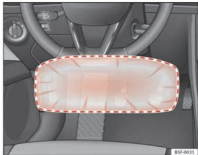
Fig. 24 Sul lato del conducente: Raggio d'azione degli airbag per le ginocchia.
