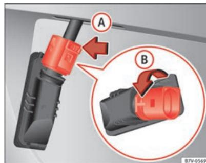
Fig. 158 Luce targa: smontaggio del supporto lampade
