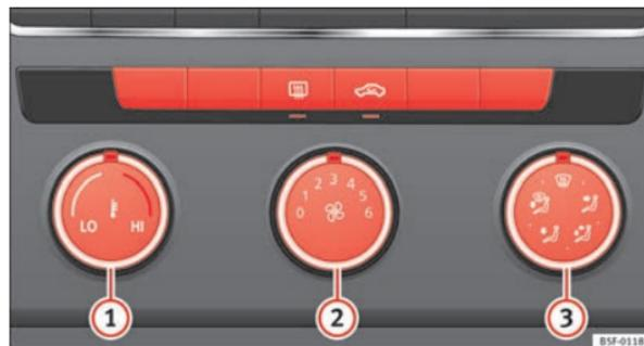
Fig. 87 Sulla consola centrale: comandi dell'impianto di riscaldamento e di ventilazione
