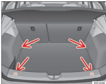
Fig. 84 Posizione degli occhielli di ancoraggio nel bagagliaio.
