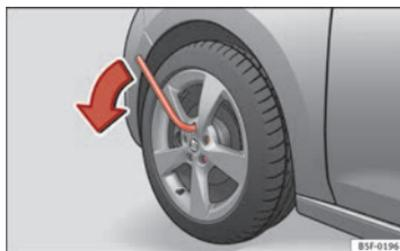
Fig. 127 Ruota: allentare le viti delle ruote
