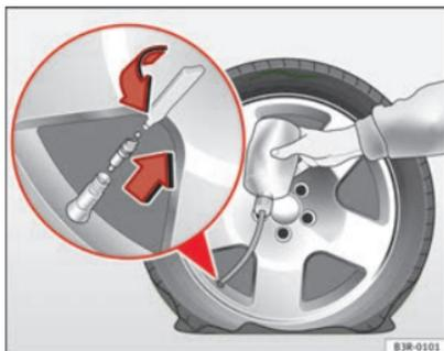
Fig. 123 Pneumatico: riempimento
