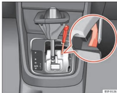
**Fig. 97** Leva selettoria: Sblocco di emergenza dalla posizione di parcheggio
