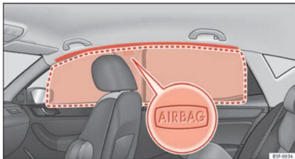
Fig. 27 Posizione degli airbag per la testa
