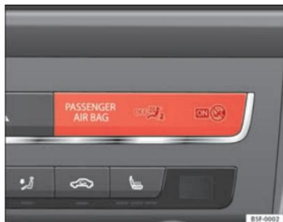
Fig. 18 Spia di controllo sul cruscotto per la disattivazione dell'airbag frontale del passeggero.
