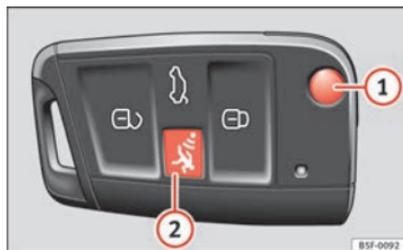
Fig. 46 Chiave del veicolo con pulsante di allarme.
