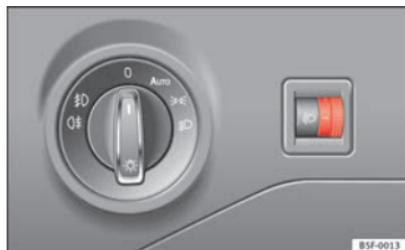
Fig. 64 Accanto al volante: regolatore della profondità delle luci.
