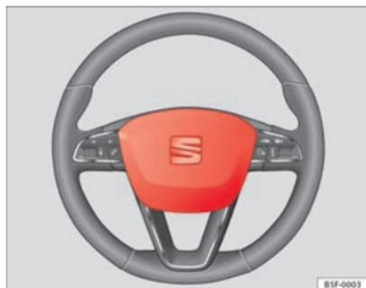
**Fig. 19** Airbag del conducente all'interno del volante
