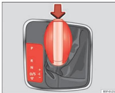
Fig. 94 Bloccaggio della leva selettoria
