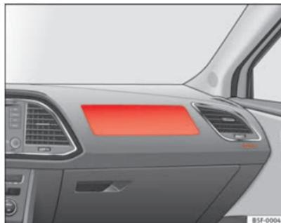
**Fig. 20** Airbag del passeggero anteriore sulla plancia portastrumenti
