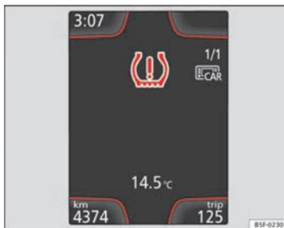
**Fig. 106** Quadro strumenti: avviso di calo di pressione degli pneumatici.
