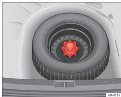
Fig. 130 Ruotino di scorta: piano di carico sollevato
