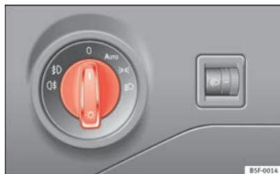
**Fig. 62** Plancia portastrumenti: Interruttore delle luci
