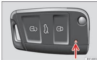
Fig. 47 Spia di controllo nella chiave del veicolo.
