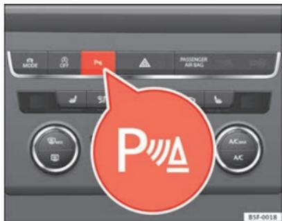
Fig. 109 Console centrale: tasto dell'assistenza per il parcheggio
