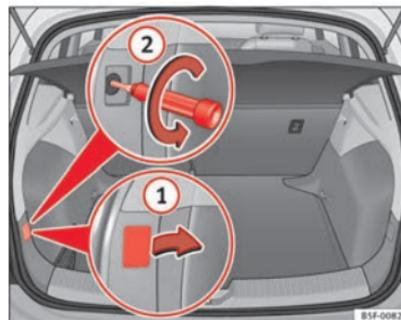
Fig. 151 Bagagliaio: posizione della vite di fissaggio del fanale di coda
