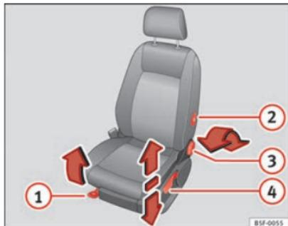
Fig. 73 Sedili anteriori: regolazione manuale del sedile
