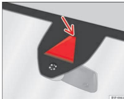
Fig. 103 Nel parabrezza: Area del campo visivo della telecamera del dispositivo di assistenza per il mantenimento della corsia.
