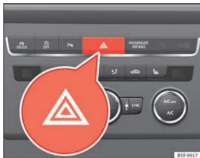
**Fig. 63** Plancia portastrumenti: interruttore lampeggio di emergenza
