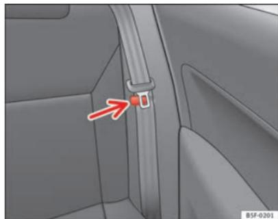
**Fig. 82** Morsetto per sostenere la cintura di sicurezza
