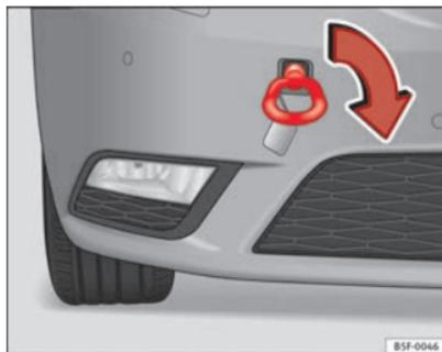
**Fig. 133 Paraurti anteriore destro: Occhiello di traino avvitato**
