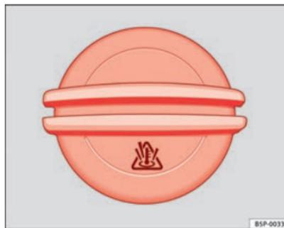
Fig. 115 Vano motore: Tappo del serbatoio di compensazione del liquido di raffreddamento
