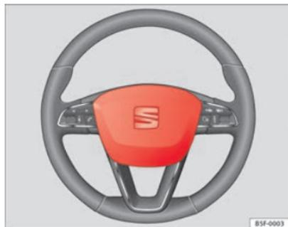
**Fig. 19** Airbag del conductor en el volante
