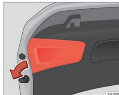
Fig. 154 Retirar la cubierta del portón del maletero
