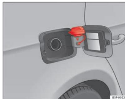
**Fig. 111** Tapa del depósito con el tapón encajado ▶
