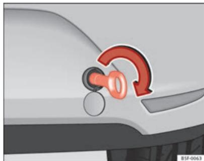
Fig. 135 Parte derecha del parachoques trasero: Argolla de remolque enroscada
