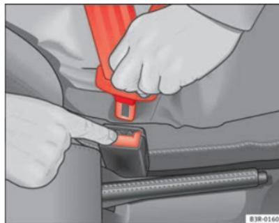
Fig. 17 Retirar la lengüeta del cierre del cinturón ▶
