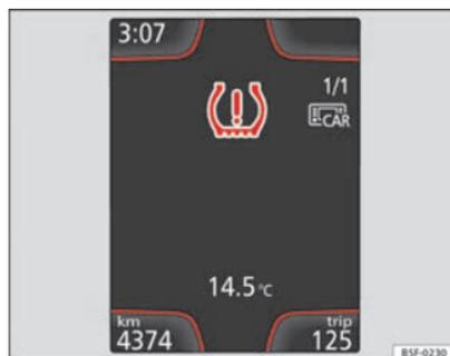
Fig. 106 Cuadro de instrumentos: aviso de pérdida de presión de los neumáticos
