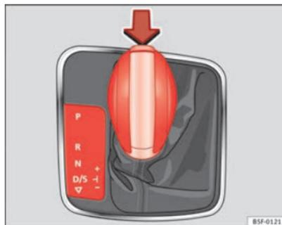
**Fig. 94 Bloqueo de la palanca selectora**
