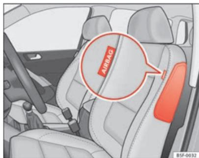
**Fig. 25 Airbag lateral en el asiento del conductor**
