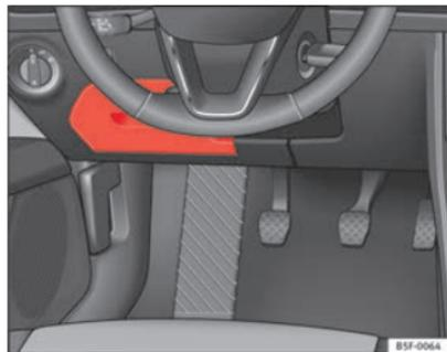
Fig. 136 En el tablero de instrumentos del lado del conductor: tapa de la caja de fusibles.
