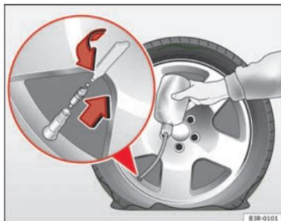
Fig. 123 Neumático: rellenar
