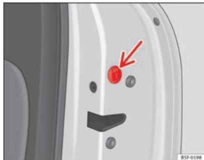
**Fig. 55 Bloqueo de emergencia de la puerta**
