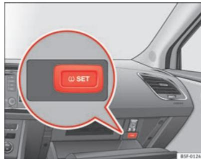
Fig. 107 Guantera: interruptor para el control de los neumáticos
