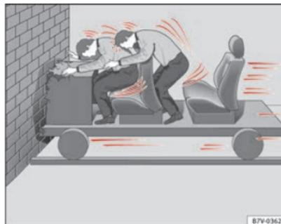
**Fig. 9** El vehículo choca con el muro: los ocupantes no llevan abrochado el cinturón
