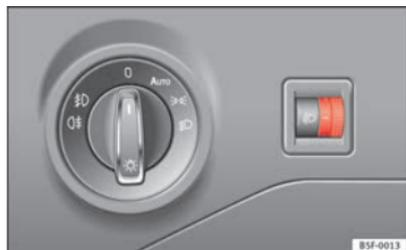
Fig. 64 Al lado del volante: regulador del alcance de las luces.
