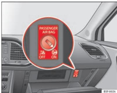
Fig. 28 Commutador del airbag frontal del acompañante
