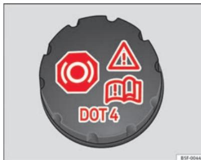
Fig. 116 Vano motor: tapón del depósito del líquido de frenos
