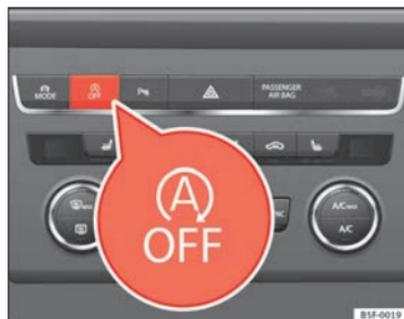
Fig. 92 Consola central: tecla del sistema Start-Stop
