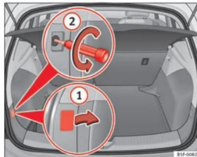
Fig. 151 Maletero: Posición del tornillo de fijación para la unidad de luz trasera
