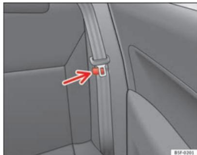
Fig. 82 Pinza para sujetar el cinturón de seguridad
