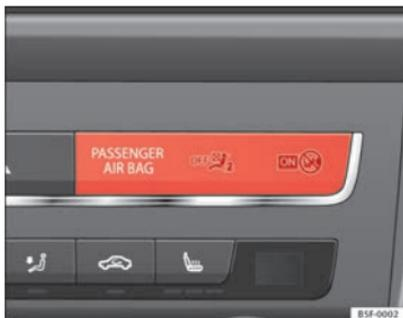
Fig. 29 Testigo para desconexión de airbag del acompañante
