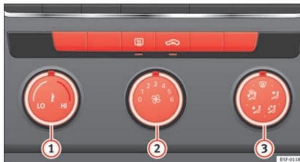
Fig. 87 En la consola central: mandos del sistema de calefacción y aire fresco
