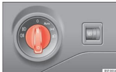
Fig. 62 Tablero de instrumentos: Mando de las luces
