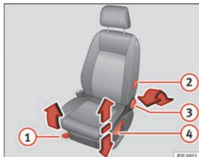
Fig. 73 Asientos delanteros: ajuste manual del asiento
