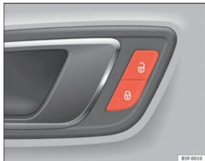
Fig. 52 Puerta del conductor: conmutador del cierre centralizado
