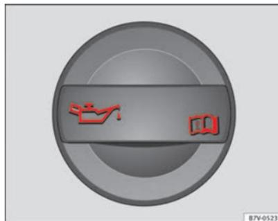
**Fig. 114** Tapón de la boca de llenado de aceite del motor en el vano motor
