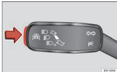
Fig. 44 En la palanca de intermitentes y de luz de carretera: tecla para los sistemas de asistencia al conductor.
