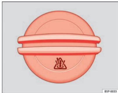
Fig. 115 Vano motor: tapón del depósito de expansión del líquido refrigerante
