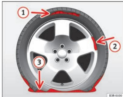
Fig. 122 Neumático: daños irreparables
