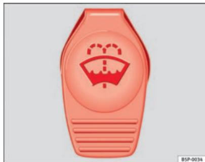
Fig. 117 Vano motor: Tapón del depósito del lavacrystal
