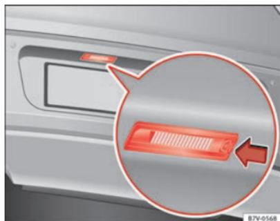
Fig. 157 En el parachoques posterior: luz de matrícula
