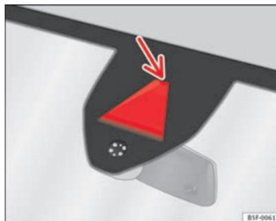
Fig. 103 En el parabrisas: Área de campo visual del sistema de aviso de salida del carril.
