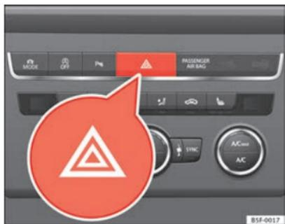
**Fig. 63** Tablero de instrumentos: conmutador de los intermitentes de emergencia
