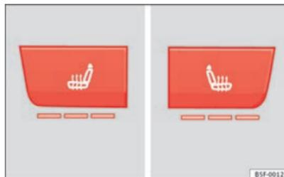
Fig. 74 En la consola central: mandos para la calefacción de los asientos delanteros.
