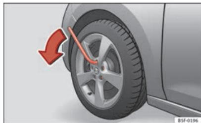
Fig. 127 Rueda: aflojar los tornillos de rueda
