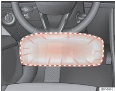
Fig. 24 En el lado del conductor: Radio de acción del airbag para las rodillas.
