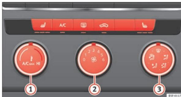
Fig. 86 En la consola central: mandos del aire acondicionado manual.
