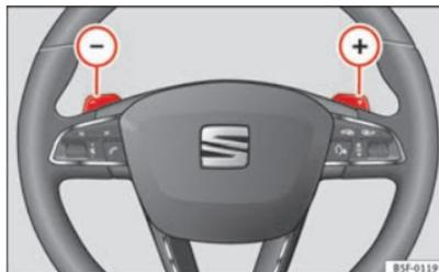
Fig. 96 Volante: palancas para cambio automático
