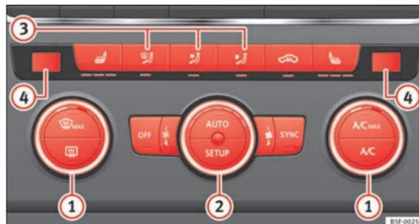
Fig. 85 En la consola central: mandos del Climatronic.
