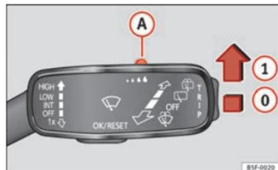
Fig. 68 Palanca del limpiaparabrisas: ajustar el sensor de lluvia (A).
