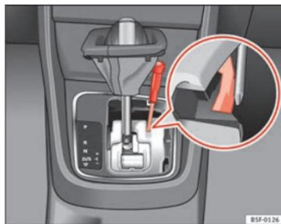
**Fig. 97 Palanca selectora: Desbloqueo de emergencia en la posición de aparcamiento**
