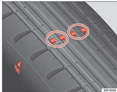
Fig. 120 Perfil del neumático: indicadores de desgaste
