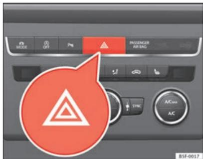
**Fig. 66** Plancia portastrumenti: interruttore lampeggio di emergenza
