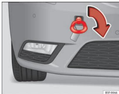
**Fig. 174** Paraurti anteriore destro: Occhiello di traino avvitato
