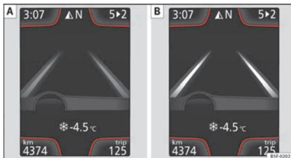
Fig. 141 Sul display del quadro strumenti: Indicazione sul display del dispositivo di assistenza per il mantenimento della corsia (esempio 1).
