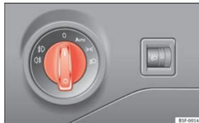
Fig. 65 Plancia portastrumenti: Interruttore delle luci
