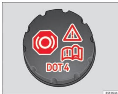
Fig. 157 Vano motore: tappo del serbatoio del liquido dei freni
