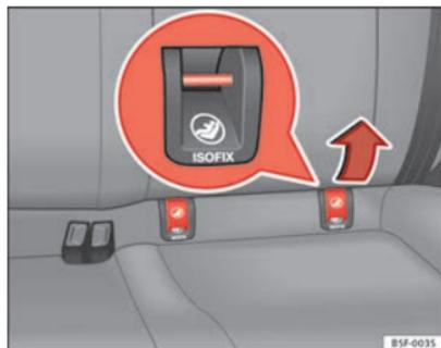
Fig. 34 Occhielli di fissaggio del sistema ISOFIX
