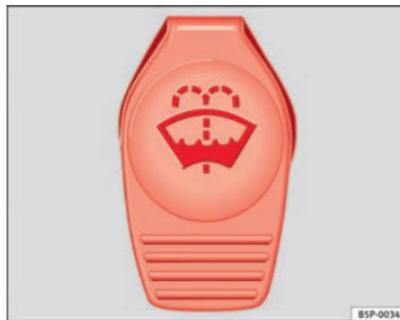
Fig. 74 Nel vano motore: tappo del serbatoio dei tergicristalli.
