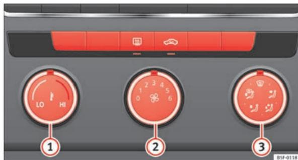
Fig. 115 Sulla consola centrale: comandi dell'impianto di riscaldamento e di ventilazione
