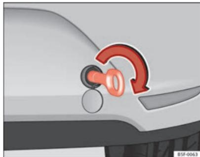
Fig. 176 Paraurti posteriore destro: Occhio di traino avvitato
