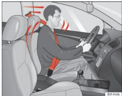
**Fig. 12** Conducente con la cintura di sicurezza allacciata correttamente: durante una frenata brusca viene trattenuto dalla cintura di sicurezza
