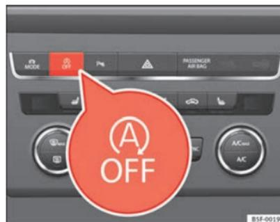
Fig. 120 Console centrale: tasto del sistema Start-Stop
