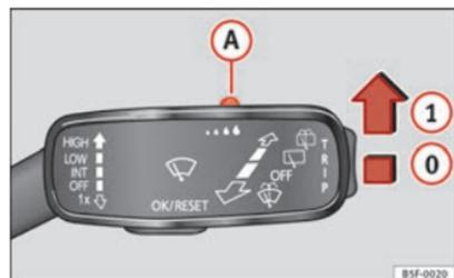
**Fig. 72** Leva dell'impianto tergicristalli **Regolazione del sensore pioggia** Ⓐ.
