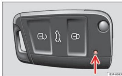
Fig. 47 Spia di controllo nella chiave del veicolo.
