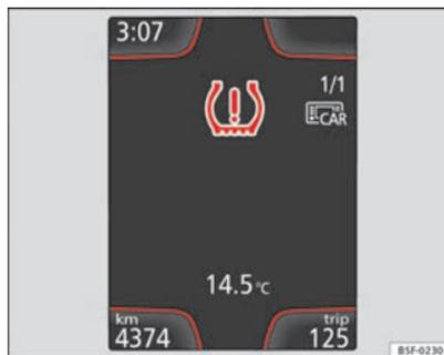
Fig. 146 Quadro strumenti: avviso di calo di pressione degli pneumatici.
