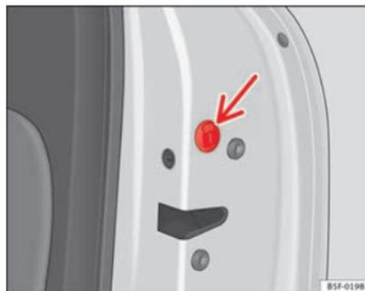
**Fig. 56** Bloccaggio di emergenza della porta ►
