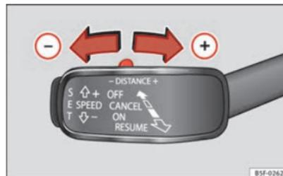
Fig. 135 Leva di comando: Selezione della distanza
