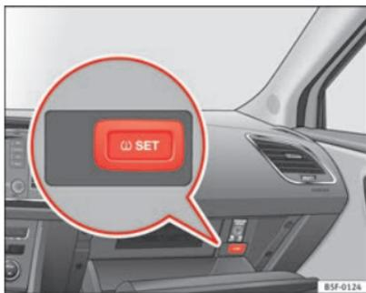
Fig. 147 Cassetto portaoggetti: interruttore per il controllo degli pneumatici
