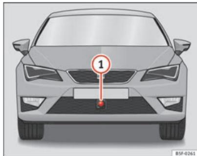
Fig. 139 Sul paraurti anteriore: sensore radar.
