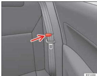
**Fig. 89** Morsetto per sostenere la cintura di sicurezza
