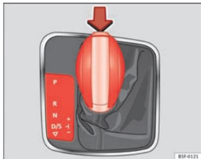
Fig. 122 Bloccaggio della leva selettoria
