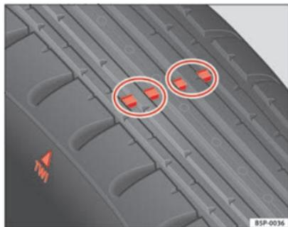
**Fig. 161** Spessore del battistrada dello pneumatico: indicatori di usura
