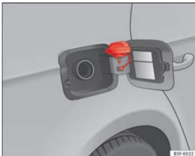
Fig. 151 Sportellino del serbatoio con all'interno il tappo
