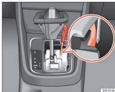
**Fig. 125** Leva selettoria: Sblocco di emergenza dalla posizione di parcheggio
