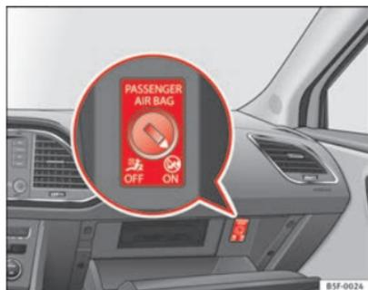
Fig. 28 Commutatore dell'airbag frontale del passeggero anteriore
