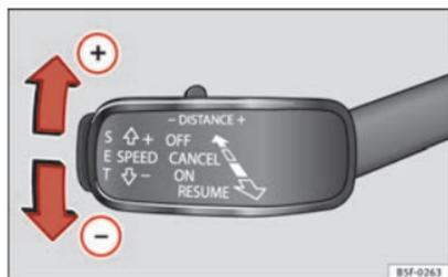
Fig. 133 A sinistra del piantone dello sterzo: Terza leva per la gestione dell'adaptive cruise control.
