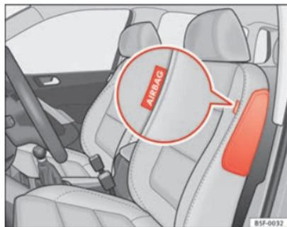
**Fig. 25 Airbag laterale all'interno del sedile del conducente**
