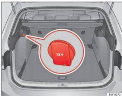
Fig. 88 Particolare del rivestimento laterale del bagagliaio: Presa di corrente da 12 volt (valido solo per il modello LEON ST)
