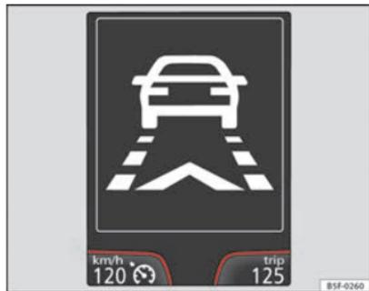
Fig. 140 Sul display del quadro strumenti: indicazione di preavviso.
