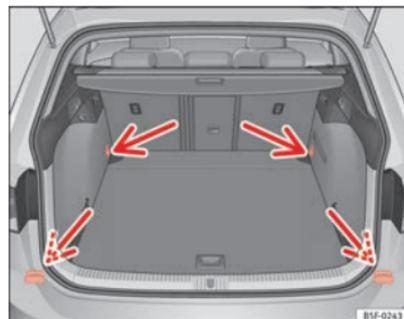
**Fig. 105** Nel bagagliaio: occhielli di ancoraggio (modello LEON ST).
