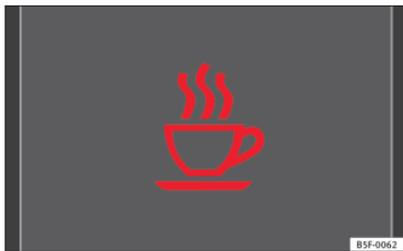
Fig. 145 Sul display del quadro strumenti: Simbolo del riconoscimento della stanchezza del guidatore.
