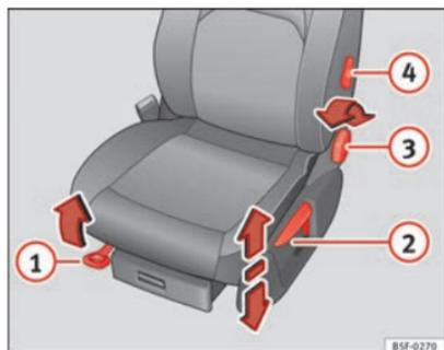
Fig. 77 Sedili anteriori: regolazione manuale del sedile
