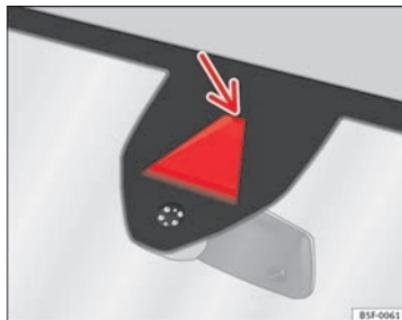
**Fig. 143** Nel parabrezza: Area del campo visivo della telecamera del dispositivo di assistenza per il mantenimento della corsia.
