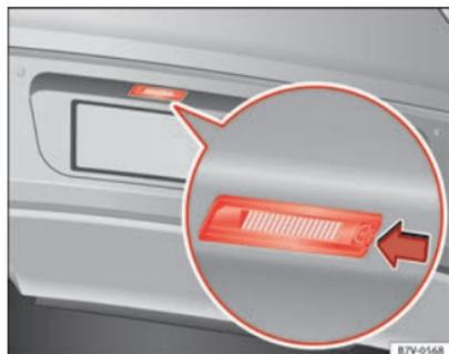
Fig. 198 Nel paraurti posteriore: luce targa
