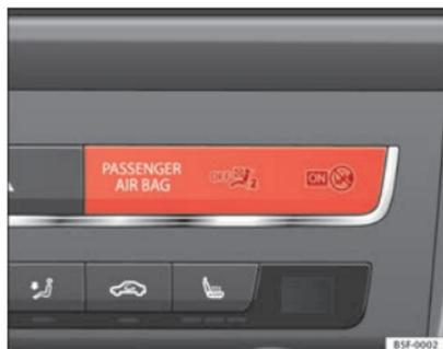
Fig. 29 Spia per la disattivazione dell'airbag del passeggero
