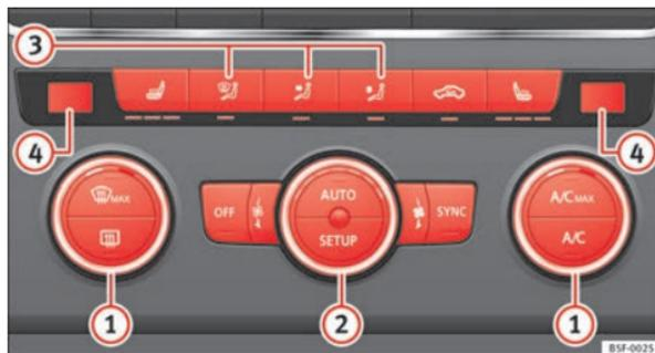
Fig. 113 Sulla console centrale: comandi del Climatronic.
