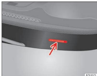
Fig. 201 Numero di identificazione della vettura.
