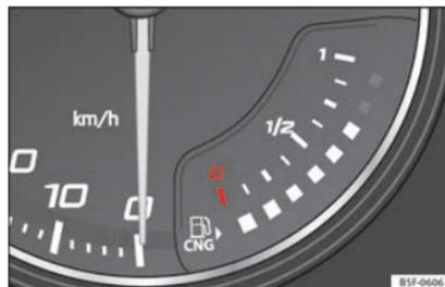
Fig. 122 Indicateur de carburant.
