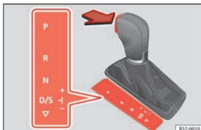
Fig. 53 Boîte automatique : positions du levier sélecteur.
