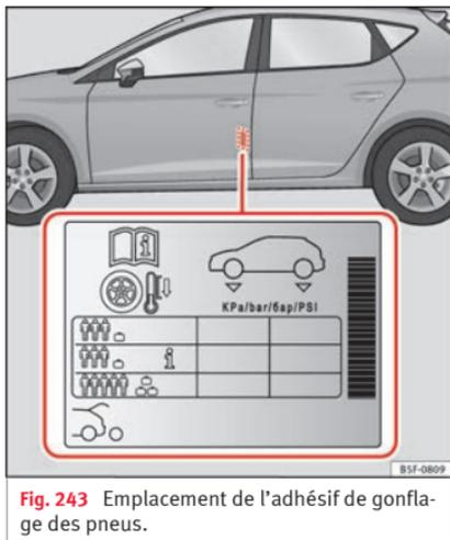
Fig. 243 Emplacement de l'adhésif de gonflage des pneus.
