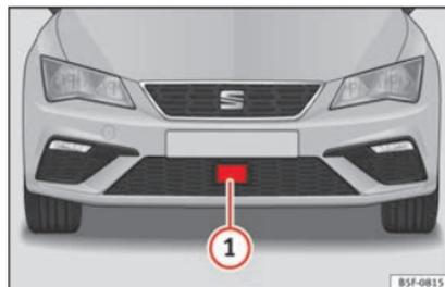
Fig. 208 Au niveau du pare-chocs avant : capteur radar.
