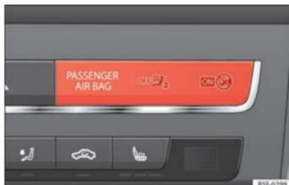
Fig. 95 Témoin de désactivation de l'airbag du passager.
