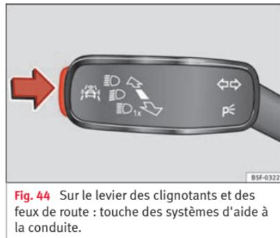
**Fig. 44** Sur le levier des clignotants et des feux de route : touche des systèmes d'aide à la conduite.
