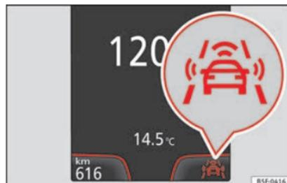
**Fig. 209** Sur l'écran du combiné d'instruments : indication de Front Assist désactivé.
