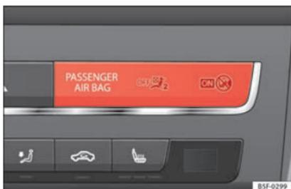
**Fig. 51** Témoin de désactivation de l'airbag du passager.
