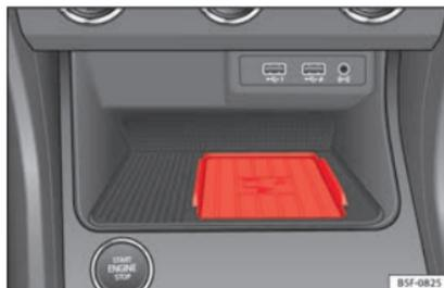
**Fig. 127** Console centrale : Connectivity Box
