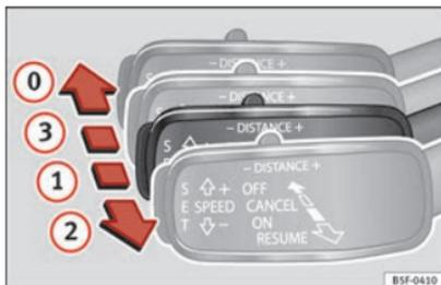
**Fig. 202** À gauche de la colonne de direction : troisième levier pour utiliser la régulation de vitesse adaptatif.
