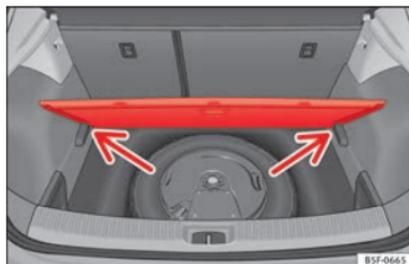
**Fig. 180** Coffre à bagages : plancher modulable
