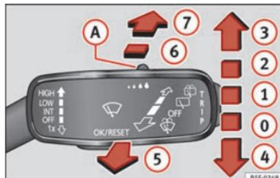
**Fig. 39** Utilisation de l'essuie-glace avant et arrière.
