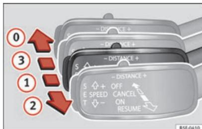
**Fig. 200** À gauche de la colonne de direction : troisième levier pour utiliser le régulateur de vitesse adaptatif.
