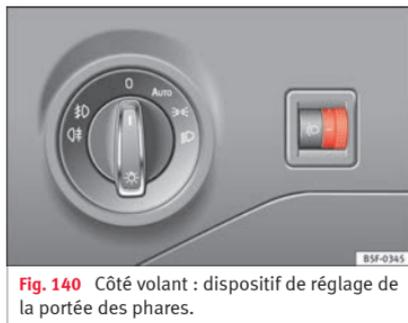
**Fig. 140** Côté volant : dispositif de réglage de la portée des phares.
