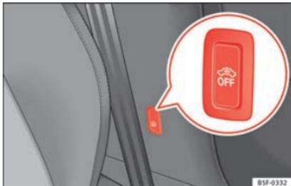
**Fig. 135** Touche de protection volumétrique/de protection anti-soulèvement.
