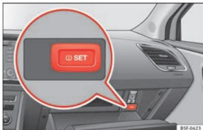
**Fig. 247** Boîte à gants : interrupteur de contrôle de la pression des pneus.
