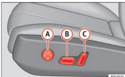
Fig. 14 Siège du conducteur : réglage électrique du siège.
