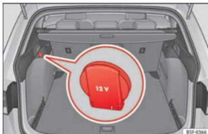
Fig. 158 Détail du revêtement latéral du coffre à bagages : prise de courant de 12 volts (valable uniquement sur le modèle LEON ST).
