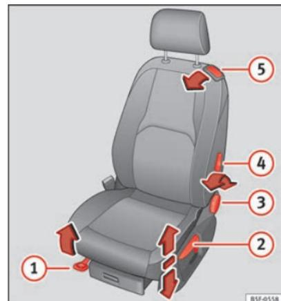
**Fig. 13** Sièges avant : réglage manuel du siège.
