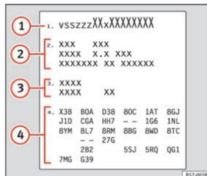
Fig. 250 Plaquette d'identification du véhicule (coffre à bagages).
