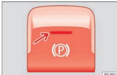
**Fig. 188** Sur la partie inférieure de la console centrale : touche du frein de stationnement électronique.
