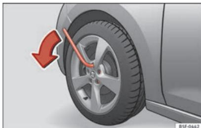
**Fig. 72** Roue : desserrer les vis de roue.
