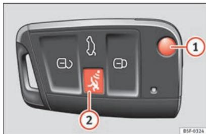
Fig. 129 Clé du véhicule avec bouton d'alarme.
