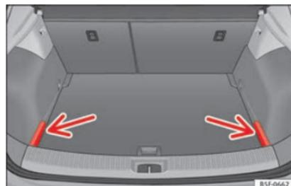
**Fig. 163** Dans le coffre à bagages : caches pour ranger la plage arrière.
