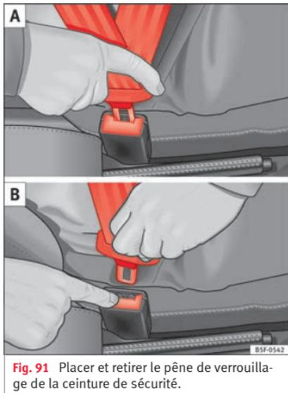
**Fig. 91** Placer et retirer le pêne de verrouillage de la ceinture de sécurité.
