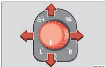
Fig. 145 Porte du conducteur : commande du rétroviseur extérieur.
