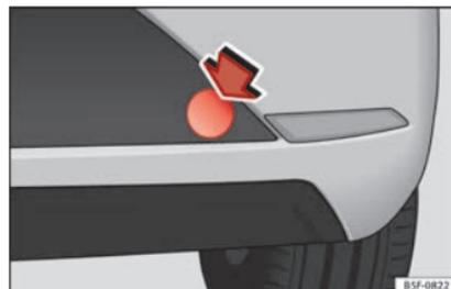
**Fig. 98** Pare-chocs arrière droit : capuchon de protection
