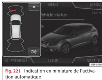
**Fig. 221** Indication en miniature de l'activation automatique
