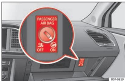
Fig. 94 Commande de l'airbag frontal du passager.
