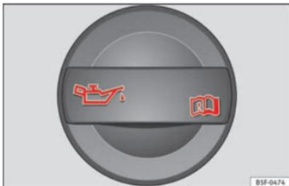
**Fig. 242** Dans le compartiment-moteur : bouchon de l'orifice de remplissage d'huile moteur.
