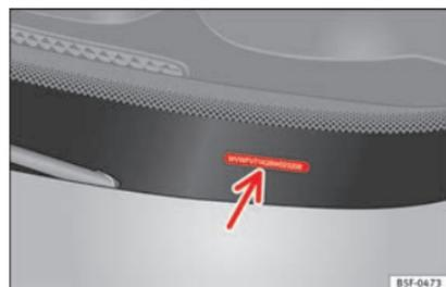
Fig. 251 Numéro de châssis.
