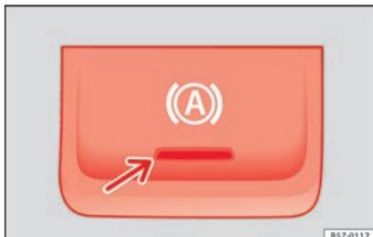
**Fig. 195** Sur la partie inférieure de la console centrale : bouton de fonction Auto Hold.
