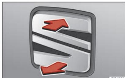
Fig. 5 Hayon : ouverture de l'extérieur.
