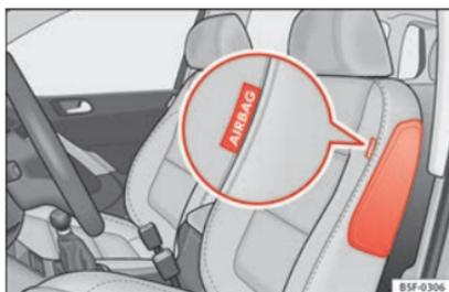
**Fig. 25** Airbag latéral dans le siège du conducteur.
