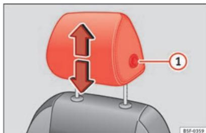
Fig. 15 Siège avant : réglage de l'appuie-tête.
