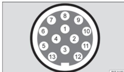
**Fig. 236** Représentation schématique : attribution des broches de la prise de courant de la remorque.
