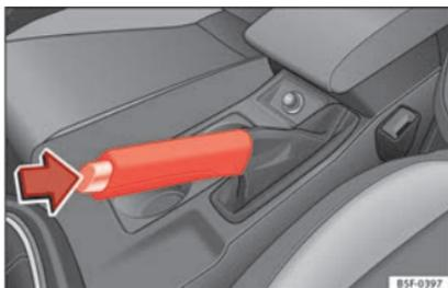
Fig. 189 Frein à main entre les sièges avant.
