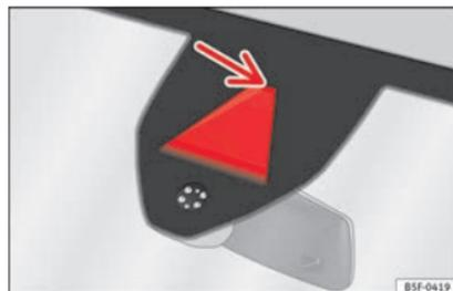
**Fig. 214** Sur le pare-brise : fenêtre de l'assistant de maintien de voie.
