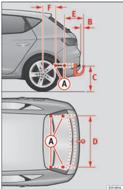
**Fig. 238** Points de fixation du dispositif de remorquage.
