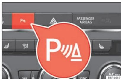
**Fig. 220** Console centrale : touche de l'aide au stationnement.
