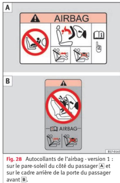
**Fig. 28** Autocollants de l'airbag - version 1 : sur le pare-soleil du côté du passager **A** et sur le cadre arrière de la porte du passager avant **B**.
