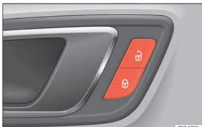
Fig. 2 Porte du conducteur : commande de verrouillage centralisé.
