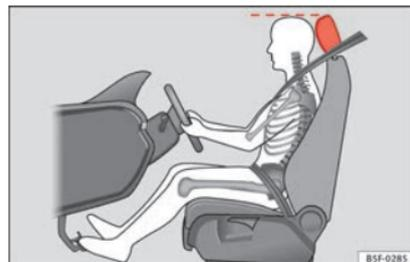
**Fig. 83** Position correcte de l'appuie-tête du conducteur
