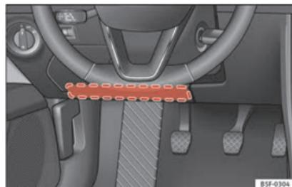
**Fig. 23** Côté conducteur : emplacement de l'airbag de genoux.
