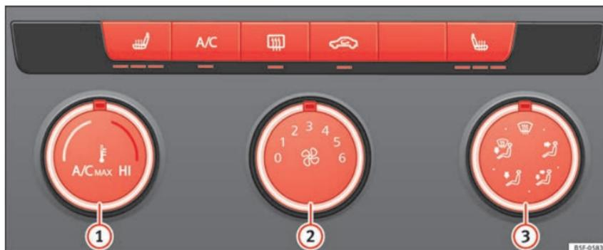
Fig. 56 Dans la console centrale : commandes du climatiseur manuel.
