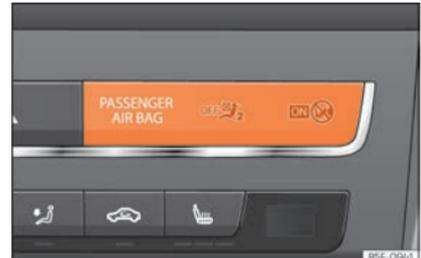
**Abb. 29** Instrumententafel: Kontrollleuchte für abgeschalteten Beifahrerairbag.
