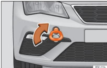
**Abb. 101** Vorderer Stoßfänger rechts: Eingeschraubte Abschleppöse
