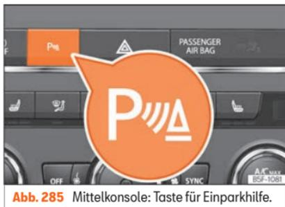
Abb. 285 Mittelkonsole: Taste für Einparkhilfe.
