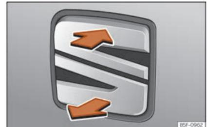
**Abb. 8** Heckklappe: Öffnen von außen
