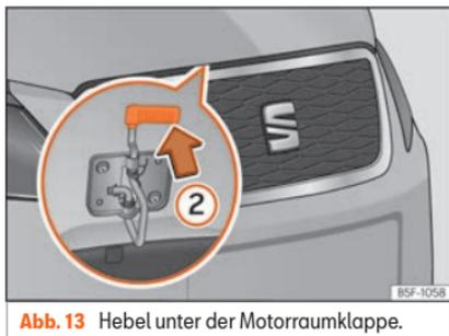
Abb. 13 Hebel unter der Motorraumklappe.
