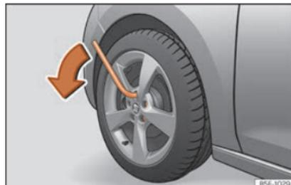
**Abb. 77** Rad: Radschrauben lockern.
