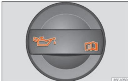
**Abb. 311** Deckel der Motoröl-Einfüllöffnung im Motorraum
