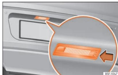
**Abb. 121** Im Stoßfänger hinten: Kennzeichenbeleuchtung.
