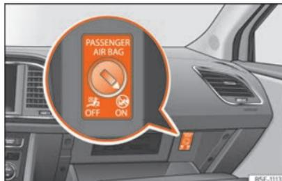
**Abb. 28** Schalter für Beifahrer-Frontairbag.
