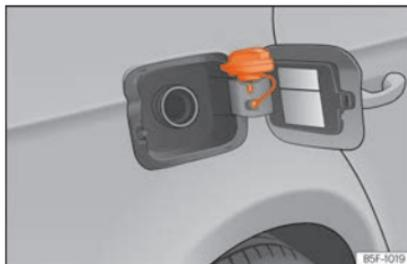
**Abb. 61** Tankklappe mit aufgestecktem Tankverschluss.
