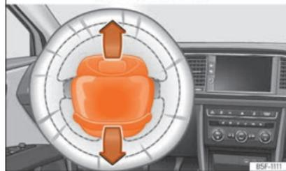
**Abb. 26** Einbauort Fahrerairbag: im Lenkrad.
