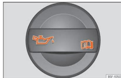
**Abb. 63** Deckel der Motoröl-Einfüllöffnung im Motorraum
