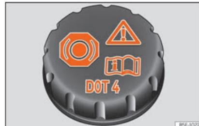
**Abb. 65** Motorraum: Deckel des Bremsflüssigkeitsbehälters
