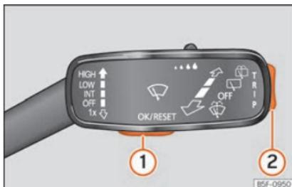
**Abb. 136** Scheibenwischerhebel: Steuertasten.
