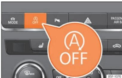
**Abb. 262** Mittelkonsole: Systemtaste Start-Stopp.
