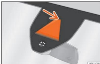
Abb. 277 Kamerasichtfenster des Spurhalteassistenten.
