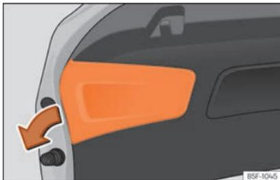
**Abb. 119** Abdeckung der Heckklappe entfernen
