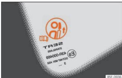
Abb. 91 Warnschild für Kopfstützenstellung
