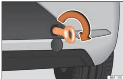
**Abb. 81** Hinterer Stoßfänger rechts: Eingeschraubte Abschleppöse
