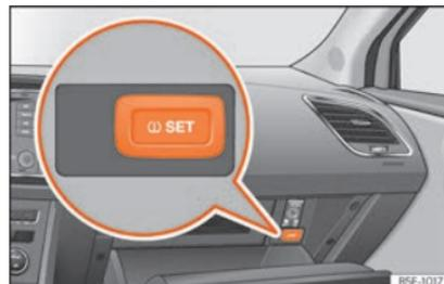
Abb. 316 Handschuhfach: Schalter Reifenkontrollanzeige.
