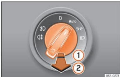
**Abb. 151** Instrumententafel: Bedienelement Licht
