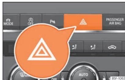
**Abb. 152** Instrumententafel: Schalter für die Warnblinkanlage
