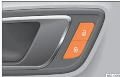
Abb. 5 Fahrertür: Taste Zentralverriegelung.
