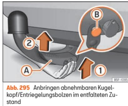
Abb. 295 Anbringen abnehmbaren Kugelkopf/Entriegelungsbolzen im entfalteten Zustand
