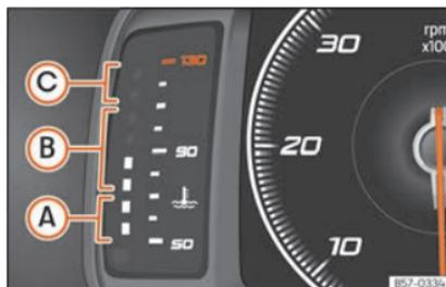
Abb. 135 Frei konfigurierbares Kombiinstrument: Motor Kühlmitteltemperatur-Anzeige.
