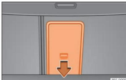
**Abb. 184** Im Gepäckraum: Öffnung der Durchladeeinrichtung.
