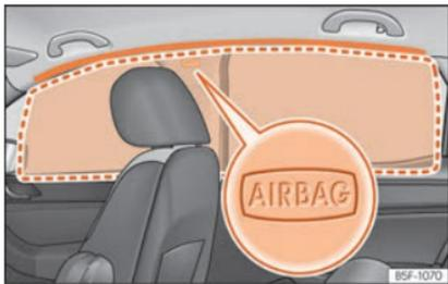
**Abb. 34** Einbauort der Kopfairbags
