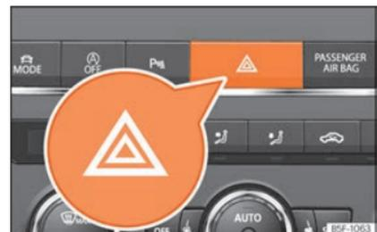
**Abb. 47** Instrumententafel: Schalter für die Warnblinkanlage
