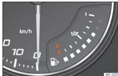
**Abb. 131** Analoges Kombiinstrument: Kraftstoffvorratsanzeige
