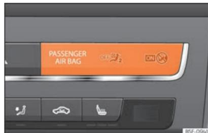
**Abb. 99** Instrumententafel: Kontrollleuchte für abgeschalteten Beifahrerairbag.
