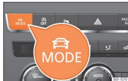
Abb. 281 Mittelkonsole: MODE-Taste
