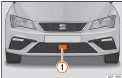
**Abb. 266** Im vorderen Stoßfänger: Radarsensor.
