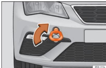
**Abb. 80** Vorderer Stoßfänger rechts: Eingeschraubte Abschleppöse
