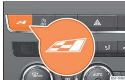
**Abb. 282** Mittelkonsole: Taste Cupra Drive Profile
