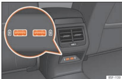
**Abb. 248** Mittelkonsole hinten: USB-Anschlüsse.
