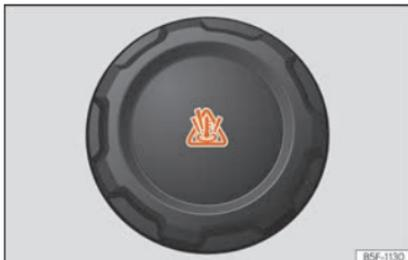
**Abb. 64** Motorraum: Deckel des Motorkühlmittel­ausgleichsbehälters
