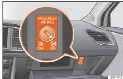
**Abb. 98** Schüsselschalter zum Ein- und Abschalten des Beifahrerairbags.
