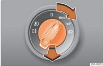
**Abb. 45** Instrumententafel: Bedienelement Licht
