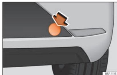
**Abb. 102** Hinterer Stoßfänger rechts: Abdeckkappe-Deckel.
