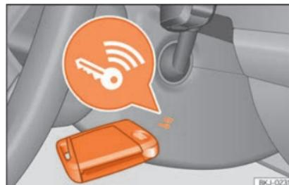
Abb. 253 Rechts an der Lenksäule: Notstart.
