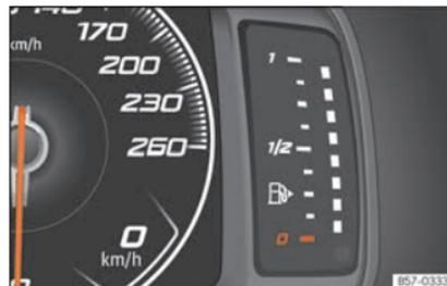
**Abb. 132** Frei konfigurierbares Kombiinstrument: Kraftstoffvorratsanzeige.
