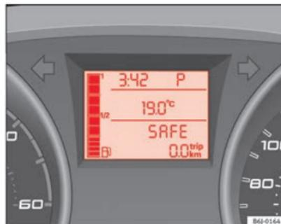
Fig. 113 Caixa de velocidades automática: visor do painel de instrumentos
