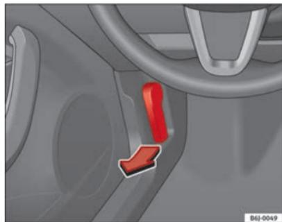
Fig. 130 Manípulo de abertura do capot do motor
