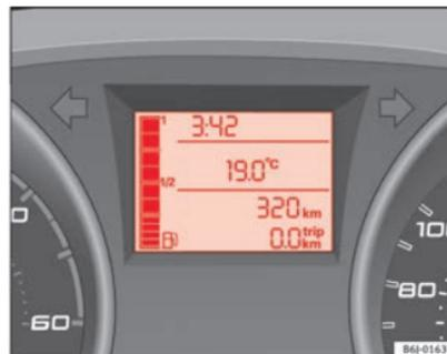
Fig. 32 Indicador do nível do depósito de combustível
