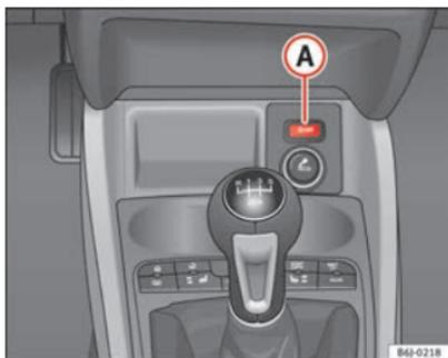
Fig. 108 Pormenor do botão do funcionamento Start-Stop.
