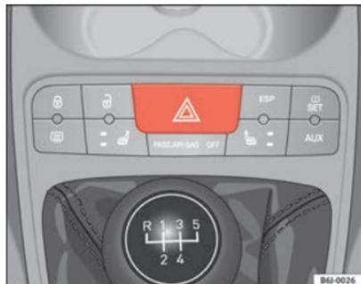
Fig. 59 Consola central: comutador das luzes de emergência
