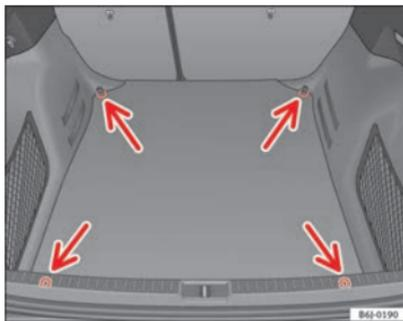
Fig. 93 Disposição das argolas de fixação no porta-bagagens
