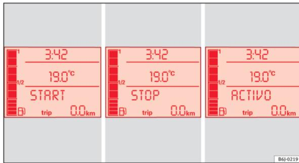
Fig. 109 Indicação no visor do painel de instrumentos durante o funcionamento Start-Stop.
