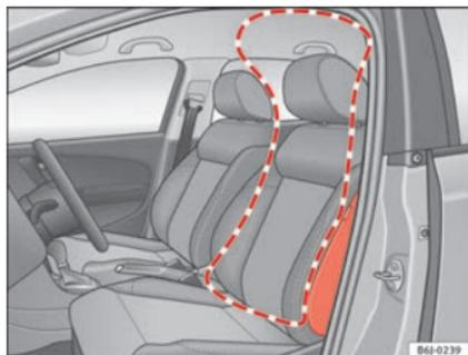
**Fig. 20 Airbag lateral no banco do condutor**
