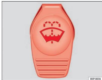
Fig. 135 Tampão do reservatório do limpa-vidros no compartimento do motor.
