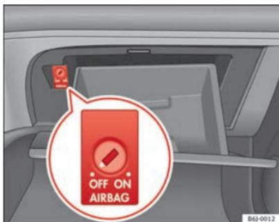
Fig. 21 No porta-luvas: comutador com chave para activar e desactivar o airbag do passageiro
