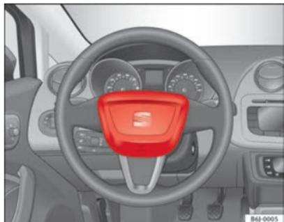
**Fig. 16 Airbag do condutor no volante**
