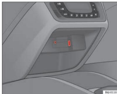
Fig. 89 Ligação entrada AUX /USB\* (em função do equipamento)
