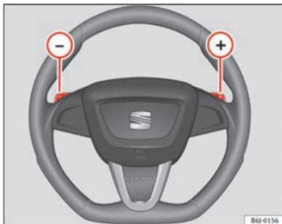
Fig. 116 Volante com patilhas para a caixa de velocidades automática
