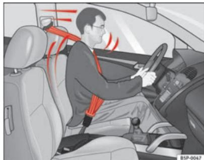
**Fig. 10** Condutor com o cinto de segurança correctamente colocado: é retido pelo mesmo em caso de travagem brusca
