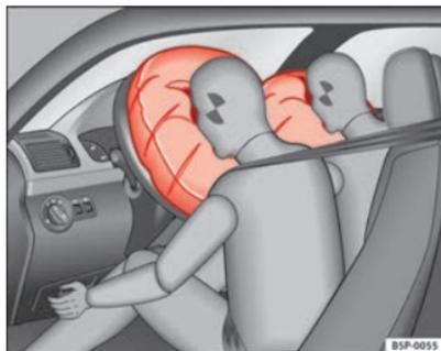
**Fig. 18 Airbags frontais inflados**
