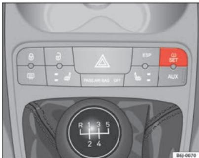
Fig. 40 Consola central: botão do sistema de controlo dos pneus
