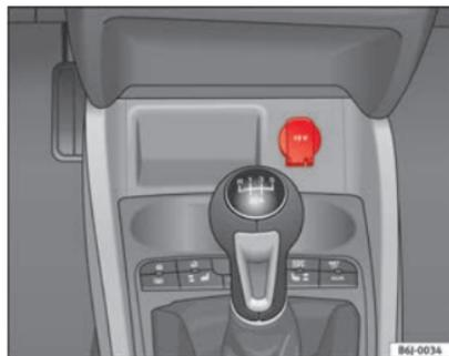
Fig. 86 Tomada de corrente dianteira
