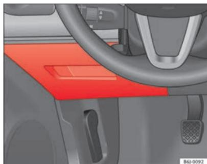
Fig. 146 Fusíveis no painel de instrumentos
