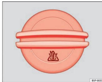
**Fig. 134** Tampão do reservatório de expansão do líquido de refrigeração no compartimento do motor
