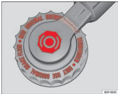
Fig. 138 Tampão do reservatório do líquido dos travões no compartimento do motor
