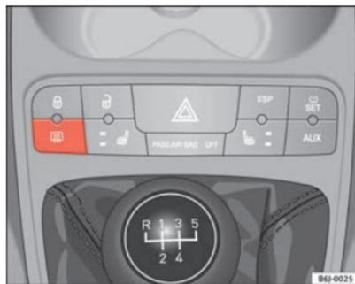
Fig. 58 Consola central: comutador do desembaciador do vidro traseiro
