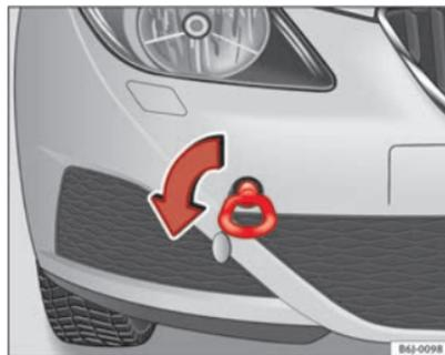
Fig. 170 Enroscamento da argola de reboque na parte dianteira do veículo
