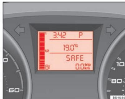
Fig. 36 Visor digital: Posição da alavanca da caixa de velocidades automática
