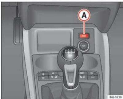
Fig. 107 Consola central: comutador de controlo do sistema de gás.
