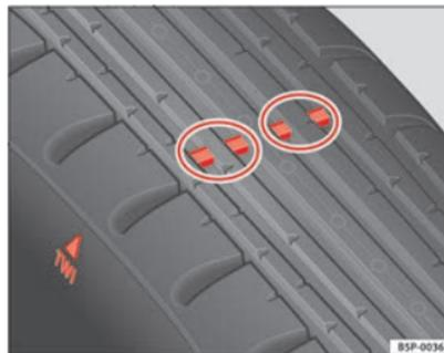
Fig. 139 Indicadores de desgaste no perfil do pneu
