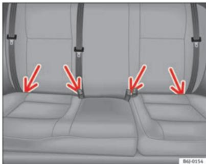
Fig. 26 Anéis de fixação ISOFIX
