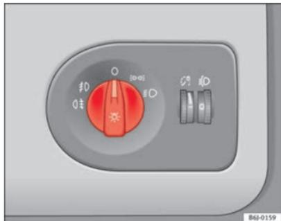
Fig. 54 Pormenor do painel de instrumentos: comando das luzes, faróis de nevoeiro e luz de nevoeiro traseira
