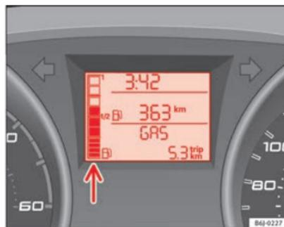
Fig. 31 Painel de instrumentos: indicador do nível de gás.
