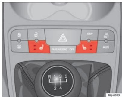
**Fig. 73** Comutador do aquecimento dos bancos dianteiros
