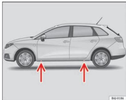
**Fig. 143** Puntos de apoyo del gato
