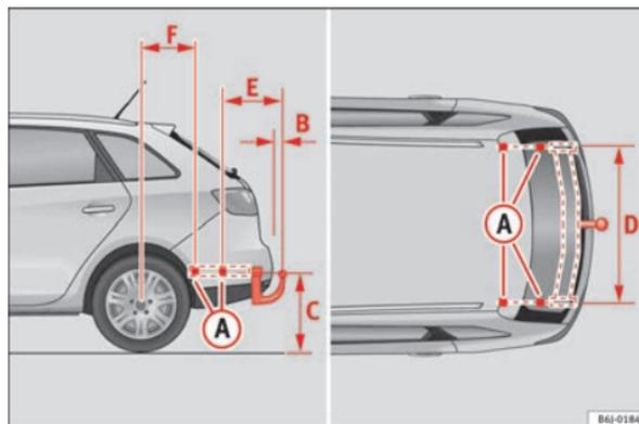
Fig. 125 Puntos de fijación del dispositivo de remolque
