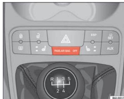
Fig. 22 Testigo de control de la desactivación del airbag del acompañante
