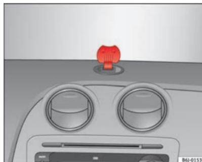
Fig. 79 Soporte con tapa abierta para colocación del navegador.
