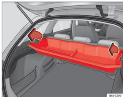
Fig. 96 Desmontaje cajón portaobjetos
