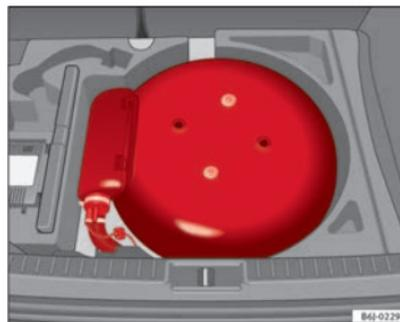
Fig. 128 Depósito de GLP en la cavidad de la rueda de repuesto.
