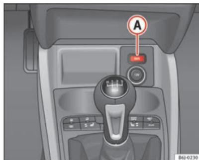
Fig. 107 Consola central: conmutador de control del sistema de gas.
