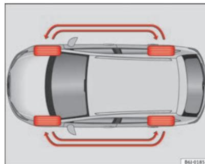
Fig. 140 Esquema para el cambio de ruedas
