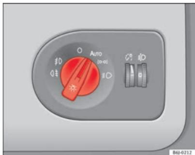
Fig. 55 Encendido automático de luces
