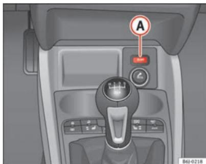
Fig. 108 Detalle del pulsador del funcionamiento Start-Stop.
