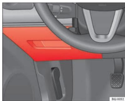
**Fig. 146** Fusibles en tablero de instrumentos
