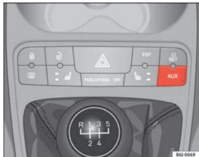
Fig. 88 Conexión AUX en consola central (en función del equipamiento)
