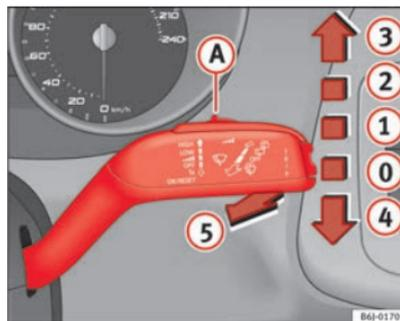
Fig. 64 Palanca del limpia-lavacristales
