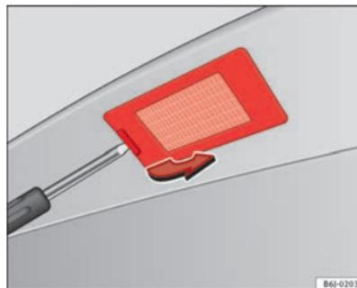
Fig. 164 Desmontaje de la luz de matrícula.
