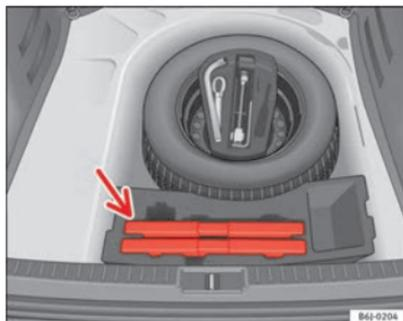
Fig. 90 Alojamiento para el triángulo de preseñalización en el maletero.
