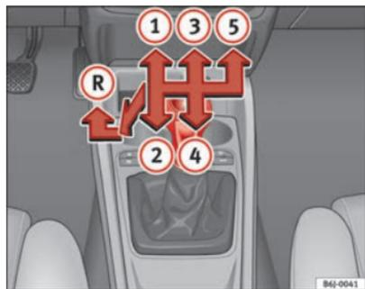
Fig. 110 Consola Central: esquema de un cambio manual de 5 marchas
