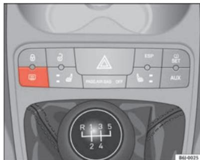
Fig. 58 Consola central: conmutador de luneta térmica
