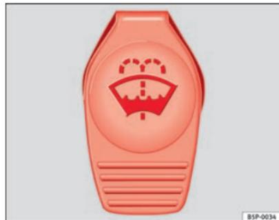
Fig. 135 Tapón del depósito del lavacristales en el vano motor.
