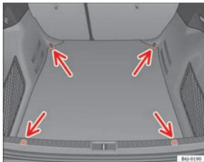
Fig. 93 Disposición de las argollas de amarre en el maletero
