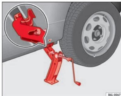
**Fig. 144** Colocación del gato
