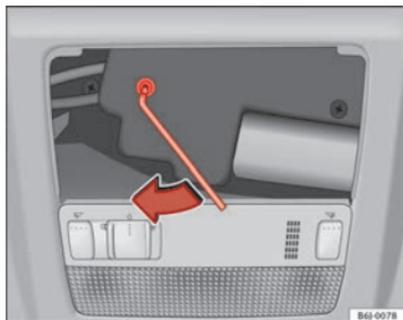
**Fig. 53** Accionamiento de emergencia techo panorámico/deflector
