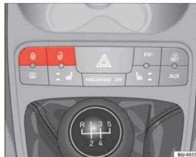
Fig. 43 Pulsador del cierre centralizado
