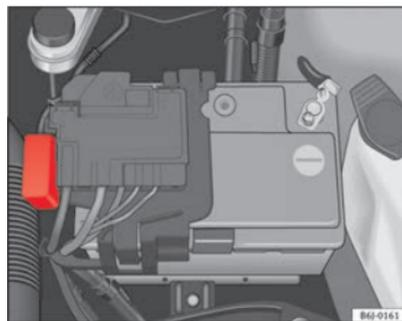
Fig. 147 Fusibles en el compartimento motor
