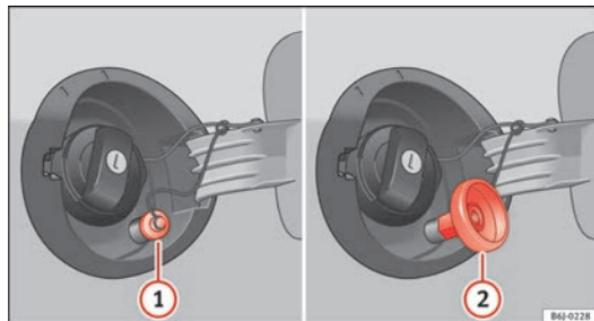
Fig. 127 Tapa del depósito abierta con boca de carga de GLP y adaptador.
