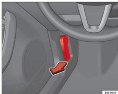
Fig. 130 Palanca apertura capó motor
