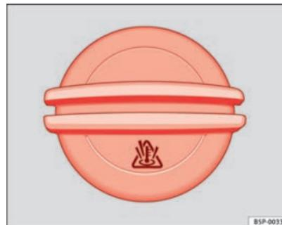
Fig. 134 Tapón del depósito de expansión del líquido refrigerante en el vano motor
