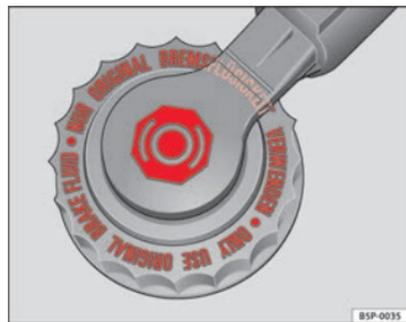
Fig. 138 Tapón del depósito del líquido de frenos en el vano motor
