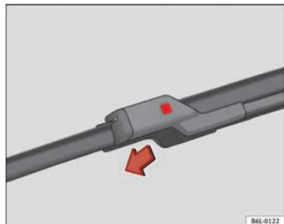
Fig. 136 Cambio escobilla limpiaparabrisas
