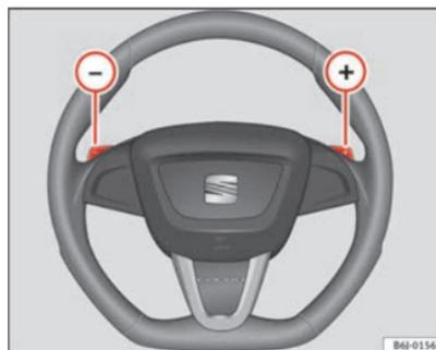
Fig. 116 Volante con levas para cambio automático
