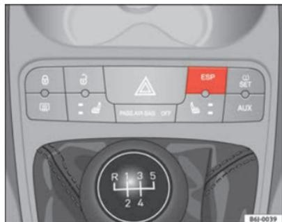
Fig. 105 Detalle de la consola central: tecla ESP.
