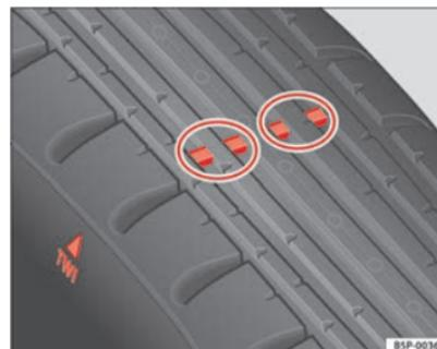
Fig. 139 Indicadores de desgaste del perfil del neumático
