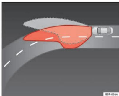
**Fig. 57 Iluminación de la curva con faros autodireccionables**
