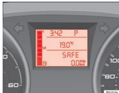
Fig. 113 Cambio automático: pantalla del cuadro de instrumentos
