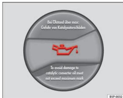
Fig. 133 Tapón de la boca de llenado de aceite del motor en el vano motor
