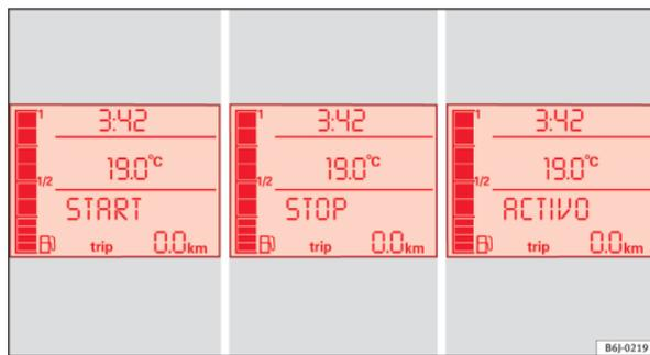
Fig. 109 Indicación en la pantalla del cuadro de instrumentos durante el funcionamiento Start-Stop.
