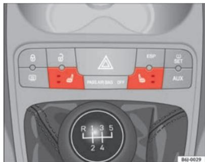
Fig. 73 Conmutador de la calefacción de los asientos delanteros
