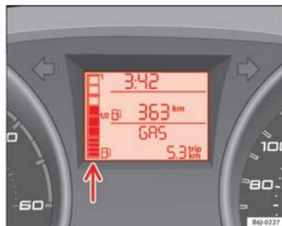
Fig. 31 Cuadro de instrumentos: indicador del nivel de gas.
