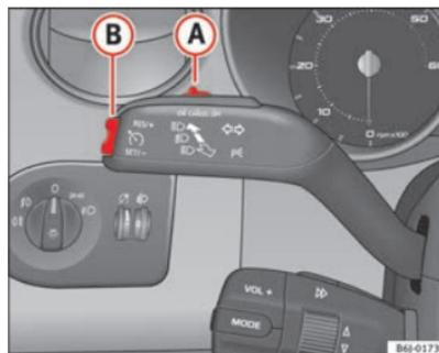
Fig. 123 Palanca de intermitentes y de luz de carretera: mando y tecla basculante para el regulador de velocidad
