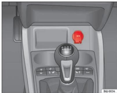
Fig. 86 Toma de corriente delantera
