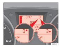
Fig. 33 Gear display
