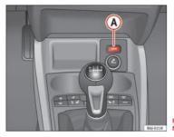
Fig. 108 The Start-Stop function button.
