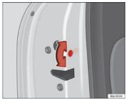
Fig. 44 Childproof lock on the left hand side door
