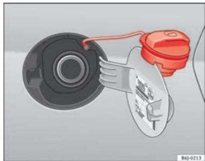
Fig. 127 Tapa del depósito abierta
