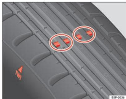
**Fig. 142** Indicadores de desgaste del perfil del neumático
