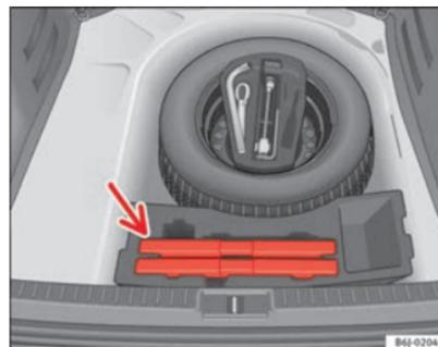
Fig. 91 Alojamiento para el triángulo de preseñalización en el maletero.
