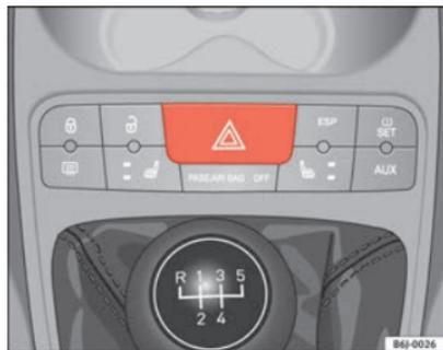
Fig. 59 Consola central: conmutador de los intermitentes de emergencia
