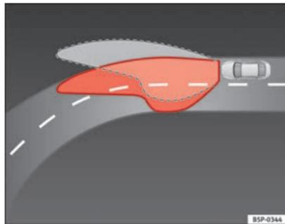
Fig. 57 Iluminación de la curva con faros autodireccionables
