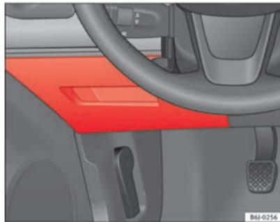
**Fig. 149** Fusibles en tablero de instrumentos
