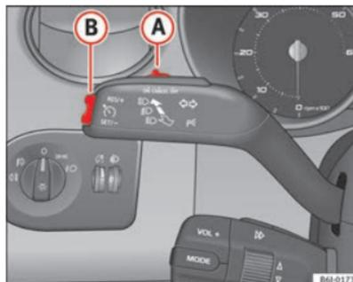
Fig. 124 Palanca de intermitentes y de luz de carretera: mando y tecla basculante para el regulador de velocidad ▶
