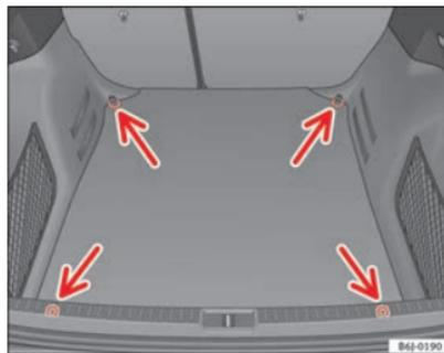
**Fig. 94** Disposición de las argollas de amarre en el maletero
