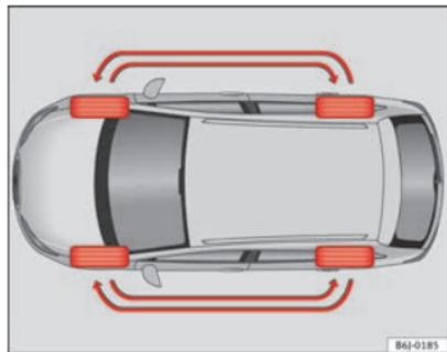
**Fig. 143** Esquema para el cambio de ruedas
