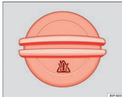
**Fig. 135** Tapón del depósito de expansión del líquido refrigerante en el vano motor
