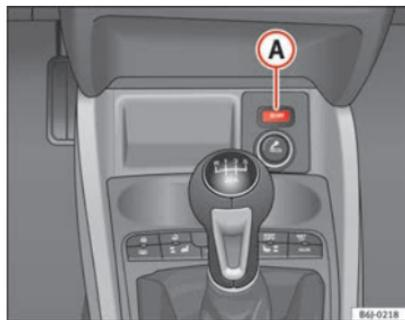
Fig. 109 Detalle del pulsador del funcionamiento Start-Stop.
