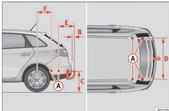
**Fig. 126** Puntos de fijación del dispositivo de remolque
