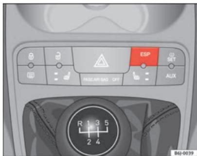
Fig. 106 Detalle de la consola central: tecla ESP.
