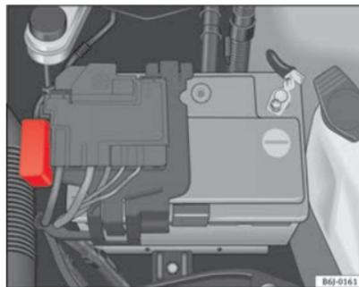
Fig. 150 Fusibles en el compartimento motor
