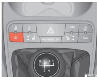
Fig. 58 Consola central: conmutador de luneta térmica
