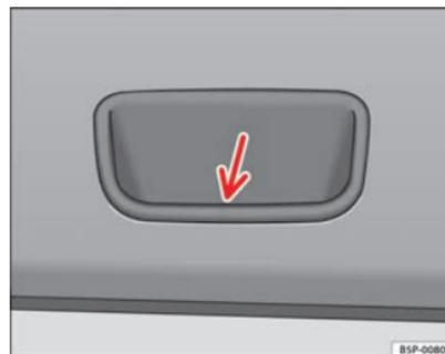
Fig. 49 Detalle del guardanido interior del portón trasero: cavidad para tirar
