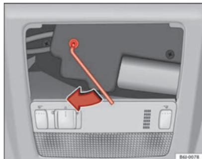
Fig. 53 Accionamiento de emergencia techo panorámico/deflector
