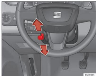
Fig. 105 Ajuste de altura del volante
