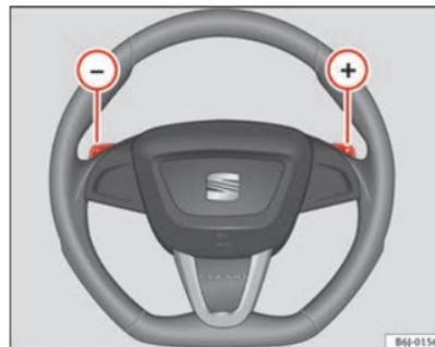
Fig. 117 Volante con levas para cambio automático
