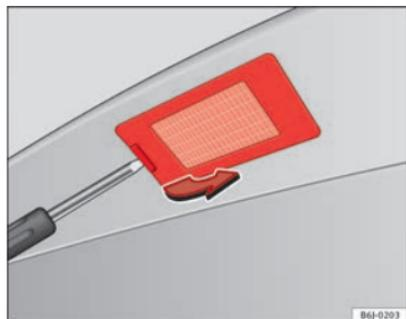
Fig. 174 Desmontaje de la luz de matrícula.
