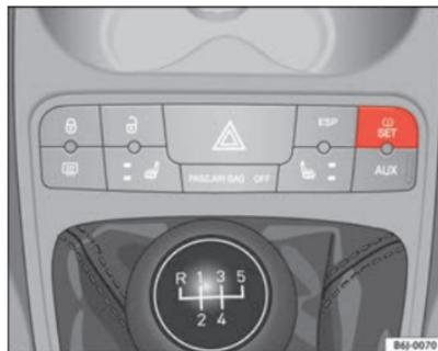
Fig. 40 Consola central: tecla del sistema de control de los neumáticos ▶
