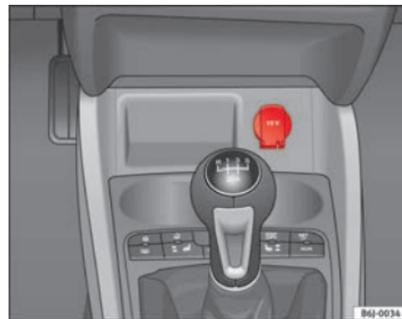
Fig. 87 Toma de corriente delantera
