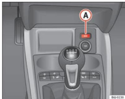
Fig. 108 Consola central: conmutador de control del sistema de gas.
