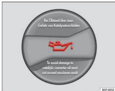
Fig. 134 Tapón de la boca de llenado de aceite del motor en el vano motor
