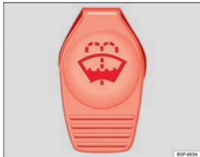
Fig. 136 Tapón del depósito del lavacristales en el vano motor.
