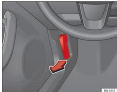
Fig. 131 Palanca apertura capó motor
