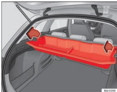
Fig. 97 Desmontaje cajón portaobjetos
