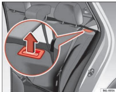
Fig. 75 Tecla de desbloqueo del respaldo trasero
