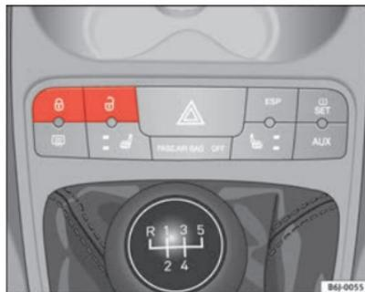
Fig. 43 Pulsador del cierre centralizado
