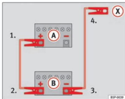
Fig. 178 Esquema para conectar los cables de emergencia en el caso de que el vehículo que suministra la corriente no disponga del sistema Start-Stop: batería descargada (A) y batería que suministra la corriente (B).
