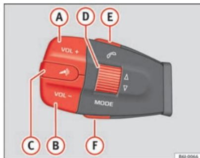
Fig. 42 Control Audio+ teléfono
