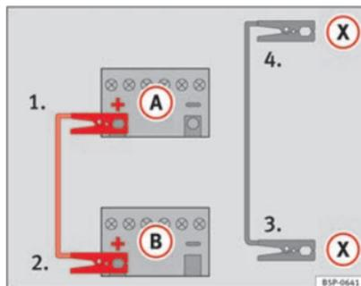
Fig. 179 Esquema para conectar los cables de emergencia en el caso de que el vehículo que suministra la corriente disponga del sistema Start-Stop: batería descargada (A) y batería que suministra la corriente (B).
