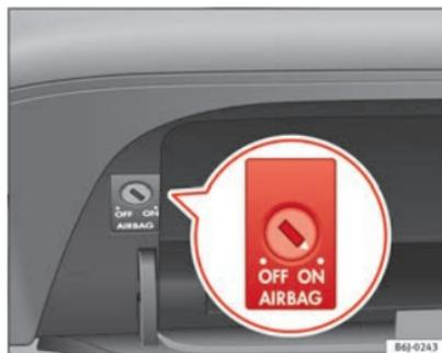
Fig. 21 En la guantera: conmutador con llave para activar y desactivar el airbag del acompañante
