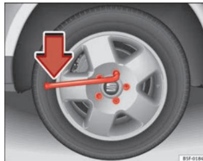
Fig. 148 Substituição de roda: desapertar os parafusos da roda
