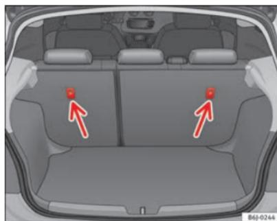
Fig. 27 Posição das anilhas Top Tether na parte posterior do banco traseiro
