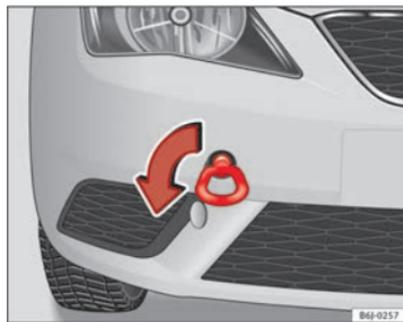
Fig. 190 Enroscamento da argola de reboque na parte dianteira do veículo
