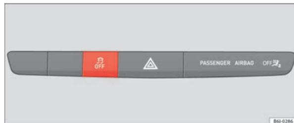
Fig. 109 Pormenor do painel de instrumentos: botão ESC.
