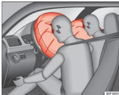
**Fig. 18** Airbags frontais inflados
