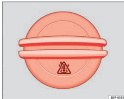
Fig. 138 Tampão do reservatório de expansão do líquido de refrigeração no compartimento do motor
