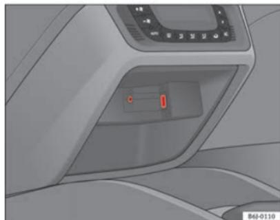
Fig. 93 Ligação entrada AUX-USB (em função do equipamento)
