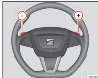
Fig. 120 Volante com patilhas para a caixa de velocidades automática
