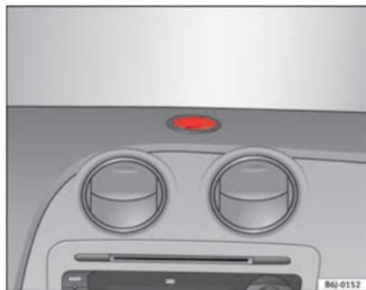
Fig. 82 Suporte para navegador no painel.
