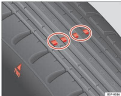
Fig. 145 Indicadores de desgaste no perfil do pneu
