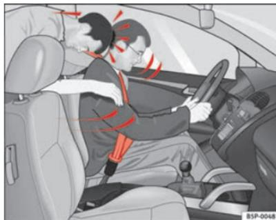
**Fig. 9 O passageiro do banco traseiro que não tiver colocado o cinto de segurança é projectado para a frente, para cima do condutor que tem o cinto colocado.**
