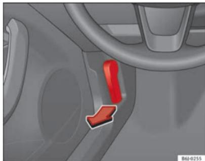
Fig. 134 Manipulo de abertura do capot do motor
