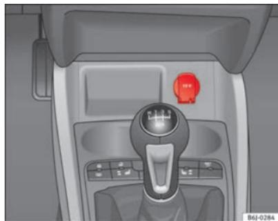
Fig. 90 Tomada de corrente dianteira
