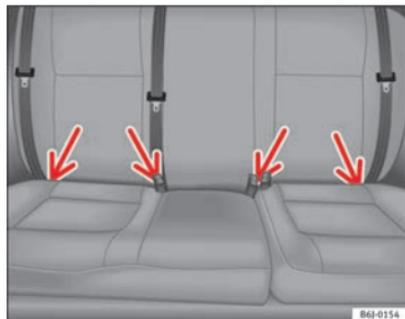
Fig. 26 Anéis de fixação ISOFIX
