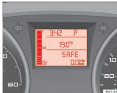
**Fig. 36** Ecrã digital: Posição da alavanca da caixa de velocidades automática
