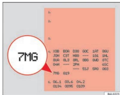
Fig. 128 Etiqueta de dados do veículo no reverso da capa do Programa de Manutenção
