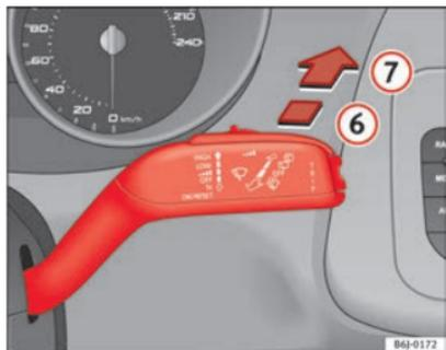
Fig. 68 Manípulo do limpa/lava-vidros: limpa-vidros traseiro
