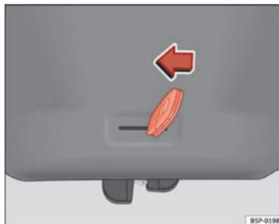
Fig. 50 IBIZA / IBIZA SC: Abertura de emergência da porta do porta-bagagens
