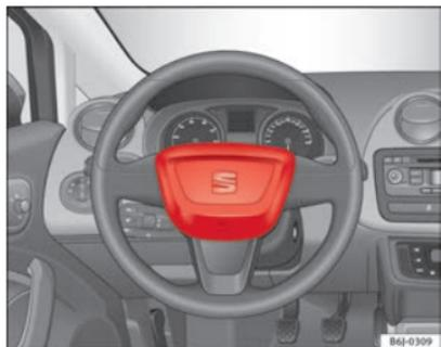
**Fig. 16 Airbag do condutor no volante**
