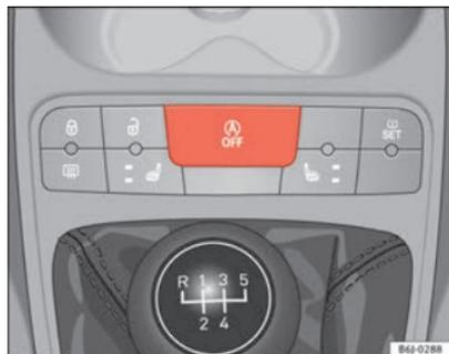
Fig. 112 Pormenor do botão do funcionamento Start-Stop.
