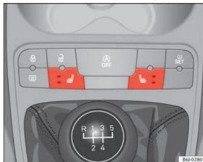
Fig. 76 Comutador do aquecimento dos bancos dianteiros
