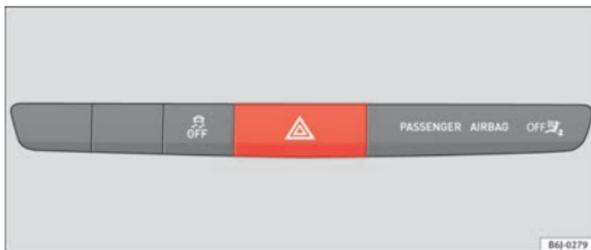
Fig. 61 Painel de instrumentos: interruptor das luzes de emergência
