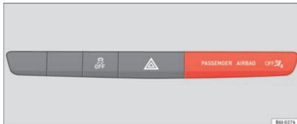
Fig. 22 Aviso de controlo da desactivação do airbag do passageiro
