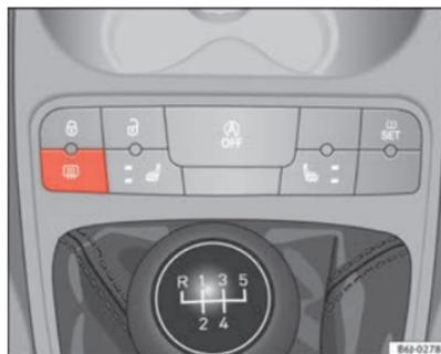
**Fig. 60** Consola central: comutador do desembaciador do vidro traseiro
