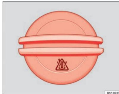
Fig. 138 Tapón del depósito de expansión del líquido refrigerante en el vano motor
