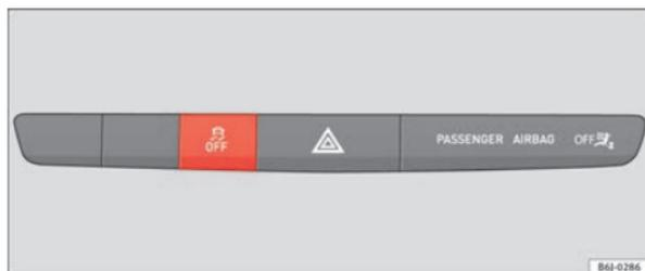
Fig. 109 Detalle del tablero de instrumentos: tecla ESC.
