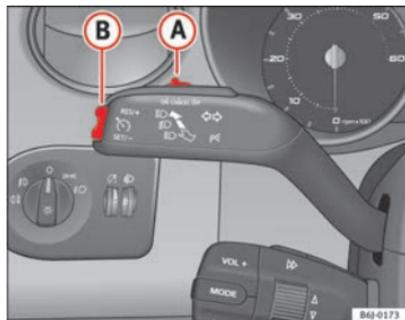
Fig. 127 Palanca de intermitentes y de luz carretera: mando y tecla basculante para el regulador de velocidad
