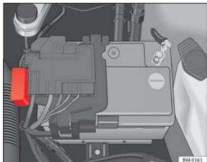
Fig. 153 En el vano motor: tapa de la caja de fusibles.
