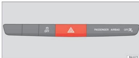
Fig. 61 Tablero de instrumentos: conmutador de los intermitentes de emergencia
