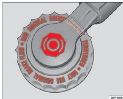
Fig. 144 Tapón del depósito del líquido de frenos en el vano motor
