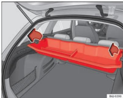
Fig. 100 Desmontaje cajón portaobjetos
