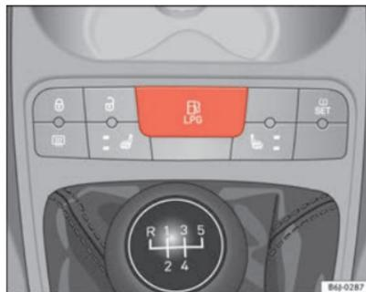
Fig. 111 Consola central: conmutador de control del sistema de gas.
