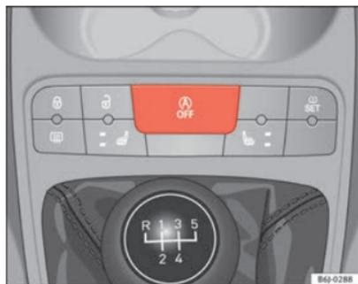
Fig. 112 Detalle del pulsador del funcionamiento Start-Stop.
