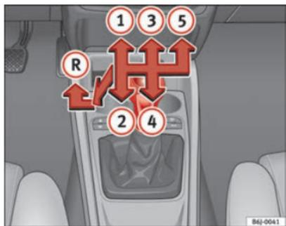
Fig. 114 Consola Central: esquema de un cambio manual de 5 marchas
