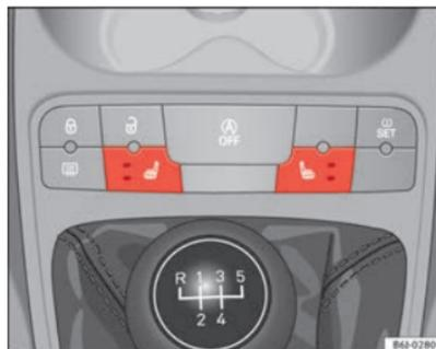
Fig. 76 Conmutador de la calefacción de los asientos delanteros
