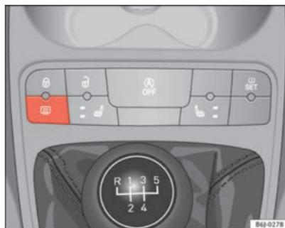
Fig. 60 Consola central: conmutador de luneta térmica
