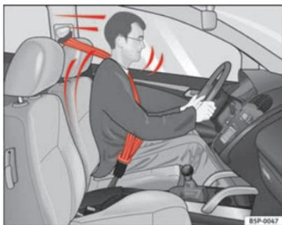
**Fig. 10** Conductor con el cinturón de seguridad bien puesto: es sujetado por el mismo en un frenazo brusco
