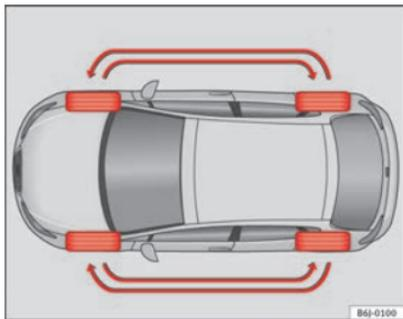
Fig. 146 Esquema para el cambio de ruedas
