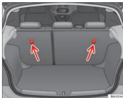
Fig. 27 Posición de las anillas Top Tether en la parte posterior del asiento trasero
