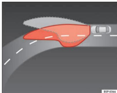
Fig. 59 Iluminación de la curva con faros autodireccionables
