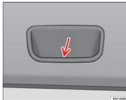
Fig. 49 Detalle del guardado interior del portón trasero: cavidad para tirar
