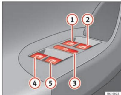
Fig. 52 Detalle de la puerta del conductor: mandos para las ventanillas delanteras y traseras (vehículo de 5 puertas)
