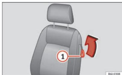
Fig. 75 Asientos delanteros: palanca para abatir el respaldo
