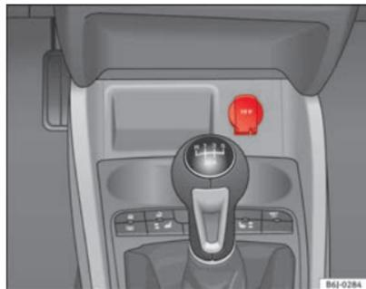
Fig. 90 Toma de corriente delantera
