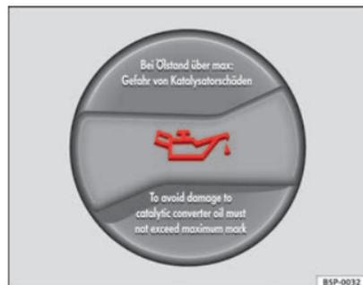
Fig. 137 Tapón de la boca de llenado de aceite del motor en el vano motor
