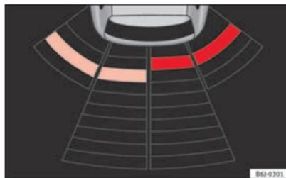
Fig. 123 Visualización de ayuda al aparcamiento en la pantalla del navegador.
