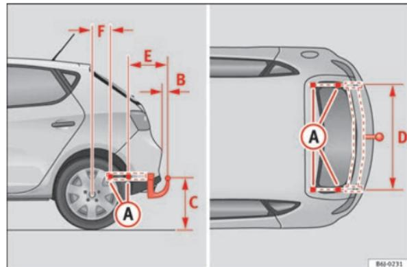
Fig. 129 IBIZA / IBIZA SC: Puntos de fijación del dispositivo de remolque
