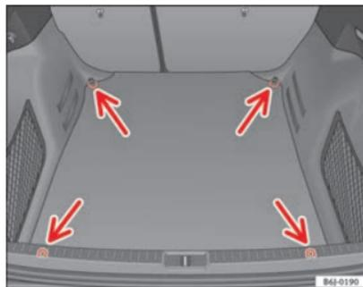
Fig. 97 Disposición de las argollas de amarre en el maletero
