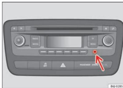
Fig. 92 Conexión AUX en consola central (en función del equipamiento)
