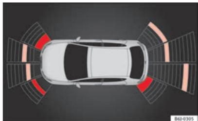
**Fig. 124** Visualización de ayuda al aparcamiento en la pantalla del navegador.
