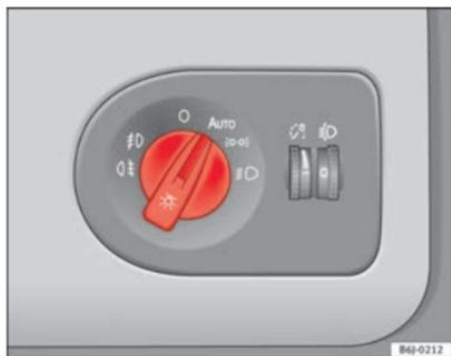
**Fig. 57 Encendido automático de luces**
