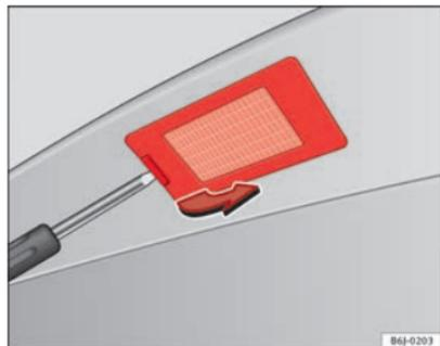
Fig. 184 Desmontaje de la luz de matrícula.
