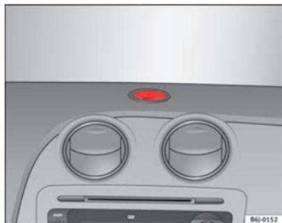
Fig. 82 Soporte para navegador en tablero.
