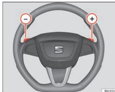
Fig. 120 Volante con levas para cambio automático
