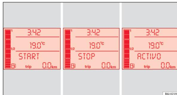
Fig. 113 Indicación en la pantalla del cuadro de instrumentos durante el funcionamiento Start-Stop.
