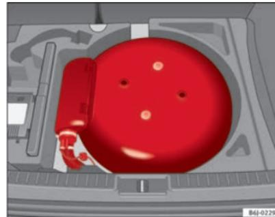
Fig. 132 Depósito de GLP en la cavidad de la rueda de repuesto.
