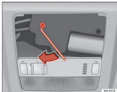
Fig. 55 Accionamiento de emergencia techo panorámico/deflector
