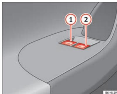
Fig. 53 Detalle de la puerta del conductor: mandos para las ventanillas delanteras (vehículo de 3 puertas)
