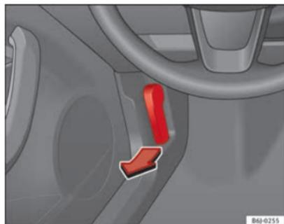
Fig. 134 Palanca apertura capó motor
