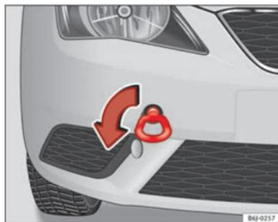
Fig. 190 Atornillado de la argolla de remolque en la parte delantera del vehículo
