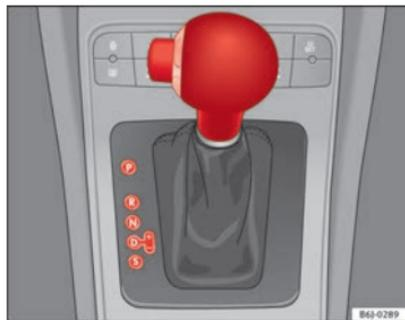
Fig. 115 Cambio automático
