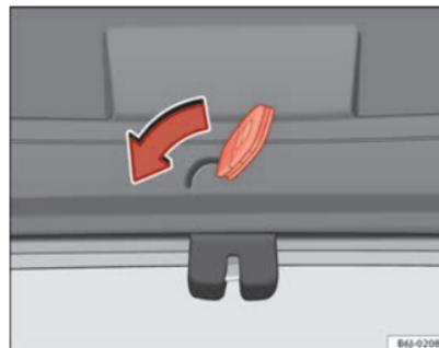
Fig. 51 IBIZA ST: Apertura de emergencia del portón trasero
