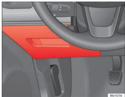
Fig. 152 Lado izquierdo del tablero de instrumentos: tapa de la caja de fusibles.
