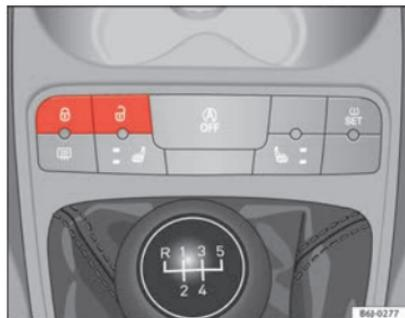
Fig. 43 Pulsador del cierre centralizado
