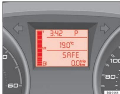
Fig. 117 Cambio automático: pantalla del cuadro de instrumentos
