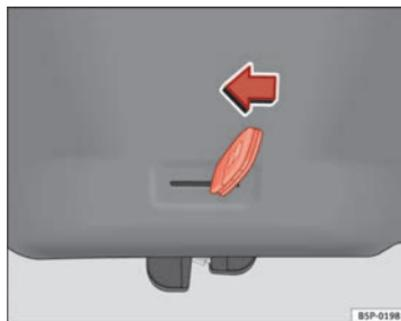
Abb. 50 IBIZA / IBIZA SC: Notentriegelung der Heckklappe
