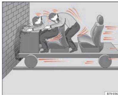
**Abb. 7** Prinzipdarstellung: Das Fahrzeug prallt mit nicht angegurtenen Insassen gegen die Mauer
