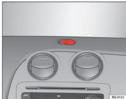
Abb. 82 Halterung für Navigationsgerät an Instrumententafel
