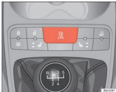
Abb. 111 Mittelkonsole: Kontrollschalter für Autogasanlage.
