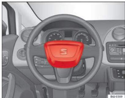
**Abb. 16 Einbauort Fahrerairbag: im Lenkrad**
