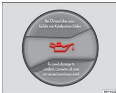
Abb. 137 Deckel der Motoröl-Einfüllöffnung im Motorraum
