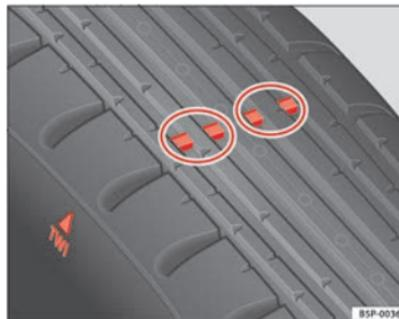
Abb. 145 Prinzipdarstellung Reifenprofil: Verschleißanzeiger
