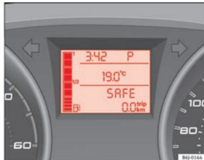
Abb. 117 Automatikgetriebe: Display des Kombiinstruments
