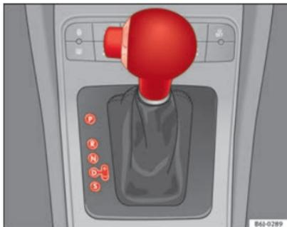
Abb. 119 Schalten mit Tiptronic
