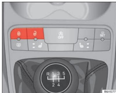
Abb. 43 Taster für Zentralverriegelung
