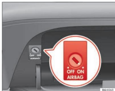
Abb. 21 Im Handschuhfach: Schlüsselschalter zum Ein- und Abschalten des Beifahrer-Airbags
