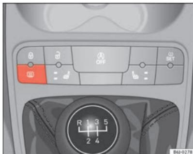
Abb. 60 Ausschnitt aus der Mittelkonsole: Schalter für Heckscheibenbeheizung
