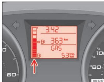
Abb. 31 Kombiinstrument, Gasvorratsanzeige
