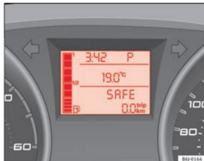
Abb. 36 Display: Wählhebelstellung des Automatikgetriebes
