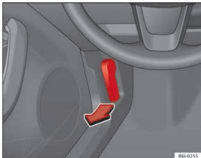
Abb. 134 Öffnungshebel für Motorraumklappe
