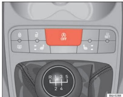
Abb. 112 Ansicht des Tasters für den Start-Stopp-Betrieb
