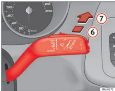
Abb. 68 Scheibenwischer- und Scheibenwascherhebel: Scheibenwischer für die Heckscheibe
