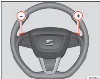
Abb. 120 Lenkrad mit Schaltwippen für Automatikgetriebe
