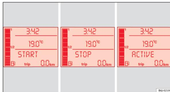
Abb. 113 Anzeige am Display des Kombiinstrumentes während des Start-Stopp-Betriebs
