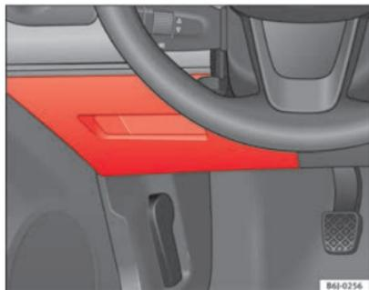
Abb. 152 Links in der Instrumententafel: Abdeckung des Sicherungskastens.
