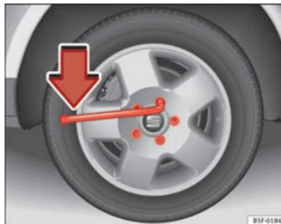
Abb. 148 Radwechsel: Radschrauben lockern
