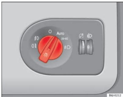
Abb. 57 Automatisches Fahrlicht
