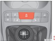
Fig. 112 The Start-Stop function button.
