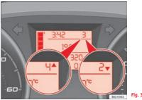
Fig. 33 Gear display
