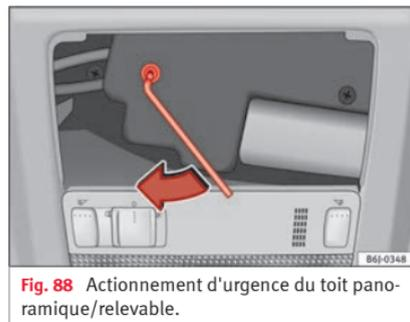
Fig. 88 Actionnement d'urgence du toit panoramique/relevable.
