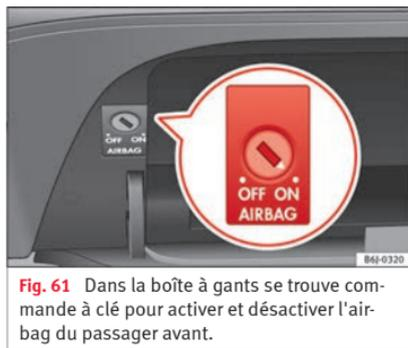
Fig. 61 Dans la boîte à gants se trouve commande à clé pour activer et désactiver l'airbag du passager avant.
