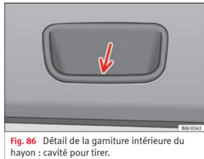
**Fig. 86** Détail de la garniture intérieure du hayon : cavité pour tirer.
