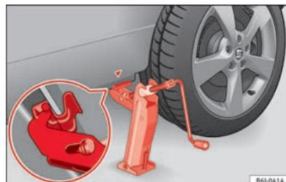
**Fig. 161** Mise en place du cric.
