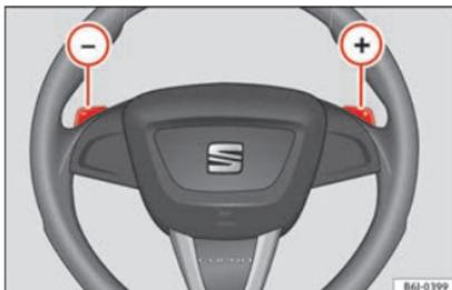
Fig. 137 Volant avec commandes pour boîte automatique.
