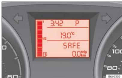
**Fig. 75** Afficheur : Position du levier de la boîte automatique.
