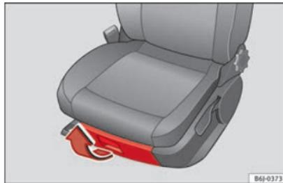
**Fig. 108** Rangement sous le siège avant droit.
