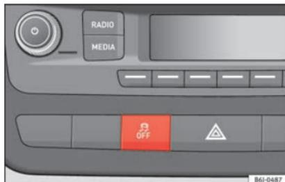
Fig. 140 Détail de la planche de bord : touche ESC.
