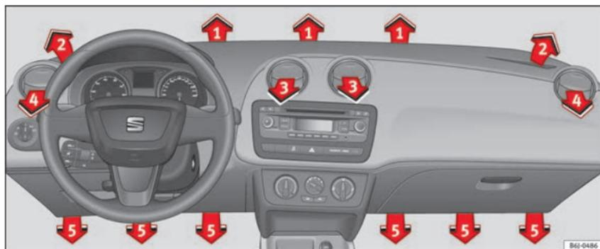
Fig. 127 Diffuseurs d'air.
