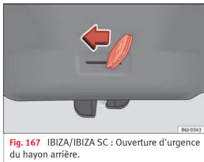
Fig. 167 IBIZA/IBIZA SC : Ouverture d'urgence du hayon arrière.
