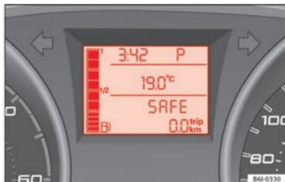
Fig. 138 Boîte automatique : écran du tableau de bord.
