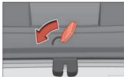
Fig. 168 IBIZA ST : Ouverture d'urgence du hayon arrière.
