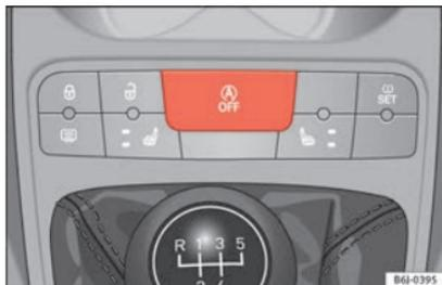
**Fig. 141** Détail du bouton du fonctionnement Start-Stop.
