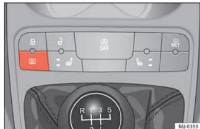
Fig. 94 Console centrale : contacteur de dégivrage de lunette arrière.
