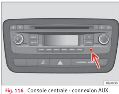
**Fig. 116** Console centrale : connexion AUX.
