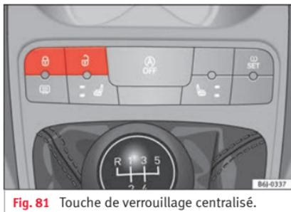
Fig. 81 Touche de verrouillage centralisé.
