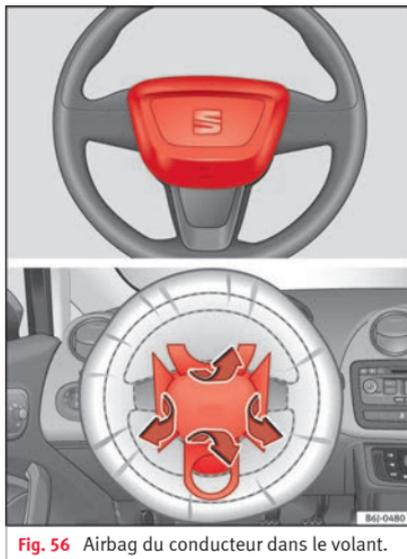
Fig. 56 Airbag du conducteur dans le volant.
