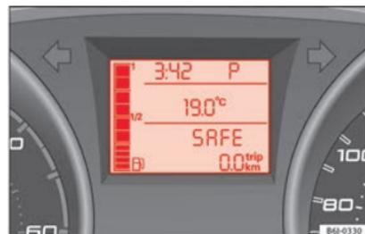
Fig. 134 Boîte automatique : écran du tableau de bord.
