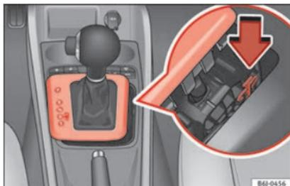
**Fig. 169** Déverrouillage d'urgence du levier sélecteur.
