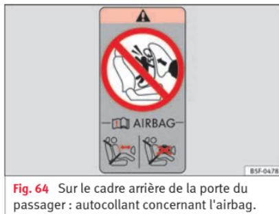
Fig. 64 Sur le cadre arrière de la porte du passager : autocollant concernant l'airbag.
