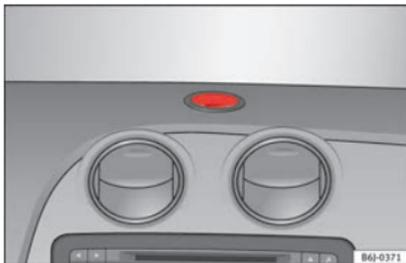
**Fig. 106** Support pour navigateur sur la planche de bord.
