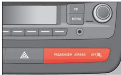
Fig. 62 Sur le tableau de bord, au centre : témoin de désactivation de l'airbag du passager avant.
