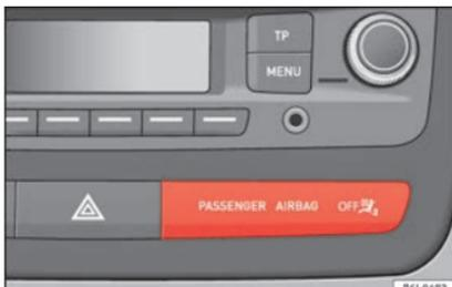
**Abb. 62** Instrumententafel-Mittelteil: Kontrollleuchte für abgeschalteten Beifahrer-Frontairbag.
