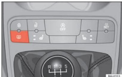
**Abb. 94** Mittelkonsole: Schalter für Heckscheibenbeheizung.
