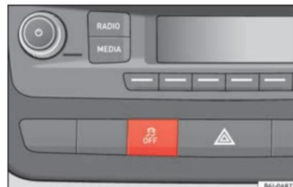
Abb. 140 Ausschnitt von der Instrumententafel: ESC-Taste
