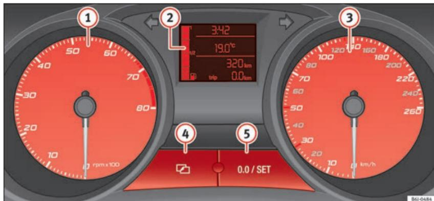
Abb. 70 Ausschnitt von der Instrumententafel: Kombiinstrument
