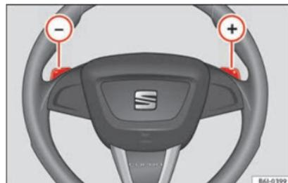
Abb. 137 Lenkrad mit Schaltwippen für Automatikgetriebe.
