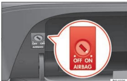
**Abb. 61** Im Handschuhfach: Schlüsselschalter zum Ein- und Abschalten des Beifahrer-Airbags
