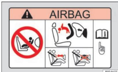
Abb. 63 Sonnenblende auf der Beifahrerseite: Airbagaufkleber.
