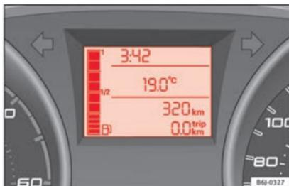
Abb. 72 Ausschnitt aus Kombiinstrument: Kraftstoffvorrats-Anzeige.
