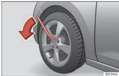
**Abb. 159** Radwechsel: Radschrauben lockern
