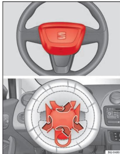
Abb. 56 Einbauort Fahrerairbag: im Lenkrad. »
