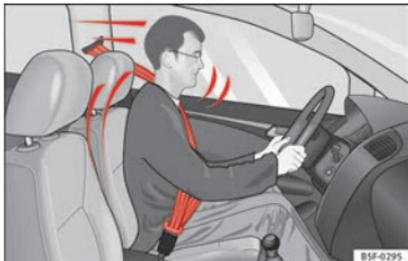
**Abb. 51** Richtig angegurtete Fahrer werden bei einem plötzlichen Bremsmanöver nicht nach vorne geschleudert.
