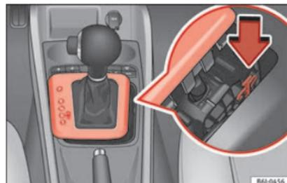
**Abb. 169** Notentriegeln der Wählhebelsperre
