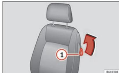
Abb. 98 Vordersitze: Hebel zum Vorklappen der Lehne.
