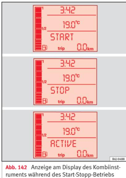
Abb. 142 Anzeige am Display des Kombiinstrumentes während des Start-Stopp-Betriebs
