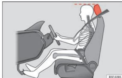
**Abb. 47** Die richtige Kopfstützeinstellung des Fahrers.
