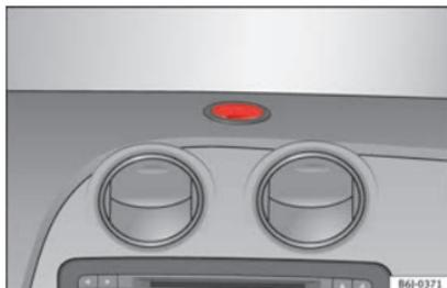
**Abb. 106** Halterung für Navigationsgerät an Instrumententafel
