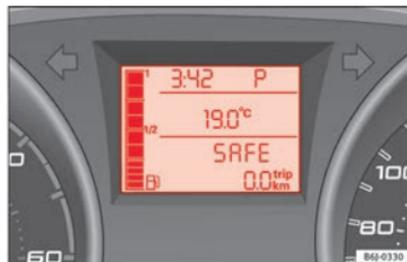
**Abb. 75** Display: Wählhebelstellung des Automatikgetriebes.
