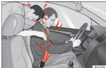
**Abb. 53** Der nicht angegurtete Mitfahrer auf dem Rücksitz schleudert nach vorn auf den angegurteten Fahrer.
