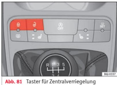
Abb. 81 Taster für Zentralverriegelung
