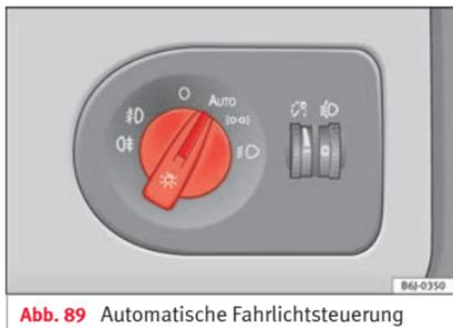
Abb. 89 Automatische Fahrlichtsteuerung
