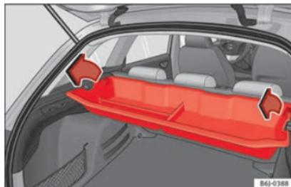
Abb. 121 Gepäckraum: Ausbau des Ablagefachs.
