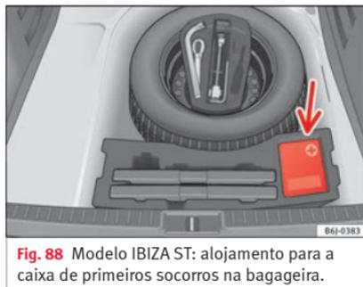
**Fig. 88** Modelo IBIZA ST: alojamento para a caixa de primeiros socorros na bagageira.
