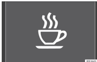
Fig. 175 No ecrã do painel de instrumentos: símbolo de deteção de fadiga.
