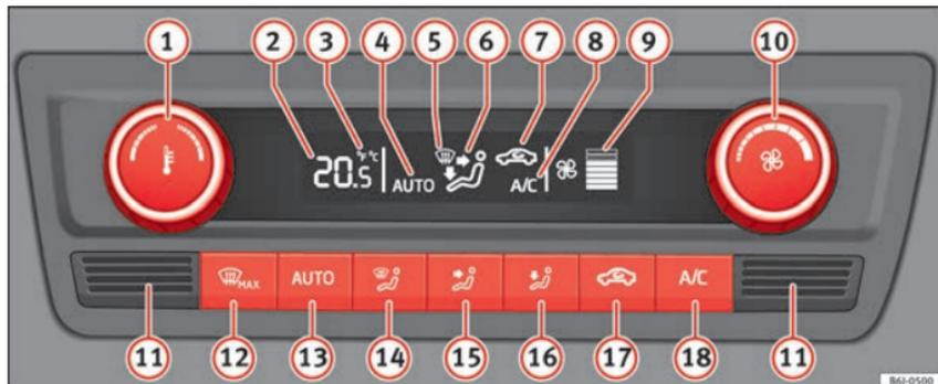
Fig. 167 Climatronic: elementos de utilização.
