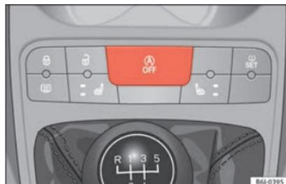
**Fig. 174** Pormenor do botão do funcionamento Start-Stop. »
