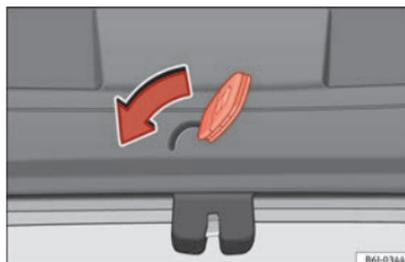
Fig. 5 IBIZA ST: Abertura de emergência da porta da mala.
