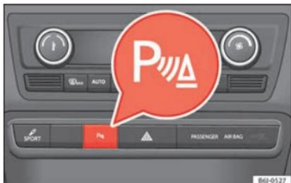
**Fig. 177** Consola central: botão de auxílio de estacionamento.
