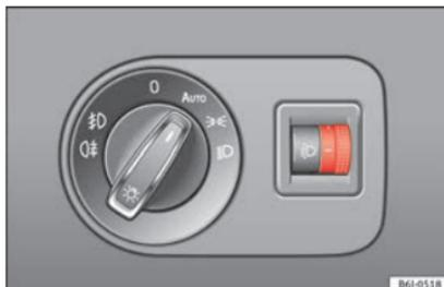
Fig. 134 Painel de instrumentos: regulador do alcance dos faróis.
