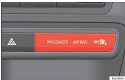
**Fig. 86** Painel de instrumentos, parte central: luz de controlo da desativação do airbag do passageiro.
