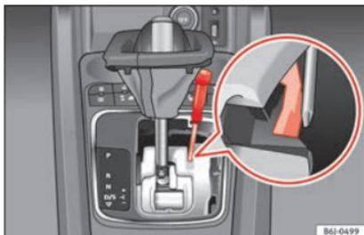
Fig. 47 Desbloqueio de emergência da alavanca de seleção.
