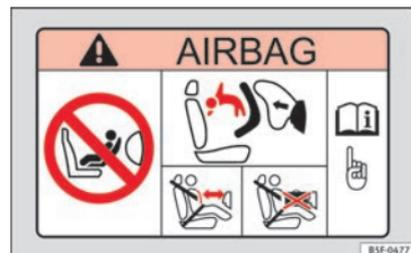
**Fig. 23** Pala do sol do lado do passageiro: autocolante do airbag.
