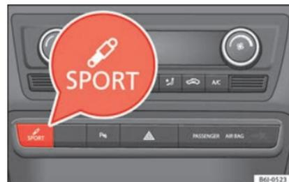
Fig. 183 Na consola central: botão para ajustar o sistema "SEAT Drive Profile"
