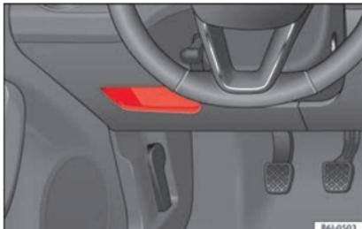
**Fig. 57** No painel de instrumentos do lado do condutor: tampa da caixa de fusíveis.
