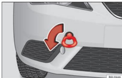
Fig. 90 Argola de rebocagem dianteira
