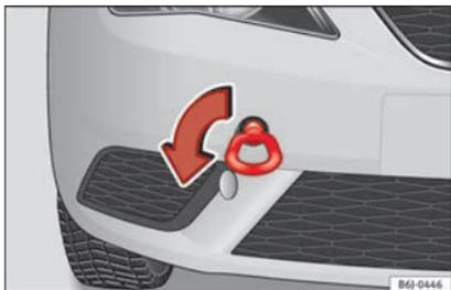
Fig. 68 Para-choques dianteiro, direita: argola de reboque.
