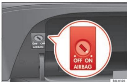
Fig. 19 Interruptor do airbag frontal do passageiro.
