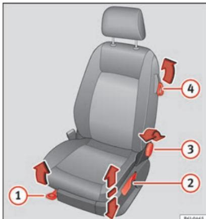
**Fig. 11** Bancos dianteiros: ajuste manual do banco.
