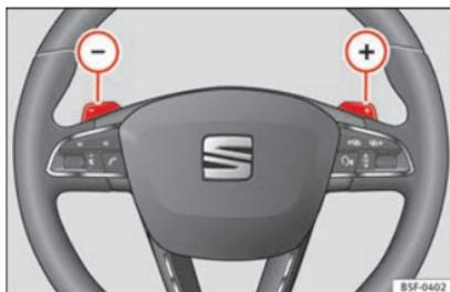
Fig. 172 Volante com patilhas para a caixa de velocidades automática.
