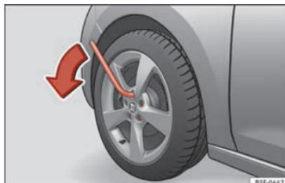
**Fig. 65** Roda: desapertar os parafusos da roda.
