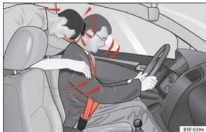
**Fig. 82** O passageiro do banco traseiro que não tiver colocado o cinto de segurança é projetado para a frente, para cima do condutor que tem o cinto colocado.
