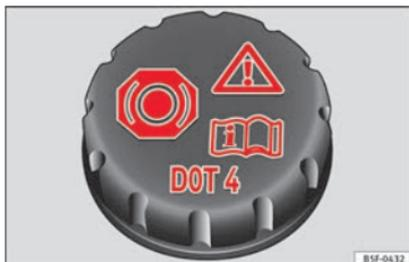
Fig. 55 Compartimento do motor: tampa do depósito do líquido dos travões.
