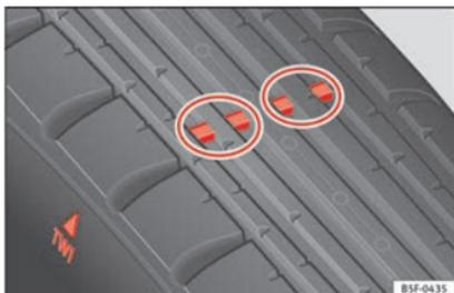
**Fig. 189** Indicadores de desgaste no perfil do pneu.
