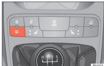
**Fig. 136** Consola central: comutador do desembaciador do vidro traseiro.
