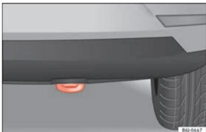
Fig. 69 Para-choques traseiro, direita: argola de reboque.
