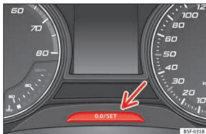
**Fig. 122** Painel de instrumentos: conta-quilómetros e botão de retrocesso.
