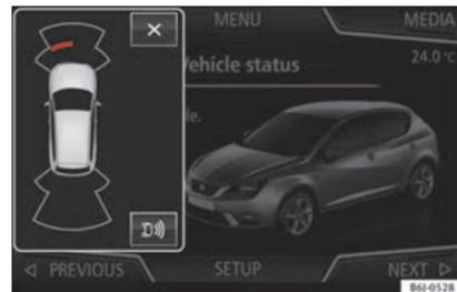
**Fig. 178** Indicação em miniatura da ativação automática
