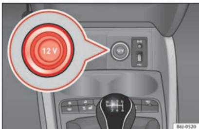
Fig. 154 Tomada de corrente dianteira.
