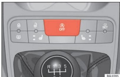
**Fig. 174** Dettaglio del pulsante della modalità Start-Stop.
