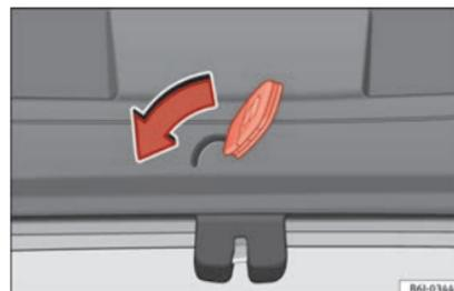
**Fig. 5** IBIZA ST: Apertura d'emergenza del portellone posteriore.
