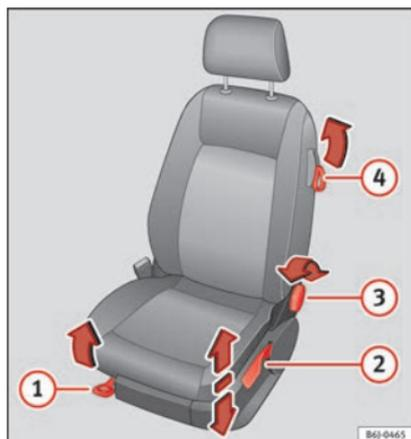
**Fig. 11** Sedili anteriori: regolazione manuale del sedile.
