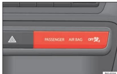
Fig. 86 Sulla parte centrale del quadro strumenti: spia della disattivazione degli airbag del passeggero anteriore.
