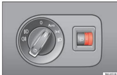
Fig. 134 Plancia portastrumenti: Correttore assetto fari
