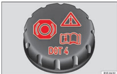
Fig. 55 Vano motore: tappo del serbatoio del liquido dei freni.
