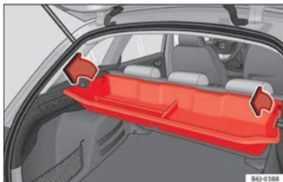
**Fig. 160** Bagagliaio: smontaggio del cassetto portaoggetti.
