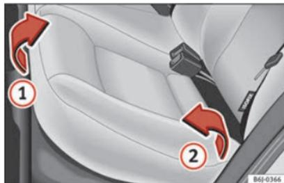
**Fig. 143** Sollevamento dell'elemento orizzontale del sedile posteriore.
