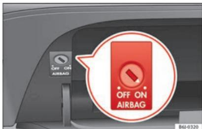
Fig. 19 Commutatore dell'airbag frontale del passeggero.
