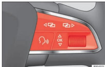
Fig. 38 Lato destro del volante multifunzionale: tasti di controllo.
