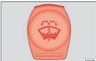
Fig. 56 Nel vano motore: tappo del serbatoio del tergicristalli.
