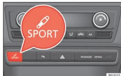
Fig. 183 Sulla console centrale: tasto per regolare il sistema "SEAT Drive Profile"
