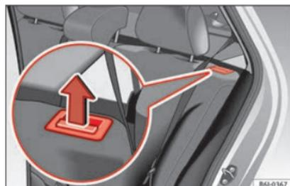
**Fig. 144** Tasto di sblocco dello schienale del sedile posteriore.
