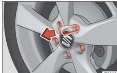
Fig. 63 Ruota: viti della ruota con tappi.
