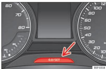
**Fig. 122** Quadro strumenti: contachilometri e tasto di azzeramento.
