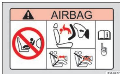
**Fig. 23** Aletta parasole lato passeggero: adesivo dell'airbag.
