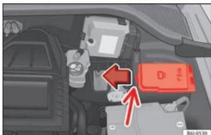
Fig. 58 Nel vano motore: coperchio della scatola dei fusibili.
