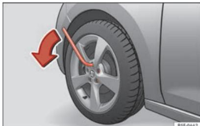
Fig. 65 Ruota: allentare le viti della ruota.
