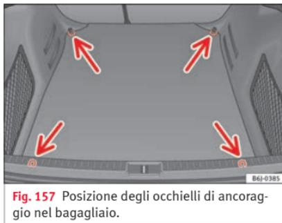
**Fig. 157** Posizione degli occhielli di ancoraggio nel bagagliaio.
