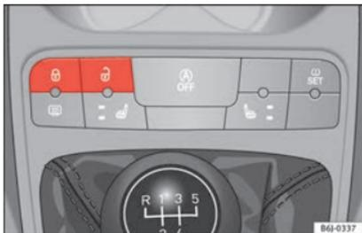
**Fig. 128** Interruttore della chiusura centralizzata.
