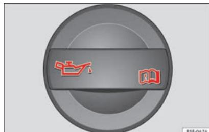
**Fig. 53** Vano motore: tappo del bocchettone di rifornimento dell'olio motore.
