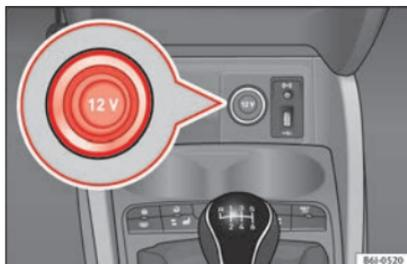
Fig. 154 Presenza elettrica anteriore.
