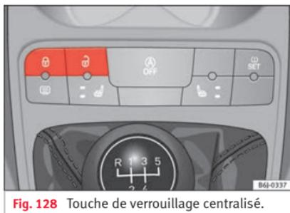
Fig. 128 Touche de verrouillage centralisé.
