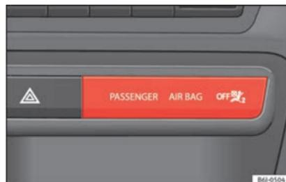
Fig. 86 Sur le tableau de bord, au centre : témoin de désactivation de l'airbag du passager avant.
