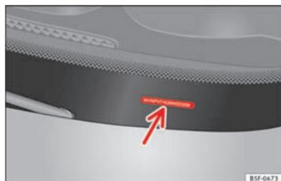
Fig. 192 Numéro de châssis.
