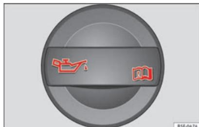
Fig. 53 Dans le compartiment-moteur : bouchon de l'orifice de remplissage d'huile moteur.
