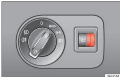
**Fig. 134** Planche de bord : dispositif de réglage de la portée des phares.
