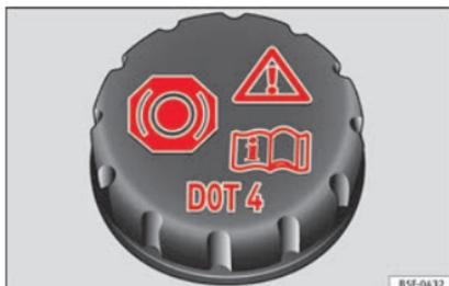
**Fig. 55** Compartiment-moteur : bouchon du réservoir du liquide de frein.
