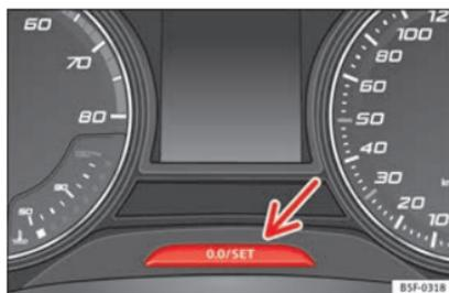
**Fig. 122** Tableau de bord : compteur kilométrique et touche de remise à zéro.
