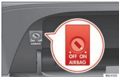
**Fig. 19** Commande de l'airbag frontal du passager.
