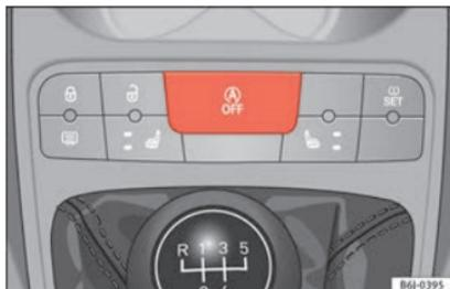
**Fig. 174** Détail du bouton du fonctionnement Start-Stop.
