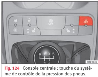
Fig. 124 Console centrale : touche du système de contrôle de la pression des pneus.
