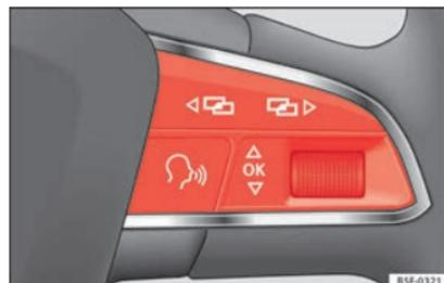
Fig. 38 Partie droite du volant multifonction : touches de contrôle.
