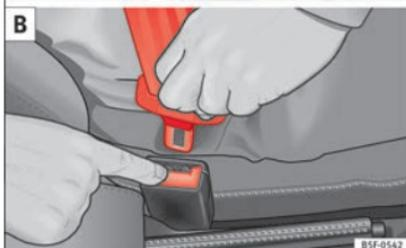
**Fig. 13** Placer et retirer le pêne de verrouillage de la ceinture de sécurité.
