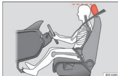
**Fig. 76** Position correcte de l'appuie-tête du conducteur
