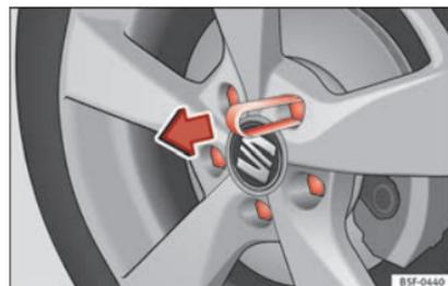
Fig. 63 Roue : boulons de roue avec capuchons.
