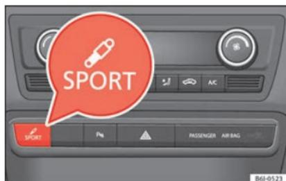
**Fig. 183** Dans la console centrale : touche pour régler le système « SEAT Drive Profile »
