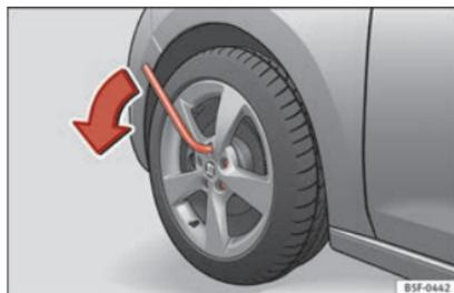
**Fig. 65** Roue : desserrer les vis de roue.
