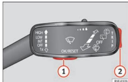
Fig. 37 Levier d'essuie-glace : touches de contrôle.
