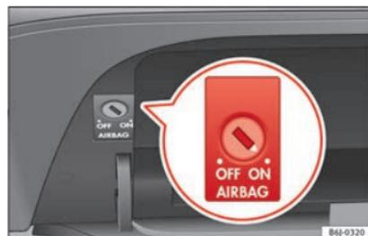
Fig. 85 Dans la boîte à gants se trouve commande à clé pour activer et désactiver l'airbag du passager avant.
