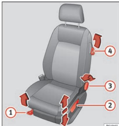
**Fig. 11** Sièges avant : réglage manuel du siège.
