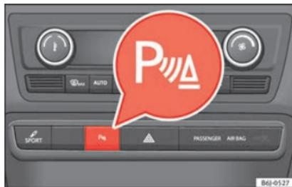
Fig. 177 Console centrale : touche de l'aide au stationnement.
