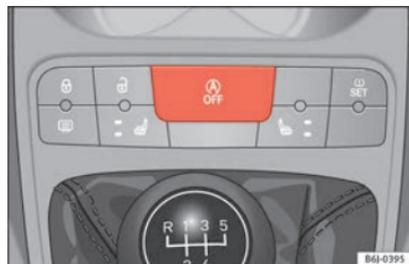
Fig. 174 The Start-Stop function button.
