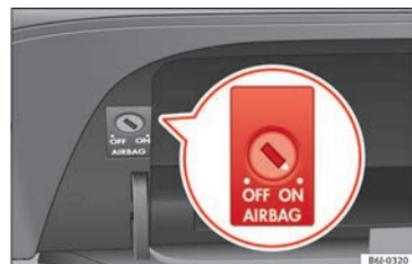
Fig. 18 Interruptor do airbag frontal do passageiro.
