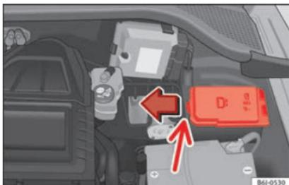
**Fig. 57** No compartimento do motor: tampa da caixa de fusíveis.
