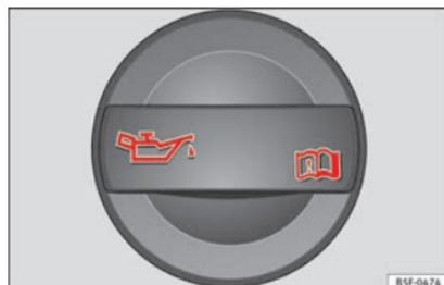
Fig. 52 Tampão do bocal de enchimento do óleo do motor no compartimento do motor.
