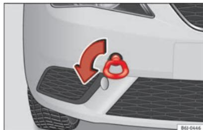
Fig. 87 Argola de rebocagem dianteira
