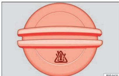
**Fig. 53** Compartimento do motor: tampa do depósito de compensação do líquido de refrigeração.
