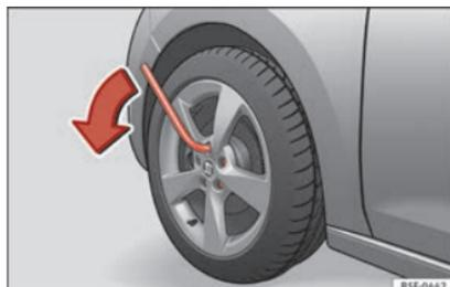
**Fig. 64** Roda: desapertar os parafusos da roda.
