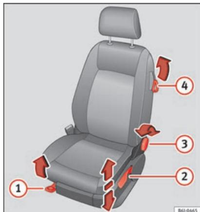
**Fig. 10** Bancos dianteiros: ajuste manual do banco.
