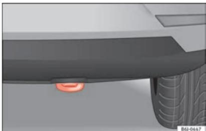
Fig. 68 Para-choques traseiro, direita: argola de reboque.
