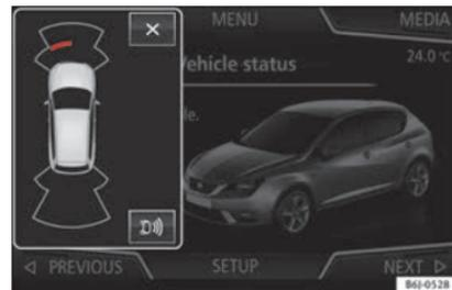
**Fig. 166** Indicação em miniatura da ativação automática
