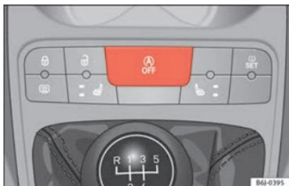
**Fig. 162** Pormenor do botão do funcionamento Start-Stop.
