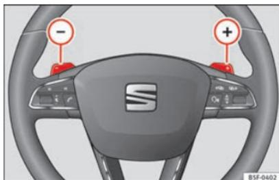
Fig. 160 Volante com patilhas para a caixa de velocidades automática.
