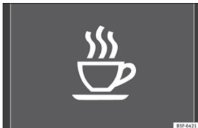
**Fig. 163** No ecrã do painel de instrumentos: símbolo de deteção de fadiga.
