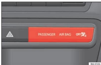
**Fig. 43** Luz de controlo para desativação do airbag do passageiro.
