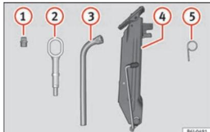
**Fig. 60** Na bagageira, debaixo da cobertura da superfície de carga: ferramentas de bordo.
