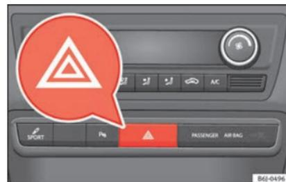
**Fig. 31** Painel de instrumentos: interruptor das luzes de emergência.
