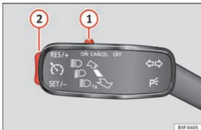
**Fig. 170** Alavanca das luzes indicadoras de mudança de direção e dos máximos: comando e botão basculante para o regulador de velocidade.
