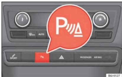
**Fig. 165** Consola central: botão de auxílio de estacionamento.
