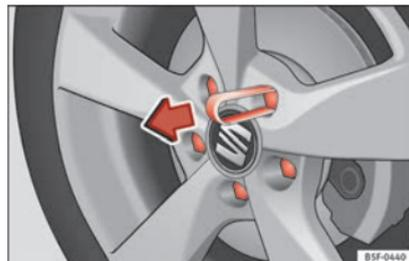
**Fig. 62** Roda: parafusos da roda com capas de proteção.
