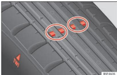
**Fig. 177** Indicadores de desgaste no perfil do pneu.
