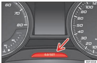
**Fig. 114** Painel de instrumentos: conta-quilómetros e botão de retrocesso.
