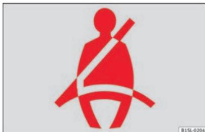
Fig. 78 Luz de advertência no painel de instrumentos.
