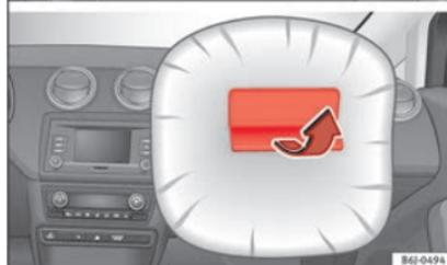
Fig. 17 Airbag do passageiro no painel de instrumentos.
