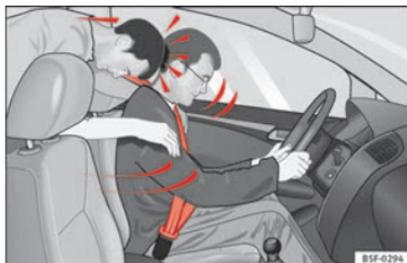
**Fig. 81** O passageiro do banco traseiro que não tiver colocado o cinto de segurança é projetado para a frente, para cima do condutor que tem o cinto colocado.
