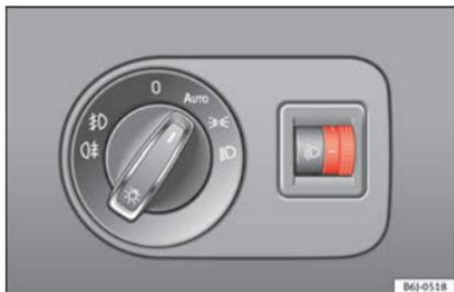
**Fig. 127** Painel de instrumentos: regulador do alcance dos faróis.
