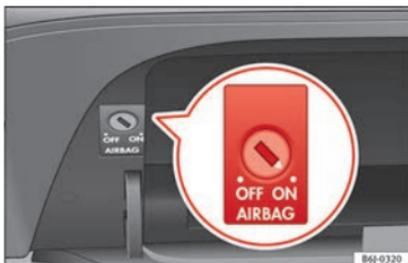
**Fig. 84** No porta-luvas: comutador com chave para ativar e desativar o airbag do passageiro.
