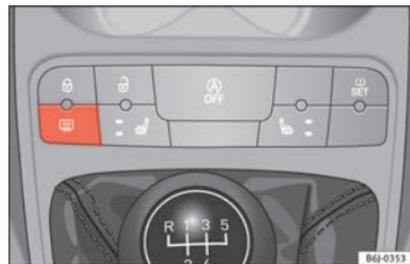
Fig. 128 Consola central: comutador do desembaciador do vidro traseiro.
