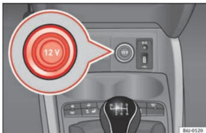
Fig. 146 Tomada de corrente dianteira.
