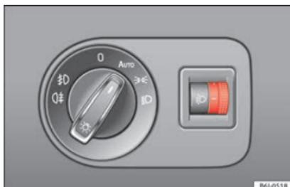
**Fig. 127** Plancia portastrumenti: Correttore assetto fari
