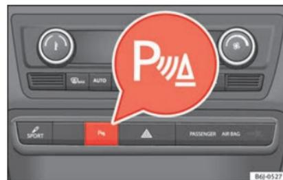
Fig. 165 Consola centrale: tasto dell'assistenza per il parcheggio.
