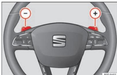
**Fig. 160** Volante con leve per il cambio automatico.
