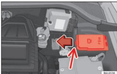
Fig. 57 Nel vano motore: coperchio della scatola dei fusibili.
