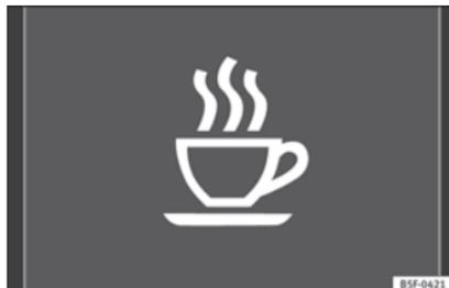
**Fig. 163** Sul display del quadro strumenti: simbolo del riconoscimento della stanchezza del conducente.
