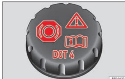
Fig. 54 Vano motore: tappo del serbatoio del liquido dei freni.
