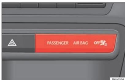
**Fig. 43** Spia per la disattivazione dell'airbag del passeggero.
