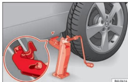
**Fig. 66** Posizionamento del cric.
