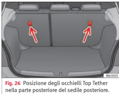
**Fig. 26** Posizione degli occhielli Top Tether nella parte posteriore del sedile posteriore.
