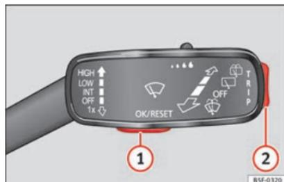
Fig. 36 Leva dell'impianto tergicristalli e tasti di controllo.
