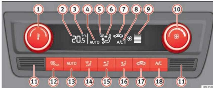
**Fig. 47** Sulla consola centrale: comandi del Climatronic.
