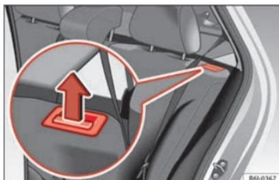
**Fig. 136** Tasto di sblocco dello schienale del sedile posteriore.
