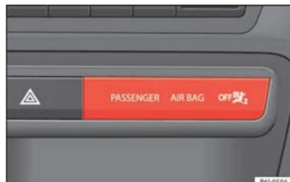
Fig. 85 Sulla parte centrale del quadro strumenti: spia della disattivazione degli airbag del passeggero anteriore.
