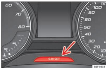
**Fig. 114** Quadro strumenti: contachilometri e tasto di azzeramento.
