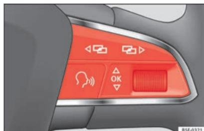
Fig. 37 Lato destro del volante multifunzionale: tasti di controllo.
