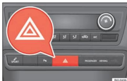
Fig. 31 Plancia portastrumenti: interruttore lampeggio di emergenza.
