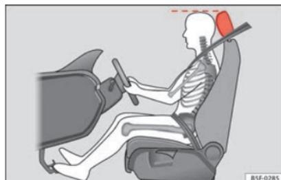
**Fig. 75** Corretto posizionamento del poggiatesta del conducente.
