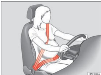
**Fig. 83** Posizione del nastro della cintura di sicurezza per donne in stato di gravidanza.
