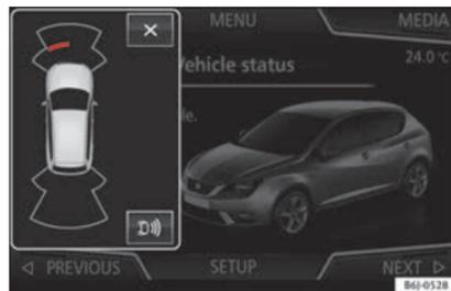
**Fig. 166** Indicazione in miniatura dell'attivazione automatica
