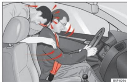
**Fig. 81** Se non indossa la cintura, il passeggero seduto sul sedile posteriore viene scagliato in avanti, colpendo il conducente (che invece indossa la cintura)
