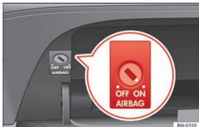
Fig. 18 Commutatore dell'airbag frontale del passeggero.
