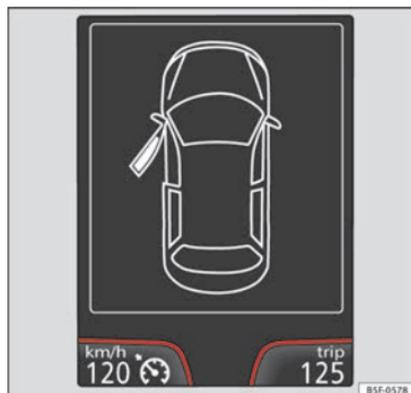
**Fig. 42** Sul display del quadro strumenti: indicazione di porte aperte.
