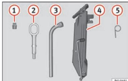
**Fig. 60** Nel bagagliaio, sotto la copertura del piano di carico: attrezzi di bordo.
