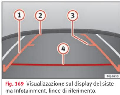
Fig. 169 Visualizzazione sul display del sistema Infotainment. linee di riferimento.
