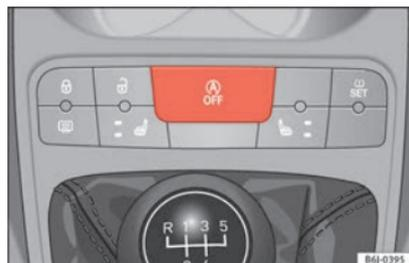
Fig. 162 Dettaglio del pulsante della modalità Start-Stop.
