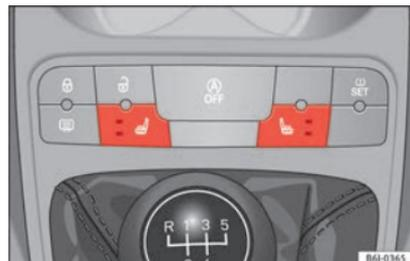
Fig. 134 Interruttore per il riscaldamento dei sedili anteriori.
