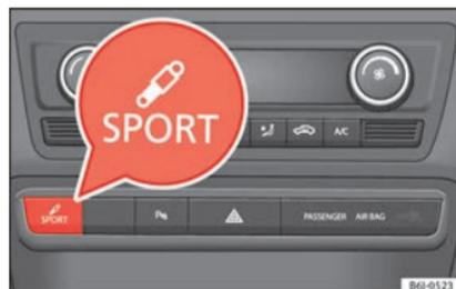
**Fig. 171** Sulla console centrale: tasto per regolare il sistema "SEAT Drive Profile"
