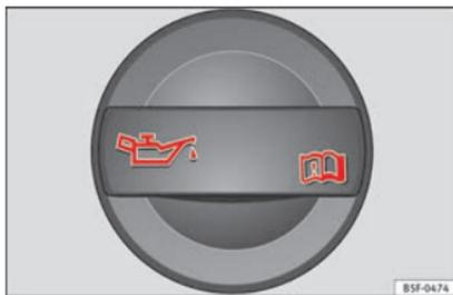
Fig. 52 Vano motore: tappo del bocchettone di rifornimento dell'olio motore.
