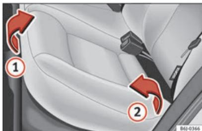
**Fig. 135** Relever la banquette arrière.
