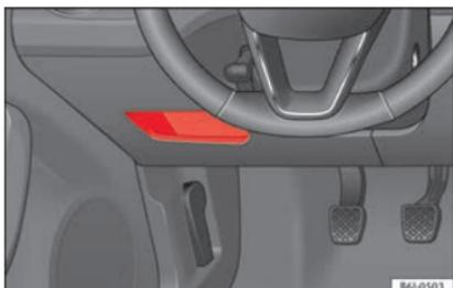
Fig. 56 Sur le tableau de bord côté conducteur : cache du boîtier de fusibles.
