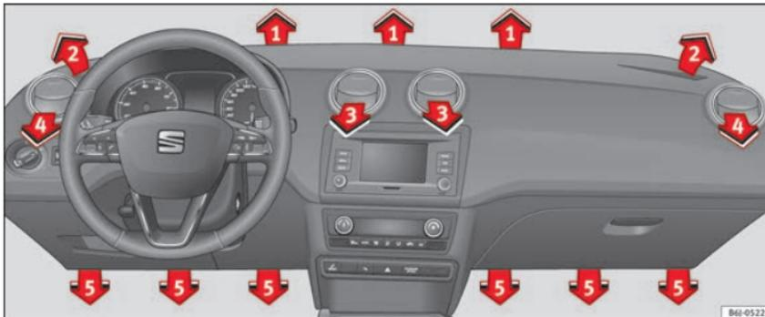
Fig. 152 Diffuseurs d'air.
