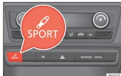
Fig. 171 Dans la console centrale : touche pour régler le système « SEAT Drive Profile »
