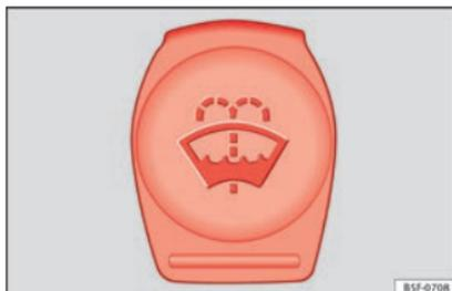
**Fig. 55** Dans le compartiment moteur : bouchon du réservoir de liquide lave-glace.
