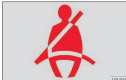
Fig. 78 Témoin d'avertissement sur le tableau de bord.
