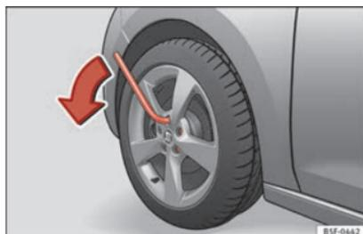
**Fig. 64** Roue : desserrer les vis de roue.
