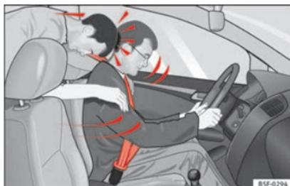
Fig. 81 L'occupant de la banquette arrière non attaché est projeté en avant et vient heurter le conducteur attaché.
