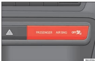
**Fig. 43** Témoin de désactivation de l'airbag du passager.
