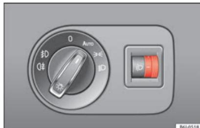
**Fig. 127** Planche de bord : dispositif de réglage de la portée des phares.
