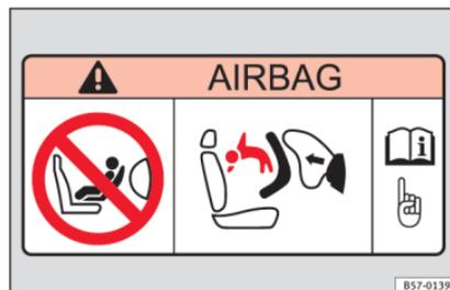
Fig. 22 Pare-soleil du côté du passager avant : autocollant de l'airbag.
