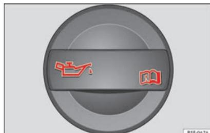
Fig. 52 Dans le compartiment-moteur : bouchon de l'orifice de remplissage d'huile moteur.
