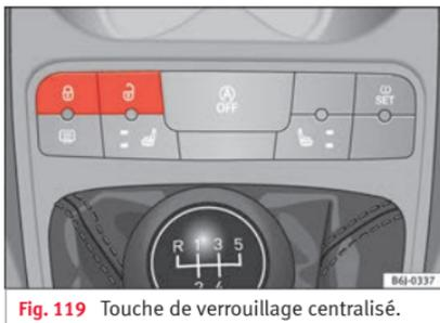
Fig. 119 Touche de verrouillage centralisé.
