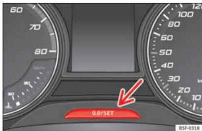
Fig. 114 Combiné d'instruments : compteur kilométrique et touche de remise à zéro.
