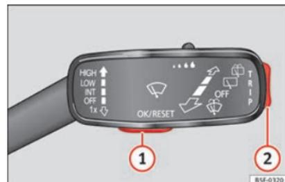
Fig. 36 Levier d'essuie-glace : touches de contrôle.
