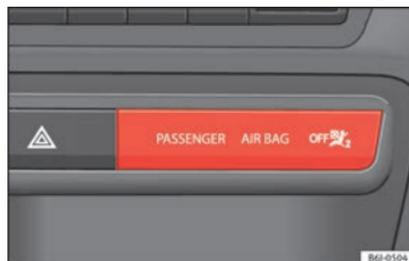
**Fig. 85** Sur le tableau de bord, au centre : témoin de désactivation de l'airbag du passager avant.
