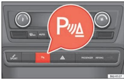
**Fig. 165** Console centrale : touche de l'aide au stationnement.
