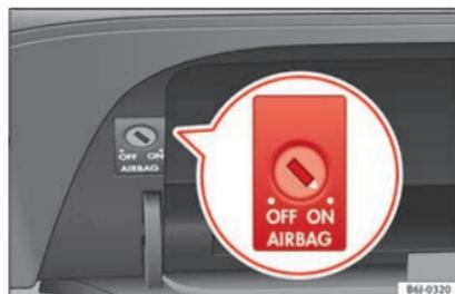
**Fig. 84** Dans la boîte à gants se trouve commande à clé pour activer et désactiver l'airbag du passager avant.
