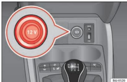
Fig. 146 Prise de courant avant.
