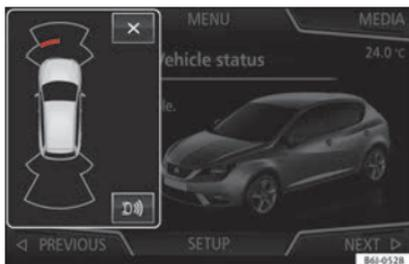
**Fig. 166** Indication en miniature de l'activation automatique
