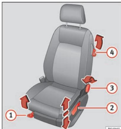
**Fig. 10** Sièges avant : réglage manuel du siège.
