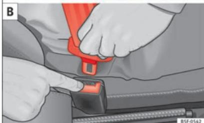
**Fig. 12** Placer et retirer le pêne de verrouillage de la ceinture de sécurité.
