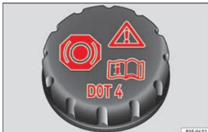
**Fig. 54** Compartiment-moteur : bouchon du réservoir du liquide de frein.
