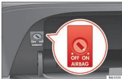
**Fig. 18** Commande de l'airbag frontal du passager.
