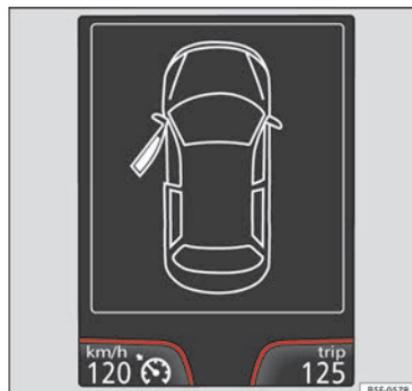
**Fig. 42** Sur l'écran du combiné d'instruments : indicateur de portes ouvertes.
