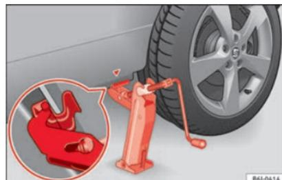
**Fig. 66** Mise en place du cric.
