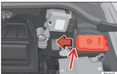
Fig. 57 Dans le compartiment moteur : cache du boîtier de fusibles.
