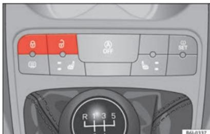
Fig. 2 Console centrale : touches de verrouillage centralisé.
