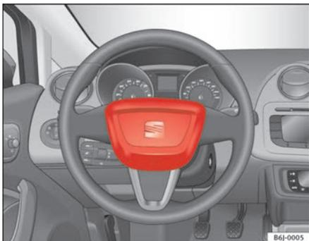
**Fig. 16** Airbag do condutor no volante
