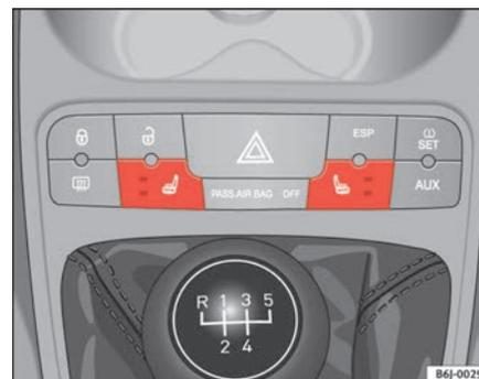
**Fig. 68** Interruptor do aquecimento dos bancos dianteiros
