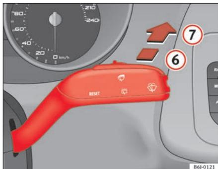
**Fig. 61** Alavanca do limpa/lava-vidros: limpa-vidros traseiro
