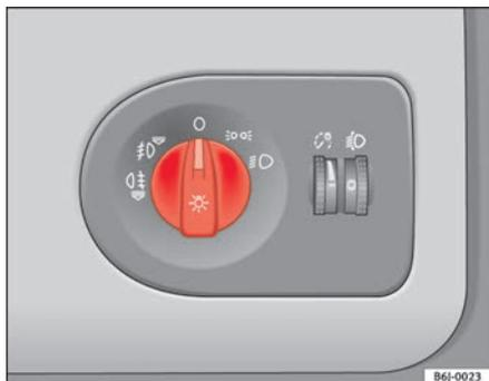
Fig. 50 Pormenor do painel de instrumentos: comando das luzes, faróis de nevoeiro e a luz traseira de nevoeiro
