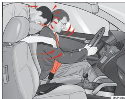
**Fig. 9** O passageiro do banco traseiro que não tiver colocado o cinto de segurança é projectado em frente, para cima do condutor que tem o cinto colocado.
