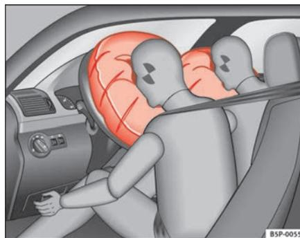
**Fig. 18 Airbags frontais inflados**
