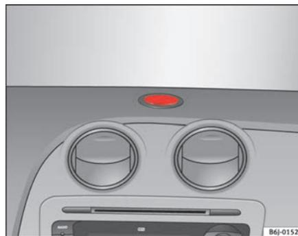
Fig. 73 Suporte para navegador no painel.
