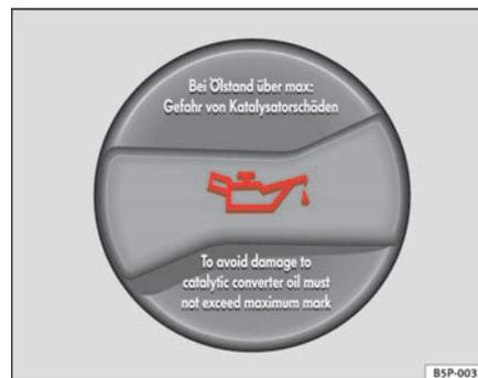
**Fig. 126 Tampa do bocal de enchimento do óleo do motor no compartimento do motor**
