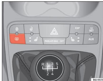
Fig. 53 Consola central: interruptor do desembaçador traseiro
