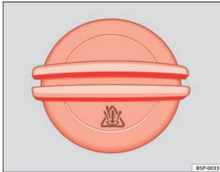
Fig. 127 Tampa do reservatório de expansão do líquido de refrigeração no compartimento do motor
