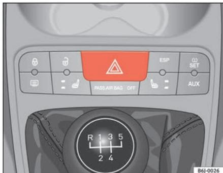
Fig. 54 Consola central: interruptor das luzes de emergência
