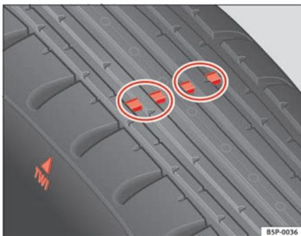
**Fig. 132** Indicadores de desgaste no perfil do pneu
