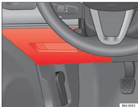
**Fig. 140** Fusíveis no painel de instrumentos
