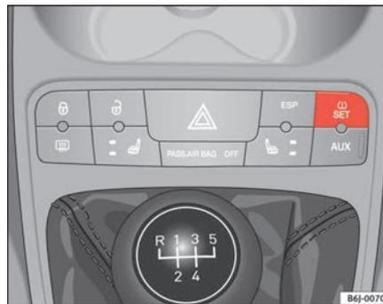
Fig. 37 Consola central: tecla do sistema de controlo dos pneus
