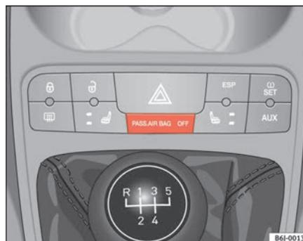
Fig. 24 Luz avisadora da desactivação do airbag do acompanhante
