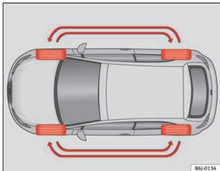
**Fig. 133** Schema per lo scambio delle ruote
