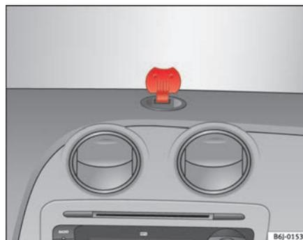
**Fig. 74** Supporto con coperchio aperto per la collocazione del navigatore.
