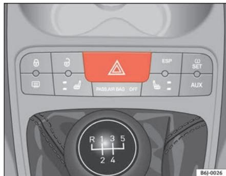
**Fig. 54 Console centrale: interruttore lampeggio di emergenza**
