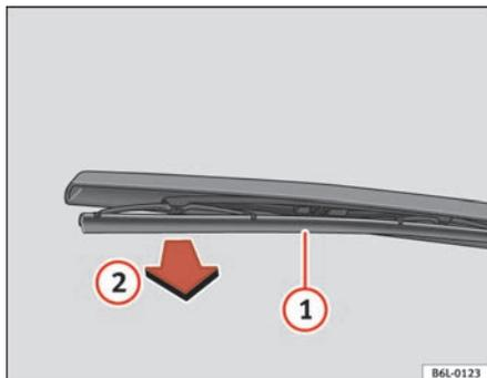
**Fig. 130 Sostituzione della spazzola del tergilunotto**
