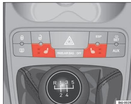
**Fig. 68** Interruttore per il riscaldamento dei sedili anteriori
