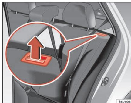
Fig. 70 Tasto di sbloccaggio dello schienale del sedile posteriore
