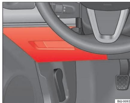
**Fig. 140** Fusibili sulla plancia degli strumenti
