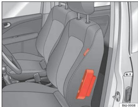
**Fig. 19** Airbag laterale all'interno del sedile del conducente
