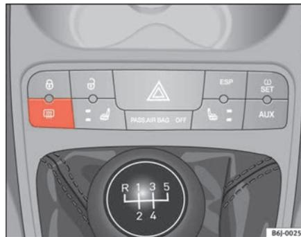
**Fig. 53** Console centrale: interruttore del lunotto termico
