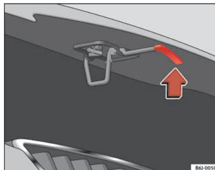
Fig. 123 Supporto cofano del vano motore
