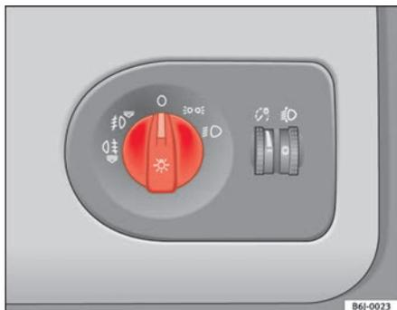
Fig. 50 Dettaglio della plancia portastrumenti: interruttore luci, fari fendinebbia e retronebbia
