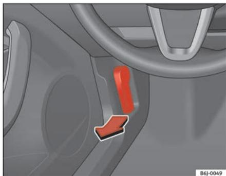
Fig. 122 Leva apertura cofano motore
