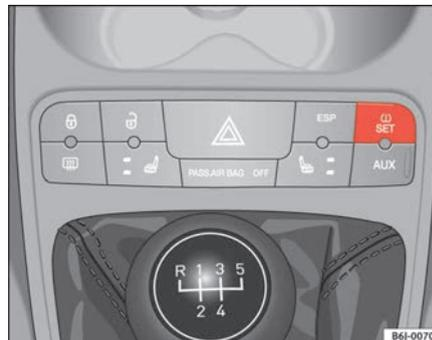
Fig. 37 Console centrale: tasto del sistema controllo dei pneumatici
