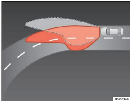
**Fig. 52** Illuminazione della curva con fari autodirezionabili
