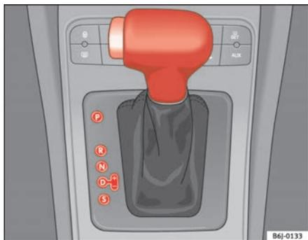
Fig. 96 Cambio automatico.
