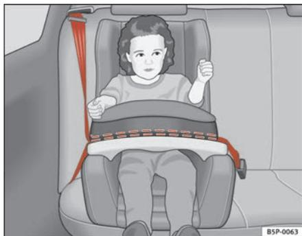
**Fig. 26** Seggiolino del gruppo 1 montato sul sedile posteriore; il bambino siede rivolto verso il senso di marcia
