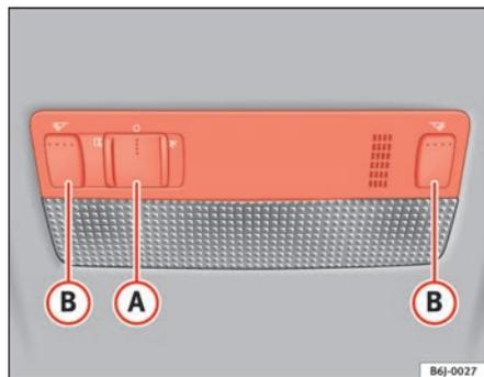
Fig. 57 Luce di lettura anteriore
