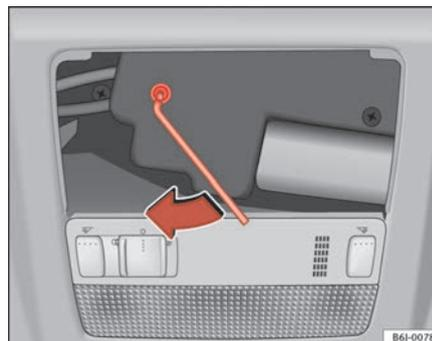
**Fig. 49** Azionamento di emergenza del tettuccio panoramico/ sollevabile ▶
