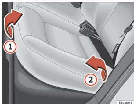
Fig. 69 Sollevare l'elemento orizzontale del sedile posteriore
