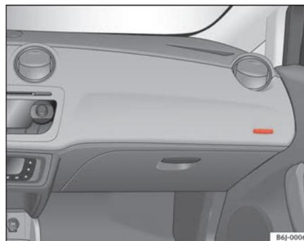
**Fig. 17** Airbag del passeggero anteriore sulla plancia portastrumenti
