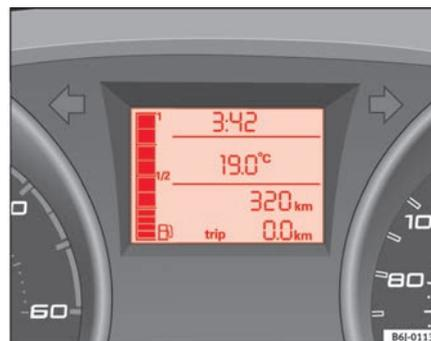
Fig. 31 Indicatore del livello del serbatoio carburante
