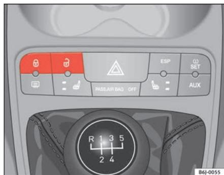
Fig. 40 Interruttore della chiusura centralizzata
