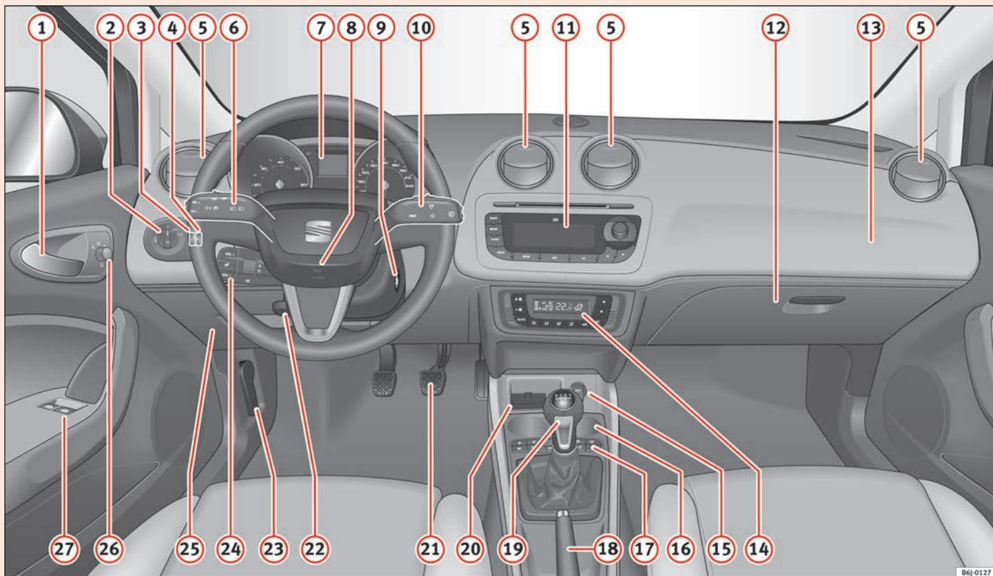
Fig. 29 Plancia portastrumenti
