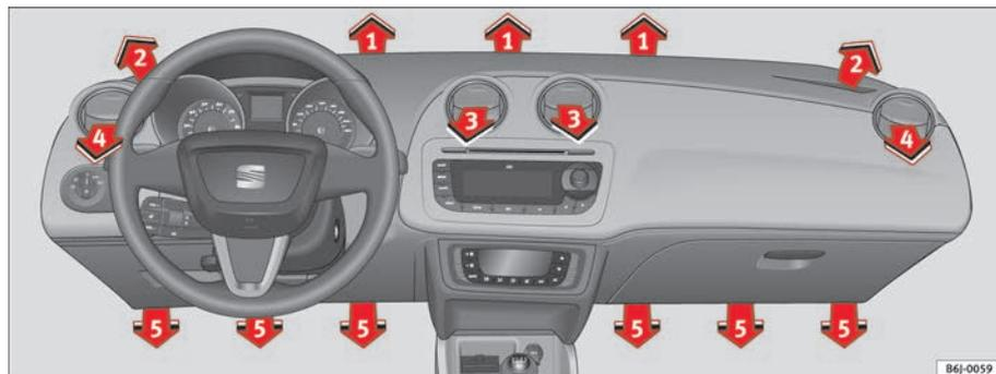
Fig. 87 Bocchette di ventilazione
