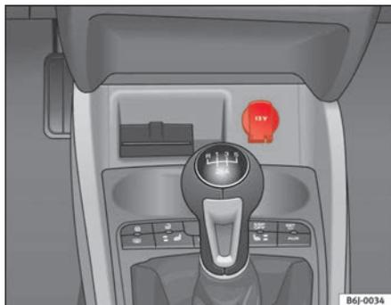
Fig. 81 Presa elettrica anteriore
