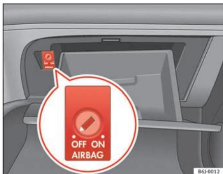
Fig. 23 Cassetto ripostiglio: interruttore a chiave per la disattivazione e la riattivazione degli airbag del passeggero
