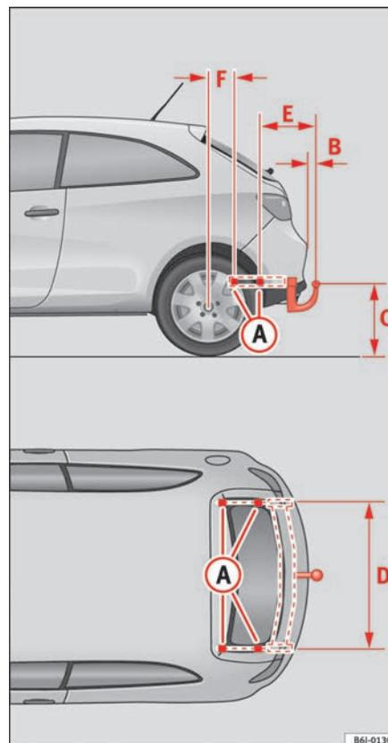
Fig. 120 Punti di ancoraggio per il gancio di traino
