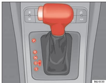
Fig. 99 Cambio automatico.
