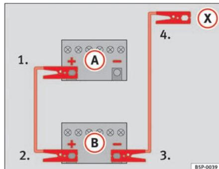
Fig. 163 Schema per il collegamento dei cavi per l'avviamento di emergenza
