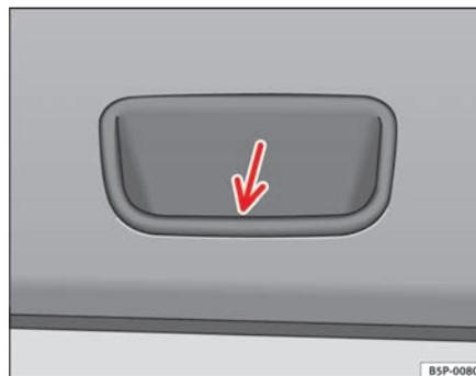
Fig. 45 Dettaglio del rivestimento interno del portellone posteriore: maniglia di presa ad incavo
