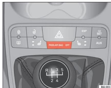
Fig. 24 Spia della disattivazione degli airbag del passeggero anteriore
