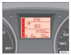
Fig. 35 Service interval display
