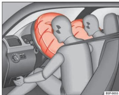
**Fig. 18 Airbags frontais insuflados**
