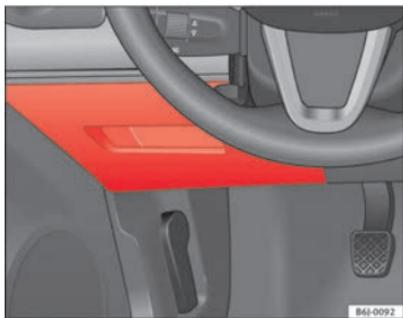
**Fig. 129** Fusíveis no painel de instrumentos
