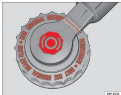
**Fig. 120** Tampão do reservatório do líquido de travões no compartimento do motor
