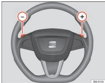
Fig. 101 Volante com patilhas para a caixa de velocidades automática
