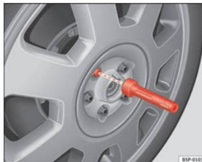
Fig. 127 Substituição de pneu: Ferramenta com sextavado interior para rodar os parafusos
