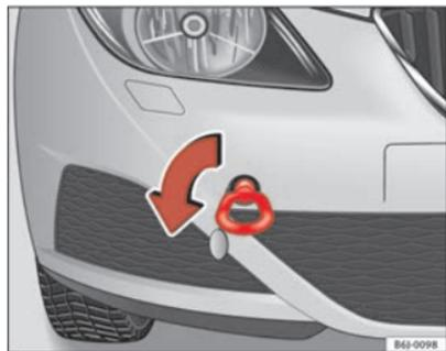
Fig. 152 Enroscamento da argola de reboque na parte dianteira do veículo
