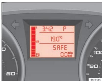
Fig. 35 Visor digital: Posição da alavanca da caixa de velocidades automática
