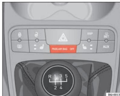
Fig. 24 Luz avisadora da desactivação do airbag do acompanhante
