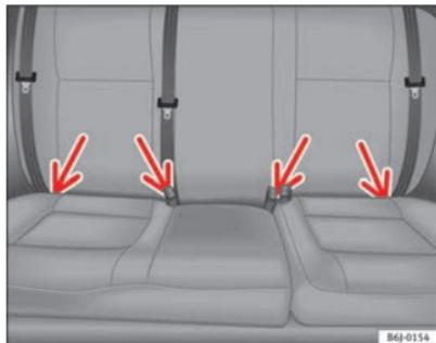
**Fig. 28 Anéis de fixação ISOFIX**
