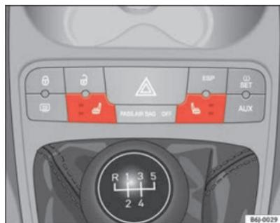
**Fig. 69** Comutador do aquecimento dos bancos dianteiros
