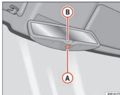
Fig. 63 Retrovisor interior com regulação automática para posição de anti-encandeamento. ▶
