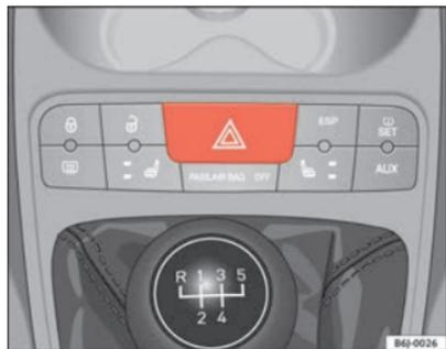
Fig. 55 Consola central: comutador das luzes de emergência
