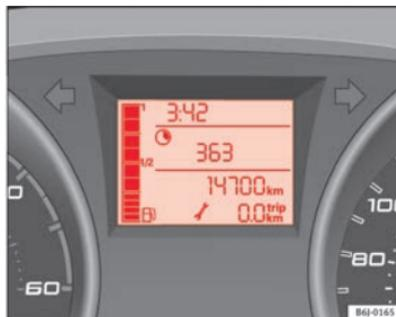
Fig. 36 Indicador de intervalos de manutenção
