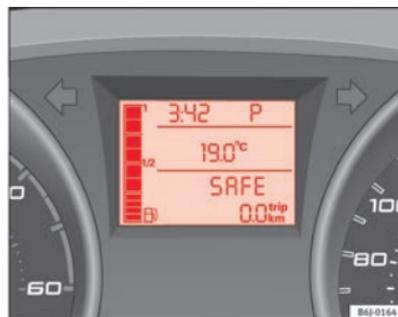
Fig. 102 Caixa de velocidades automática: Visor do painel de instrumentos
