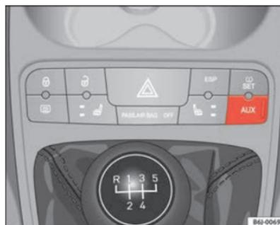
Fig. 83 Ligação AUX na consola central (em função do equipamento)
