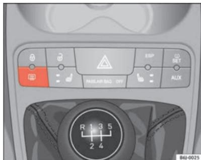
Fig. 54 Consola central: comutador do desembaçador do vidro traseiro
