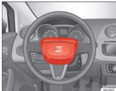
**Fig. 16** Airbag do condutor no volante
