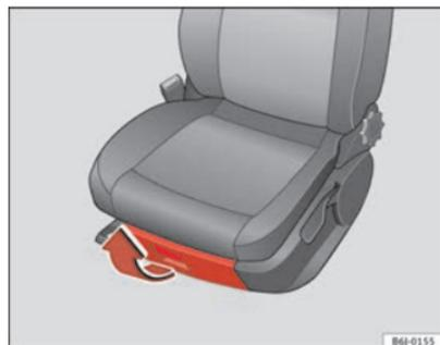
Fig. 76 Rangement sous le siège avant droit
