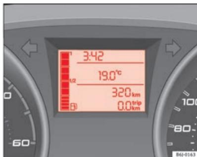
Fig. 31 Indicateur de niveau du réservoir de carburant
