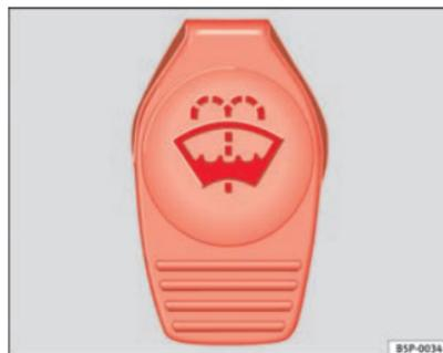
Fig. 117 Dans le compartiment-moteur : bouchon du réservoir de lave-glace
