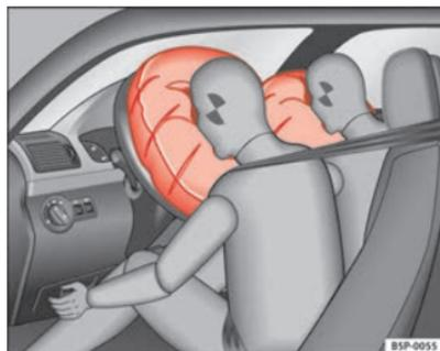
**Fig. 18 Schéma de principe : airbags frontaux gonflés**
