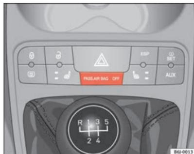
Fig. 24 Témoin de désactivation de l'airbag du passager
