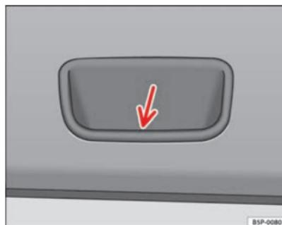
Fig. 46 Détail de la garniture intérieure du hayon arrière : cavité pour tirer
