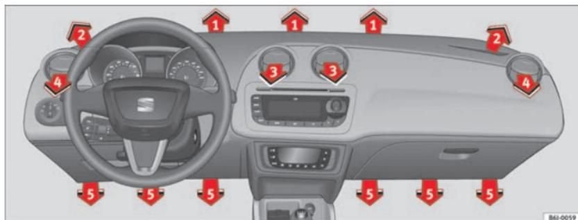
Fig. 88 Diffuseur d'air
