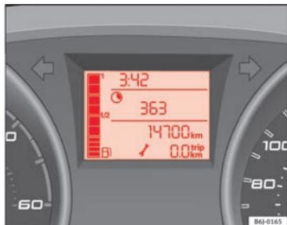
Fig. 36 Indicateur de fréquence d'entretien
