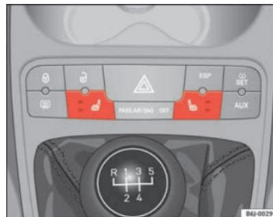
Fig. 69 Contacteur du chauffage des sièges avant
