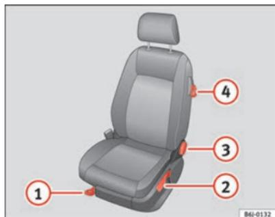
Fig. 68 Éléments de commande du siège avant gauche
