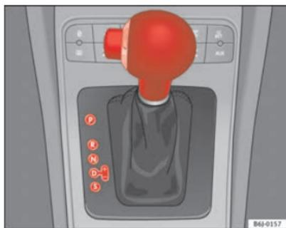
Fig. 100 Changement de vitesses avec la commande Tiptronic
