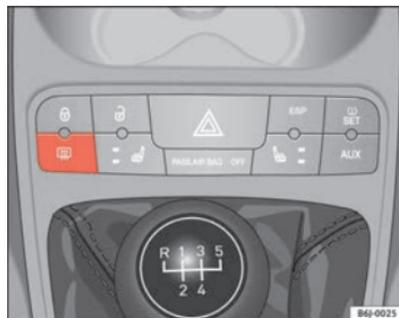
Fig. 54 Console centrale : contacteur de dégivrage de lunette arrière
