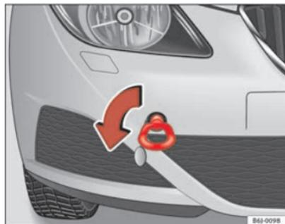
Fig. 152 Vissage de l'œillet de remorquage avant
