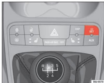
Fig. 38 Console centrale : touche du système de contrôle des pneus
