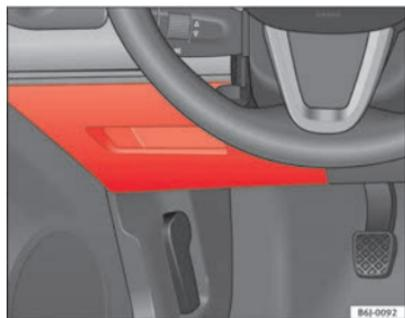
Fig. 129 Fusibles dans le tableau de bord
