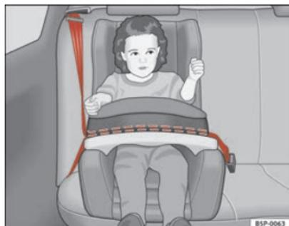
**Fig. 26** Siège pour enfant du groupe 1 monté dans le sens de la marche sur la banquette arrière.
