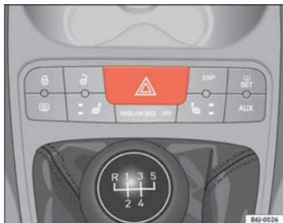
Fig.55 Console centrale : commande du signal de détresse
