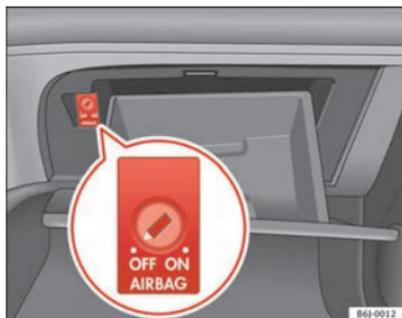
Fig. 23 Dans la boîte à gants se trouve commande à clé pour activer et désactiver les airbags côté passager avant
