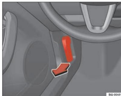
**Fig. 111** Levier d'ouverture du capot-moteur
