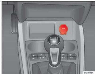
Fig. 82 Prise de courant avant
