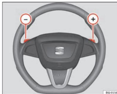
Fig. 101 Volant avec commandes pour boîte de vitesses automatique
