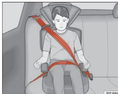
**Fig. 27** Siège pour enfants monté dans le sens de la marche sur la banquette arrière.
