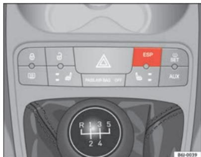
Abb. 92 Ansicht der Mittelkonsole: ESP-Taste
