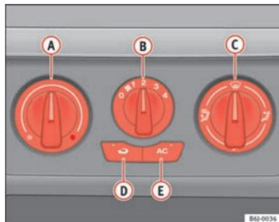
Abb. 89 In der Instrumententafel: Bedienelemente Klimaanlage
