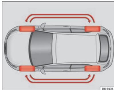
**Abb. 121** Schema für das Tauschen der Räder
