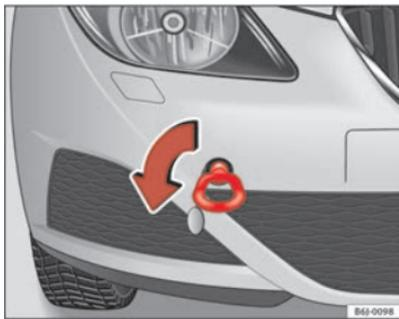
Abb. 151 Einschrauben der Abschleppöse vorne am Fahrzeug
