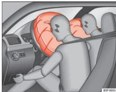
Abb. 18 Aufgeblasene Frontairbags
