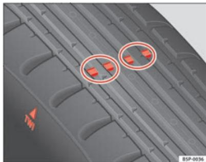
**Abb. 120** Prinzipdarstellung Reifenprofil: Verschleißanzeiger
