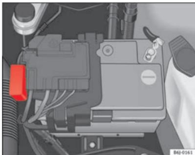
Abb. 129 Sicherungen im Motorraum
