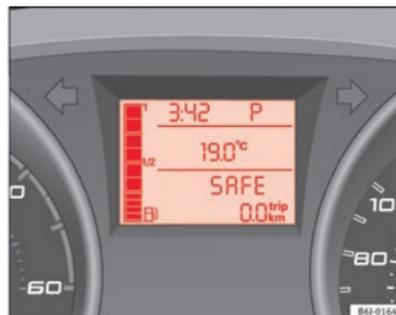
Abb. 97 Automatikgetriebe: Display des Kombiinstrumentes
