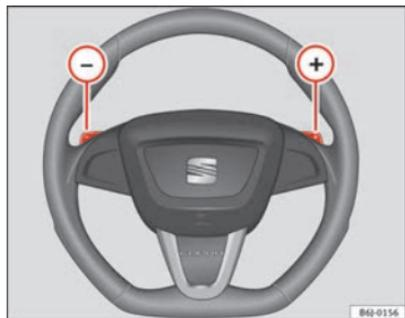
Abb. 100 Lenkrad mit Schaltwippen für Automatikgetriebe
