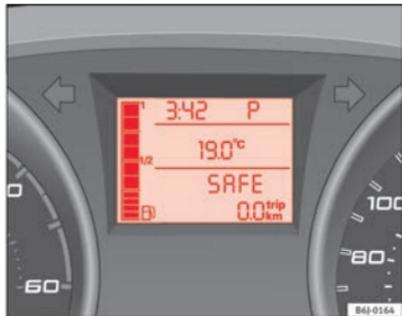
Abb. 101 Automatikgetriebe: Display des Kombiinstrumentes
