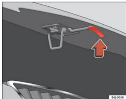
Abb. 111 Stütze Motorraumklappe
