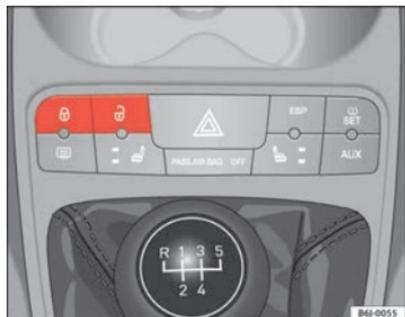
Abb. 39 Taster für Zentralverriegelung
