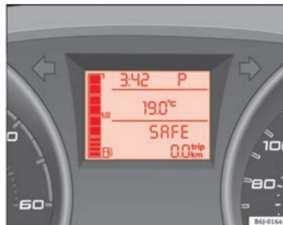
**Abb. 33** Display: Wählhebelstellung des Automatikgetriebes
