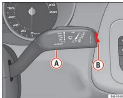
Abb. 32 Scheibenwischer- und Scheibenwaschhebel: Taste A und Wipptaste B
