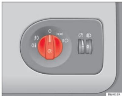
Abb. 49 Ausschnitt aus der Instrumententafel: Schalter für die Leuchten, Nebelscheinwerfer und Nebelschlussleuchte
