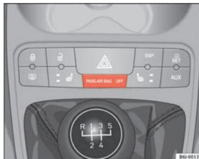
Abb. 22 Kontrollleuchte für Abschaltung der Beifahrerairbags
