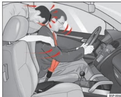
**Abb. 9** Der nicht angegurte Mitfahrer auf dem Rücksitz schleudert nach vorne auf den angegurten Fahrer.
