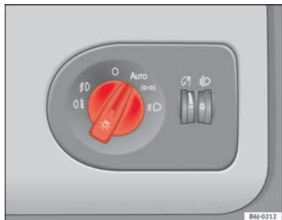
Abb. 50 Automatisches Fahrlicht
