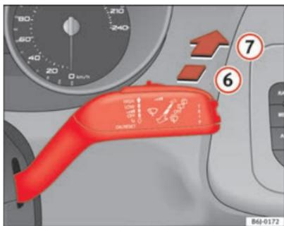
Abb. 61 Scheibenwischer- und Scheibenwaschhebel: Heckscheibenwischer
