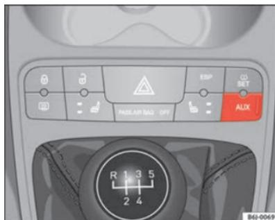
Abb. 82 AUX-Anschluss an der Mittelkonsole (ausstattungsabhängig)
