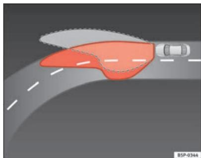
Abb. 52 Beleuchtung der Kurve mit automatisch gerichteten Scheinwerfern
