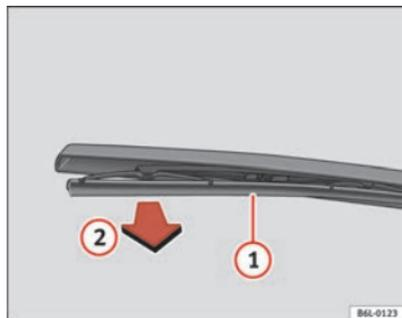
**Abb. 118 Scheibenwischerblatt hinten auswechseln**
