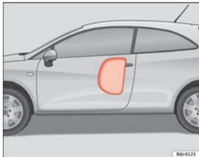
Abb. 20 Aufgeblasener Seitenairbag auf der linken Fahrzeugseite
