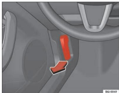
Abb. 110 Öffnungshebel für Motorraumklappe
