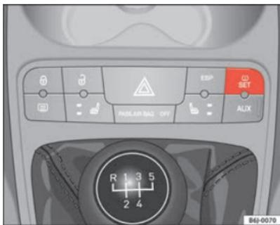
Abb. 36 Mittelkonsole: Taste für die Reifen-Kontroll-Anzeige
