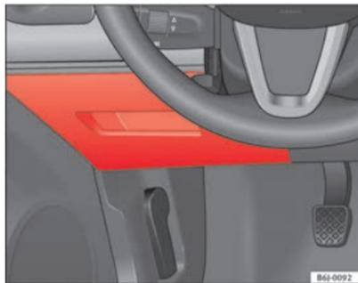
**Abb. 128 Sicherungen in der Instrumententafel**
