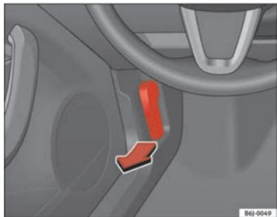
Fig. 115 Manípulo de abertura do capot do motor
