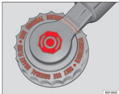
**Fig. 123** Tampão do reservatório do líquido dos travões no compartimento do motor
