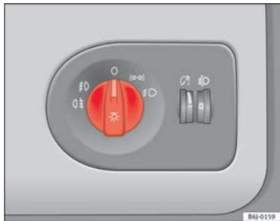
Fig. 51 Pormenor do painel de instrumentos: comando das luzes, faróis de nevoeiro e luz de nevoeiro traseira
