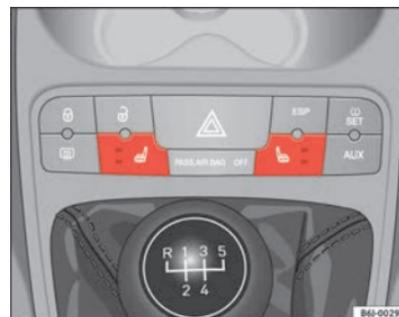
**Fig. 70** Comutador do aquecimento dos bancos dianteiros
