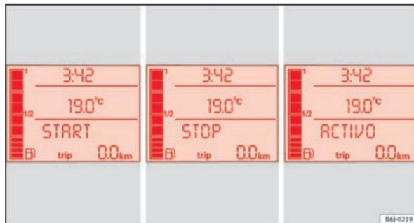
Fig. 97 Indicação no visor do painel de instrumentos durante o funcionamento Start-Stop.
