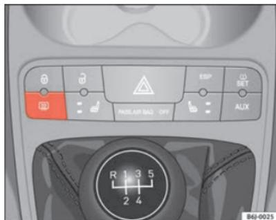
Fig. 55 Consola central: comutador do desembaciador do vidro traseiro
