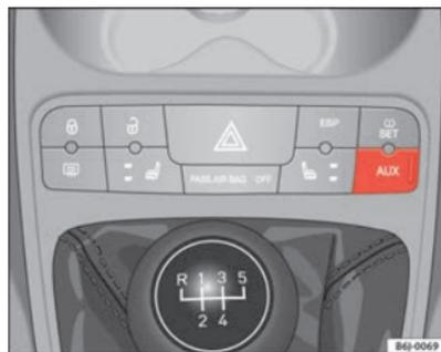
Fig. 84 Ligação AUX na consola central (em função do equipamento)
