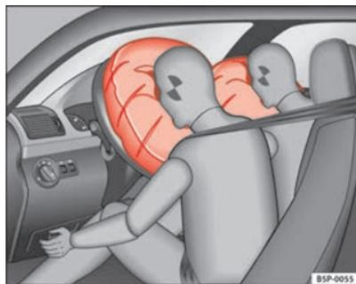
**Fig. 18 Airbags frontais insuflados**
