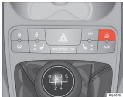
Fig. 38 Consola central: botão do sistema de controlo dos pneus
