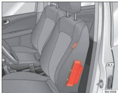
**Fig. 19** Airbag lateral no banco do condutor
