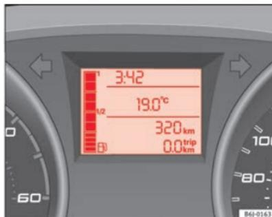
Fig. 31 Indicador do nível do depósito de combustível
