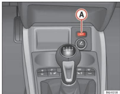
Fig. 96 Pormenor do botão do funcionamento Start-Stop.
