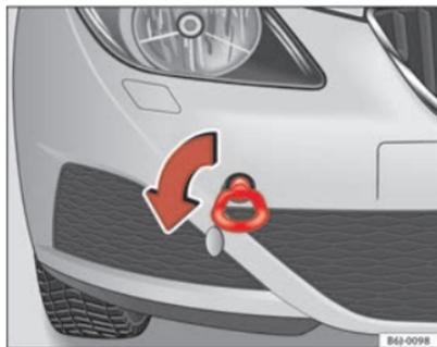
Fig. 156 Enrocamento da argola de reboque na parte dianteira do veículo
