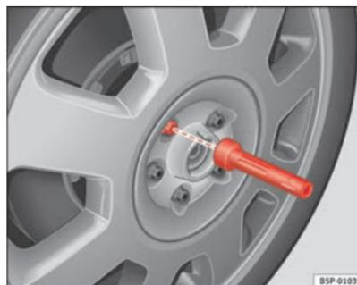
**Fig. 130** Substituição de pneu: Ferramenta com sextavado interior para rodar os parafusos
