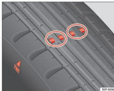
Fig. 124 Indicadores de desgaste no perfil do pneu
