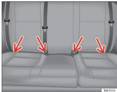
Fig. 26 Anéis de fixação ISOFIX
