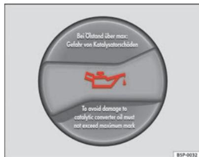
**Fig. 118 Tampa do bocal de enchimento do óleo do motor no compartimento do motor**
