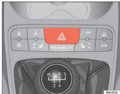
Fig. 56 Consola central: comutador das luzes de emergência
