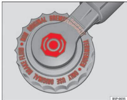
Fig. 129 Dans le compartiment moteur : bouchon du réservoir de liquide de frein
