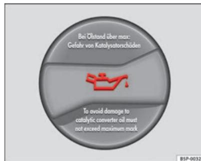
**Fig. 124** Dans le compartiment moteur : bouchon de l'orifice de remplissage d'huile moteur
