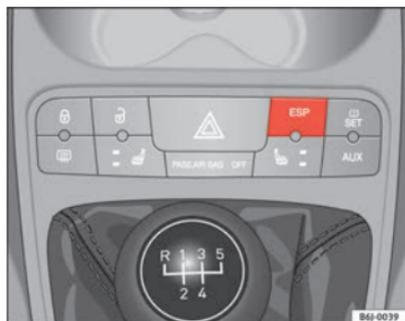
Fig. 96 Détail de la console centrale : touche ESP
