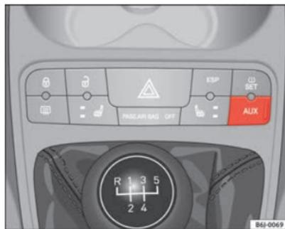
Fig. 86 Connexion AUX sur console centrale (en fonction de l'équipement)
