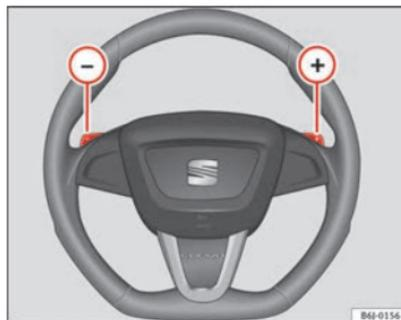
Fig. 107 Volant avec commandes pour boîte de vitesses automatique
