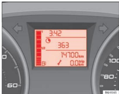
Fig. 37 Indicateur de fréquence d'entretien
