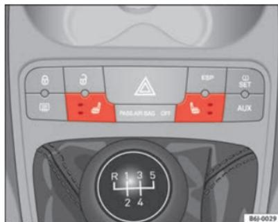
**Fig. 72** Contacteur du chauffage des sièges avant
