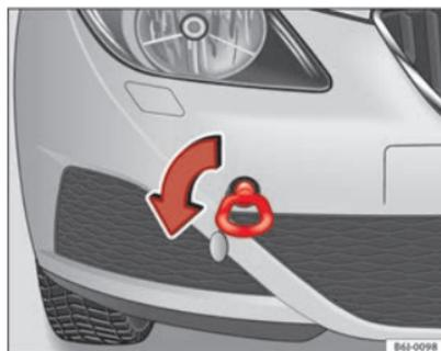
Fig. 161 Vissage de l'œillet de remorquage avant
