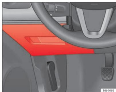
Fig. 137 Fusibles dans la planche de bord
