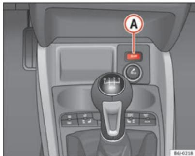
Fig. 99 Détail du bouton du fonctionnement Start-Stop.
