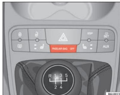
Fig. 22 Témoin de désactivation de l'airbag du passager
