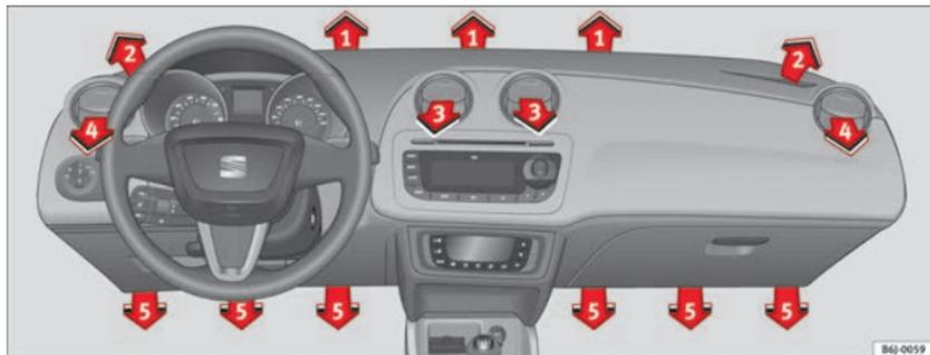
Fig. 91 Diffuseur d'air
