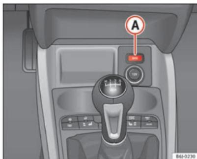
Fig. 98 Console centrale : contacteur de contrôle du système de gaz.
