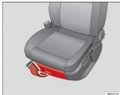
Fig. 79 Rangement sous le siège avant droit
