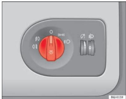
Fig. 53 Détail de la planche de bord : commande des feux, des projecteurs antibrouillard et du feu arrière de brouillard
