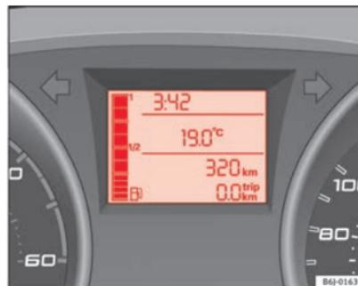
Fig. 32 Indicateur de niveau du réservoir de carburant
