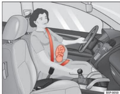
Fig. 14 Ajustement de la sangle recommandé pour les femmes enceintes
