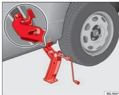
Fig. 135 Mise en place du cric
