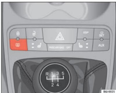
Fig. 57 Console centrale : contacteur de dégivrage de lunette arrière
