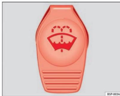
Fig. 126 Dans le compartiment moteur : bouchon du réservoir de lave-glace
