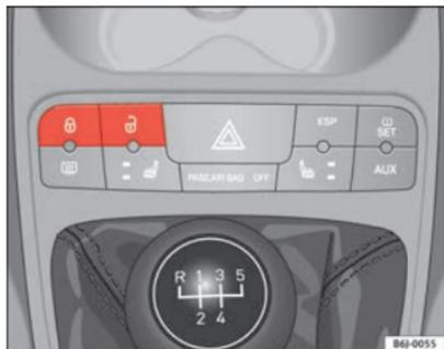
Fig. 43 Touche de verrouillage centralisé
