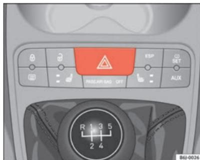
Fig. 58 Console centrale : commande des feux de détresse
