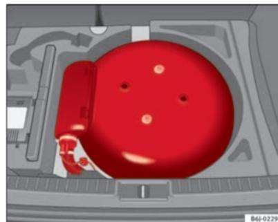
Fig. 119 Réservoir de GPL dans le cuvelage de la roue de secours.
