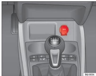
Fig. 85 Prise de courant avant
