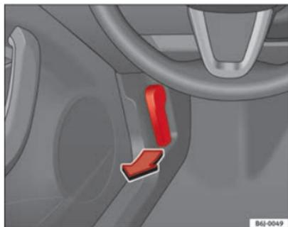
Fig. 121 Levier d'ouverture du capot-moteur
