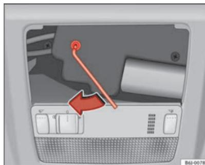
**Fig. 52** Accionamiento de emergencia techo panorámico/deflector
