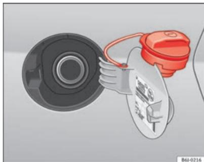
**Fig. 117 Tapa del depósito abierta**
