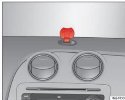
Fig. 78 Soporte con tapa abierta para colocación del navegador. ►
