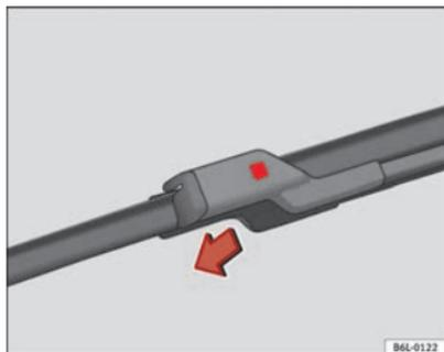
Fig. 127 Cambio escobilla limpiaparabrisas
