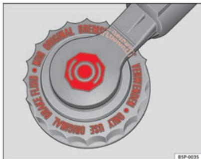
Fig. 129 Tapón del depósito del líquido de frenos en el vano motor
