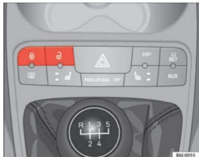
Fig. 43 Pulsador del cierre centralizado
