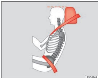
**Fig. 4 Apoyacabezas ajustado correctamente visto lateralmente**
