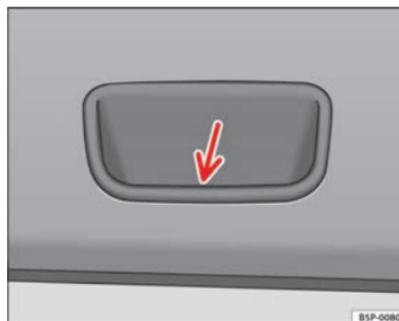
Fig. 48 Detalle del guardacostas interior del portón trasero: cavidad para tirar
