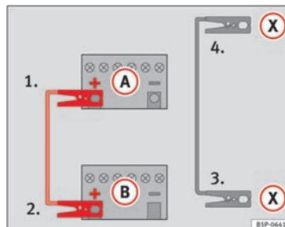
Fig. 160 Esquema para conectar los cables de emergencia en el caso de que el vehículo que suministra la corriente disponga del sistema Start-Stop: batería descargada (A) y batería que suministra la corriente (B).
