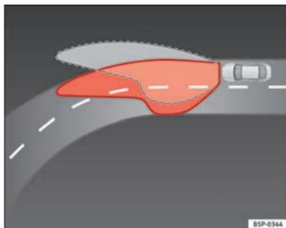
Fig. 56 Iluminación de la curva con faros autodireccionables
