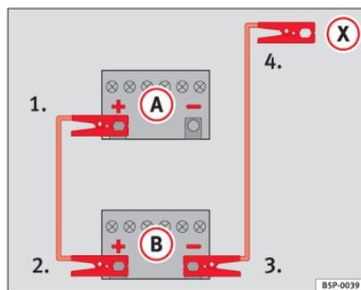
Fig. 159 Esquema para conectar los cables de emergencia en el caso de que el vehículo que suministra la corriente no disponga del sistema Start-Stop: batería descargada (A) y batería que suministra la corriente (B).
