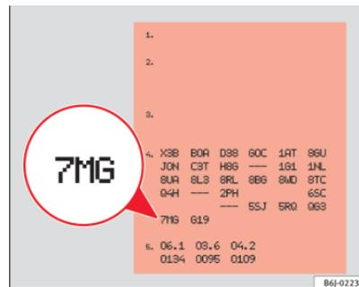
Fig. 115 Portadatos del vehículo en reverso de la tapa del Programa de Mantenimiento
