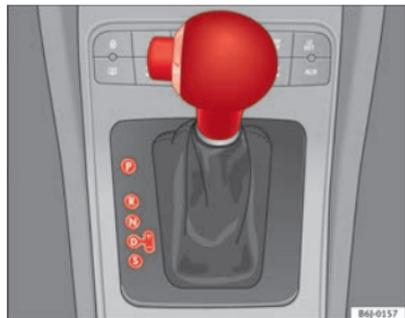
Fig. 106 Cambiar con tiptronic
