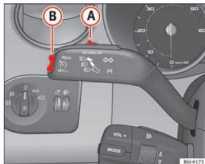
Fig. 114 Palanca de intermitentes y de luz de carretera: mando y tecla basculante para el regulador de velocidad
