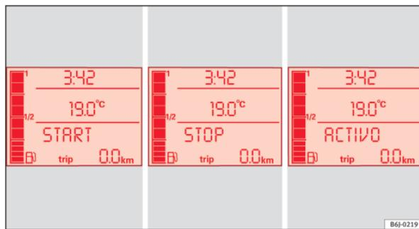
Fig. 100 Indicación en la pantalla del cuadro de instrumentos durante el funcionamiento Start-Stop.
