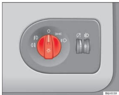
Fig. 53 Detalle del tablero de instrumentos: mando de las luces, faros antiniebla y luz trasera antiniebla
