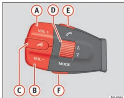
Fig. 42 Control Audio+ teléfono
