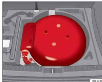
Fig. 119 Depósito de GLP en la cavidad de la rueda de repuesto.
