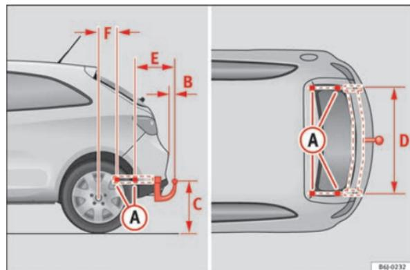
Fig. 116 Puntos de fijación del dispositivo de remolque
