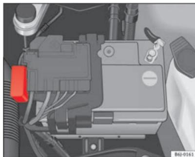
**Fig. 138** Fusibles en el compartimiento motor
