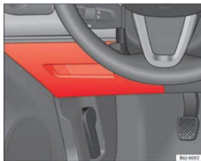
**Fig. 137 Fusibles en tablero de instrumentos**
