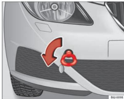
Fig. 161 Atomillado de la argolla de remolque en la parte delantera del vehículo
