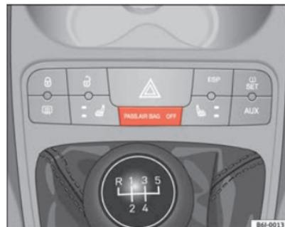
Fig. 22 Testigo de control de la desactivación del airbag del acompañante
