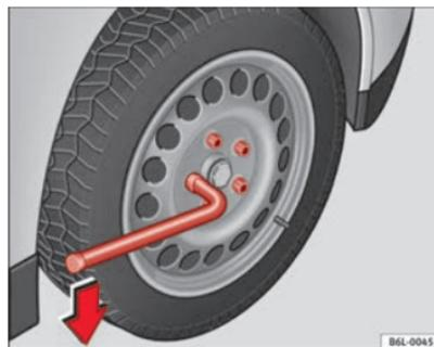
Fig. 133 Cambio de rueda: aflojar los tornillos de rueda
