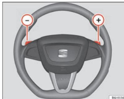
Fig. 107 Volante con levas para cambio automático
