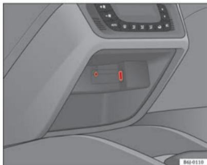
Fig. 87 Conexión entrada AUX / USB\* (en función del equipamiento)
