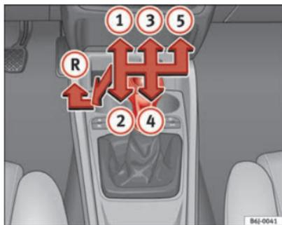
Fig. 101 Consola Central: esquema de un cambio manual de 5 marchas
