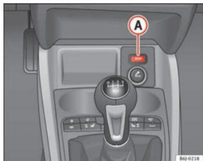
Fig. 99 Detalle del pulsador del funcionamiento Start-Stop.
