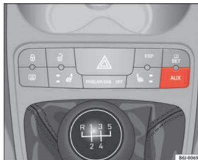
Fig. 86 Conexión AUX en consola central (en función del equipamiento)
