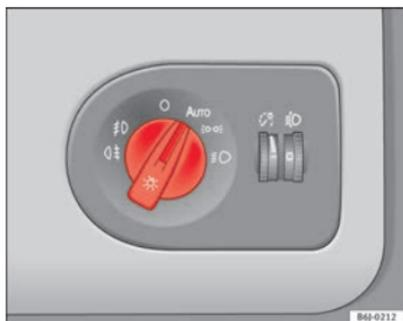
Fig. 54 Encendido automático de luces
