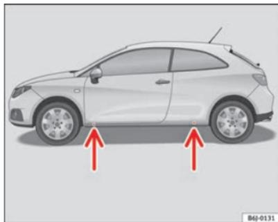
Fig. 134 Puntos de apoyo del gato
