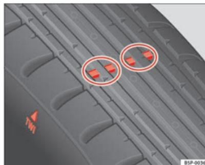
Fig. 130 Indicadores de desgaste del perfil del neumático
