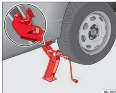
Fig. 135 Colocación del gato
