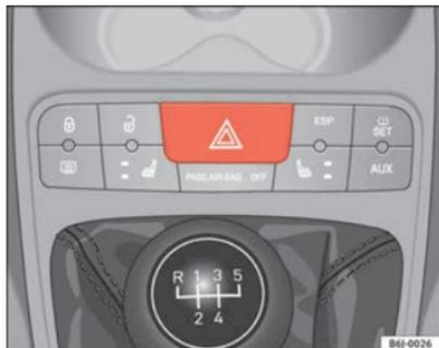
Fig. 58 Consola central: conmutador de los intermitentes de emergencia
