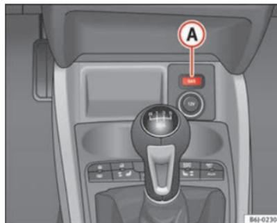
Fig. 98 Consola central: conmutador de control del sistema de gas.
