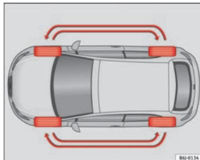
Fig. 131 Esquema para el cambio de ruedas
