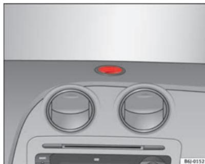
Abb. 77 Halterung für Navigationsgerät an Instrumententafel
