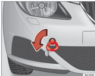
Abb. 161 Einschrauben der Abschleppöse vorne am Fahrzeug
