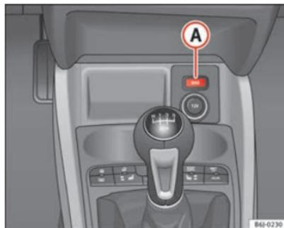
Abb. 98 Mittelkonsole: Kontrollschalter für Autogasanlage.
