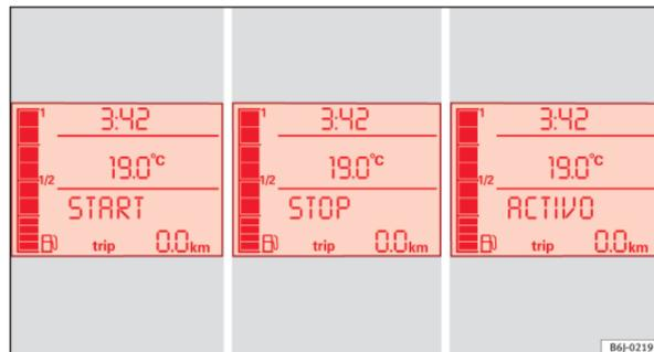
Abb. 100 Anzeige am Display des Kombiinstrumentes während des Start-Stopp-Betriebs
