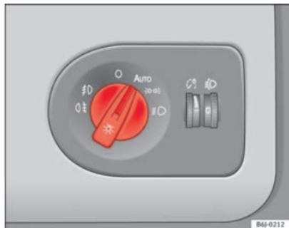
Abb. 54 Automatisches Fahrlicht
