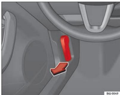
Abb. 121 Öffnungshebel für Motorraumklappe
