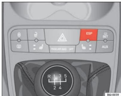
Abb. 96 Ansicht der Mittelkonsole: ESP-Taste
