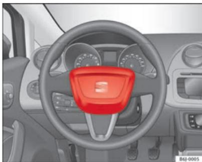
**Abb. 16 Einbaut Frontairbag: im Lenkrad**
