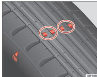
Abb. 130 Prinzipdarstellung Reifenprofil: Verschleißanzeiger
