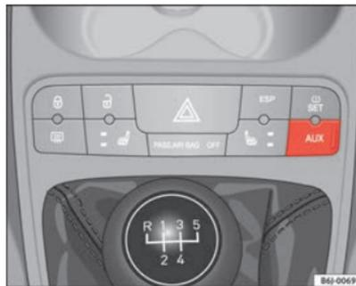
Abb. 86 AUX-Anschluss an der Mittelkonsole (ausstattungsabhängig)
