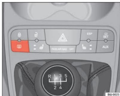
Abb. 57 Mittelkonsole: Schalter für Heckscheibenbeheizung
