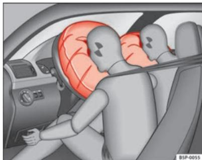
**Abb. 18** Aufgeblasene Frontairbags
