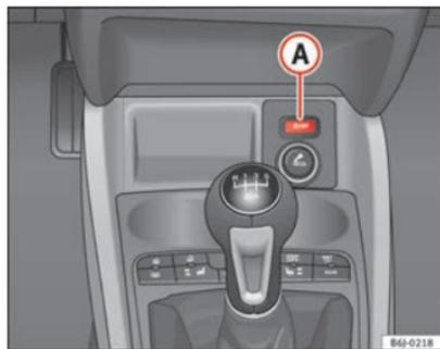
Abb. 99 Ansicht des Tasters für den Start-Stopp-Betrieb
