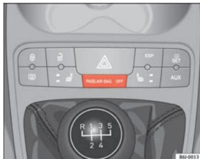
Abb. 22 Kontrollleuchte für Abschaltung der Beifahrerairbags
