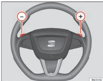
Abb. 107 Lenkrad mit Schaltwippen für Automatikgetriebe
