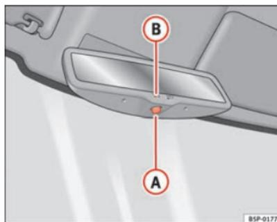
Abb. 66 Automatisch abblendbarer Innenspiegel
