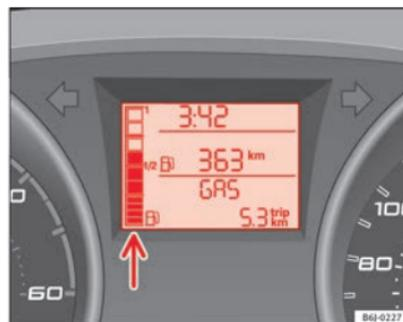
Abb. 31 Kombiinstrument: Gasvorratsanzeige
