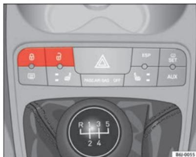
Abb. 43 Taster für Zentralverriegelung
