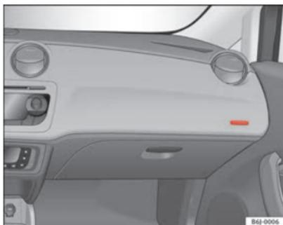
**Abb. 17 Einbaut Beifahrerairbag: in der Instrumententafel**
