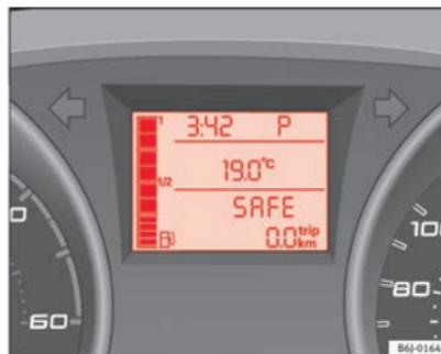
Abb. 36 Display: Wählhebelstellung des Automatikgetriebes
