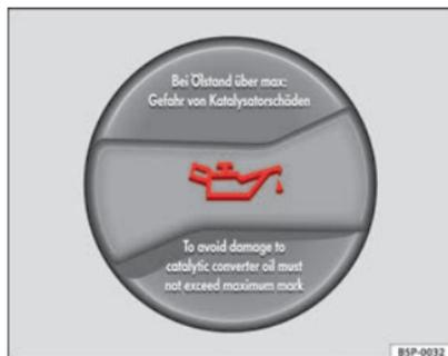
Abb. 124 Deckel der Motoröl-Einfüllöffnung im Motorraum
