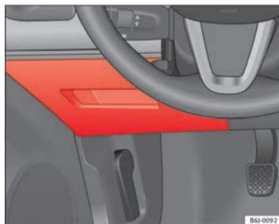
Abb. 137 Sicherungen in der Instrumententafel
