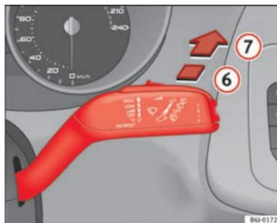
Abb. 65 Scheibenwischer- und Scheibenwaschhebel: Heckscheibenwischer
