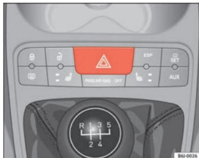
Abb. 58 Mittelkonsole: Schalter für Warnblinkanlage
