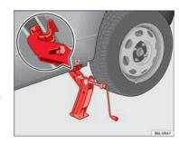
Fig. 135 Fitting the jack
