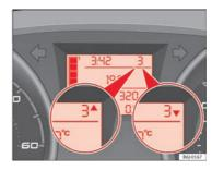
Fig. 33 Gear display
