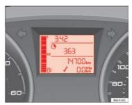
Fig. 37 Service interval display
