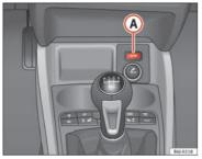
Fig. 99 The Start-Stop function button.
