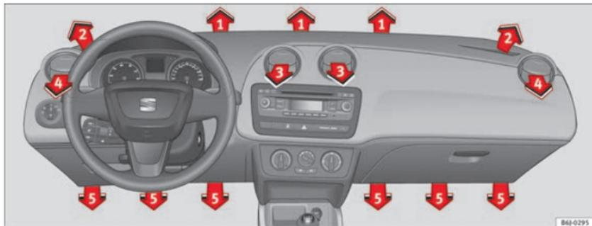
Fig. 92 Bocchette di ventilazione
