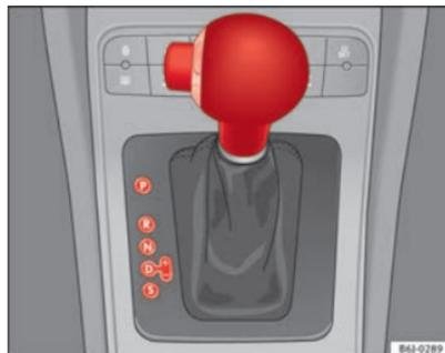
Fig. 104 Cambio automatico
