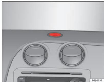
Fig. 78 Supporto per navigatore sul cruscotto.
