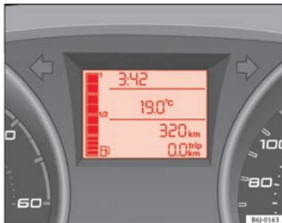
Fig. 32 Indicatore del livello del serbatoio carburante
