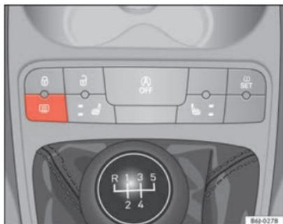
Fig. 57 Console centrale: interruttore del lunotto termico
