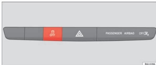
Fig. 97 Dettaglio della plancia portastrumenti: tasto ESC
