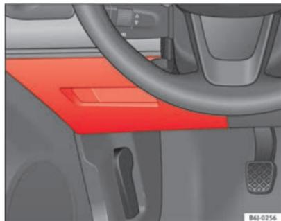
Fig. 142 Lato sinistro della plancia portastrumenti: coperchio della scatola dei fusibili.
