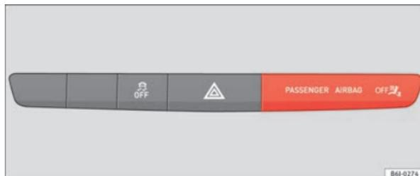
Fig. 22 Spia della disattivazione degli airbag del passeggero anteriore
