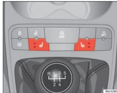
**Fig. 72** Interruttore per il riscaldamento dei sedili anteriori
