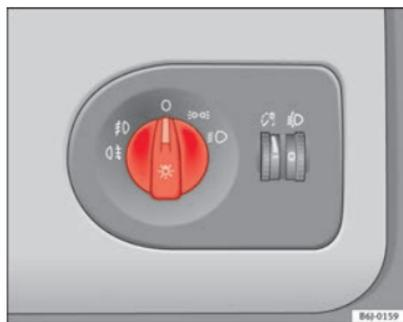
Fig. 53 Dettaglio della plancia portastrumenti: interruttore luci, fari fendinebbia e retronebbia
