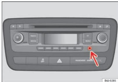
Fig. 87 Collegamento AUX nella consolle centrale (a seconda dell'equipaggiamento)
