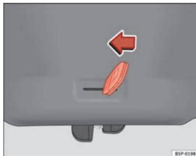
Fig. 49 Portellone posteriore: apertura d'emergenza
