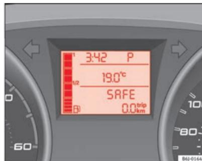
Fig. 36 Display: Posizione della leva del cambio automatico
