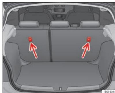
Fig. 27 Posizione degli occhielli Top Tether nella parte posteriore del sedile posteriore
