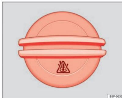
Fig. 128 Vano motore: tappo del serbatoio di compensazione del liquido di raffreddamento
