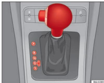
Fig. 107 Cambio di rapporto di marcia con Tiptronic
