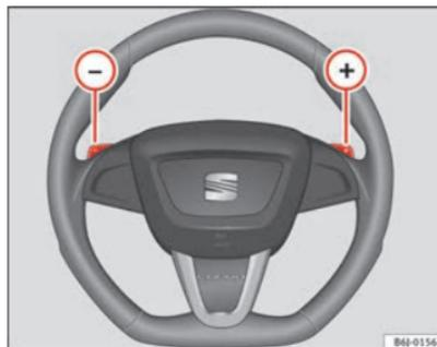
Fig. 108 Volante con leve per il cambio automatico
