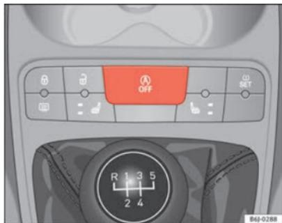
Fig. 100 Dettaglio del pulsante della modalità Start-Stop.
