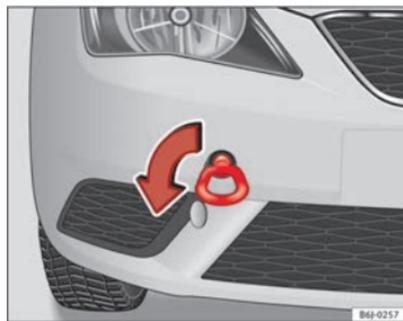
Fig. 175 Lato anteriore del veicolo: montaggio dell'anello per traino
