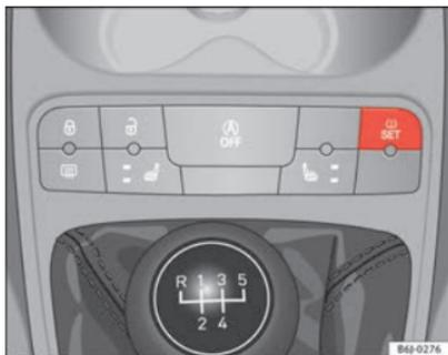
Fig. 40 Console centrale: tasto del sistema controllo dei pneumatici
