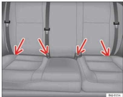
**Fig. 26 Occhielli di fissaggio del sistema ISOFIX**
