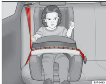
Fig. 24 Seggiolino del gruppo 1 montato sul sedile posteriore; il bambino siede rivolto verso il senso di marcia
