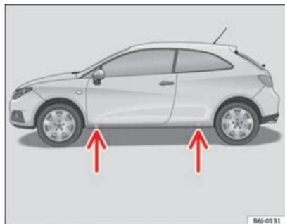
Fig. 139 Punti di appoggio per il cric
