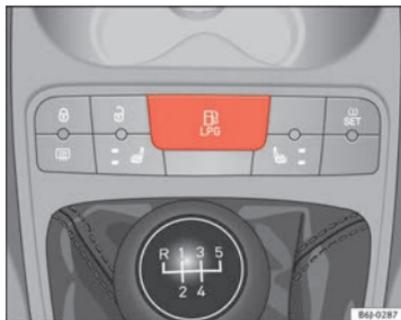
Fig. 99 Console centrale: tasto di commutazione dell'impianto a gas.
