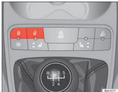
Fig. 43 Interruttore della chiusura centralizzata
