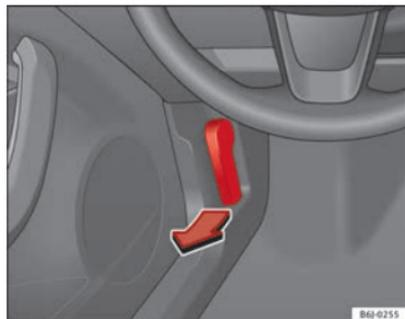
Fig. 124 Leva apertura cofano motore
