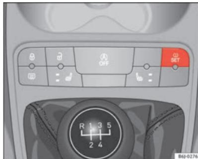
Fig. 40 Console centrale : touche du système de contrôle de la pression des pneus
