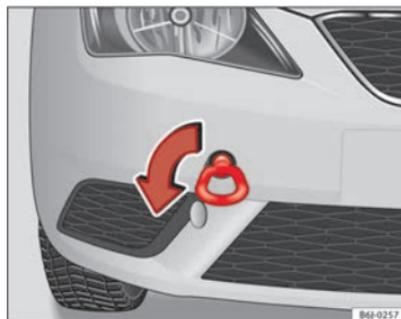
Fig. 175 Vissage de l'œillet de remorquage avant
