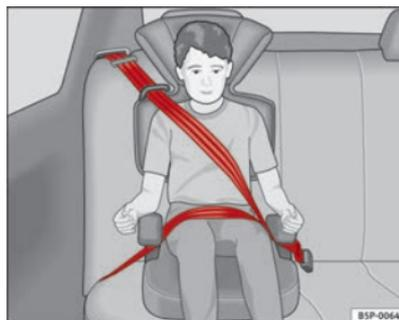
**Fig. 25** Siège pour enfant monté face à la route sur la banquette arrière.
