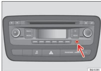
Fig. 87 Connexion AUX sur console centrale (en fonction de l'équipement)
