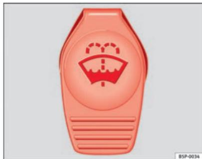
**Fig. 129** Dans le compartiment-moteur : bouchon de réservoir de lave-glace
