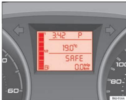
Fig. 109 Boîte automatique : écran du tableau de bord
