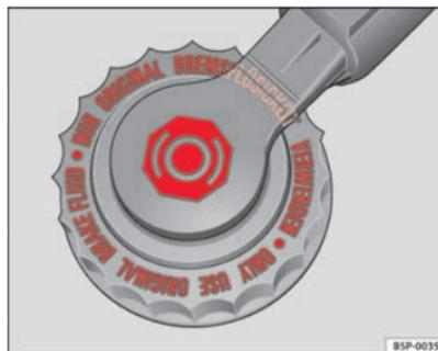
**Fig. 134** Dans le compartiment-moteur : bouchon de réservoir de liquide de frein
