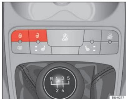
Fig. 43 Touche de verrouillage centralisé
