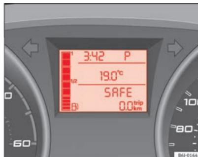
Fig. 105 Boîte automatique : écran du tableau de bord
