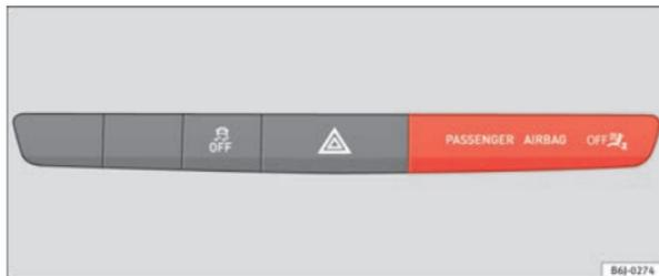
Fig. 22 Témoin de désactivation de l'airbag du passager
