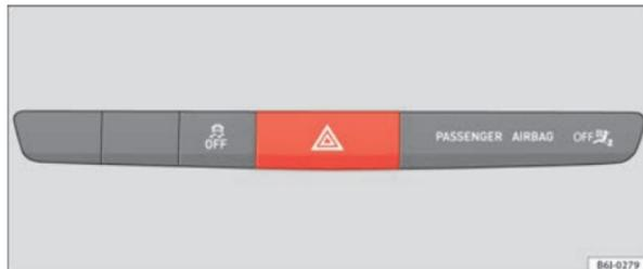
Fig. 58 Planche de bord : commande des feux de détresse
