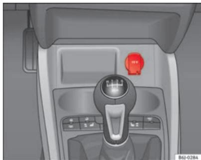
Fig. 86 Prise de courant avant
