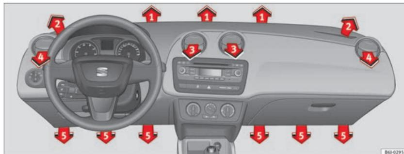
Fig. 92 Diffuseur d'air
