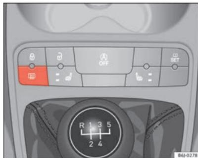
Fig. 57 Console centrale : contacteur de dégivrage de lunette arrière
