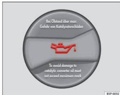
Fig. 127 Dans le compartiment-moteur : bouchon de l'orifice de remplissage d'huile moteur
