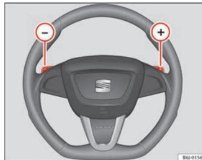
Fig. 108 Volant avec commandes pour boîte automatique
