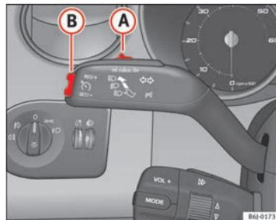
Fig. 117 Levier des clignotants et des feux de route : commande et touche basculante pour régulateur de vitesse ▶
