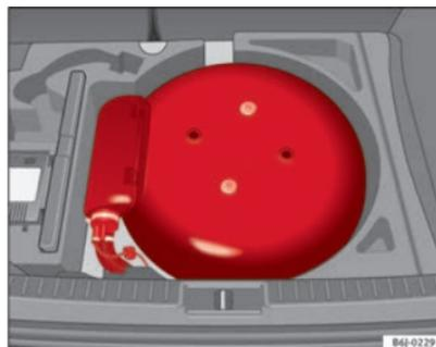
Fig. 122 Réservoir de GPL dans le cuvelage de la roue de secours.
