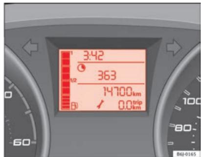
Fig. 37 Indicateur de maintenance
