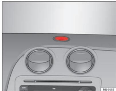
Fig. 78 Support pour navigateur sur la planche de bord.
