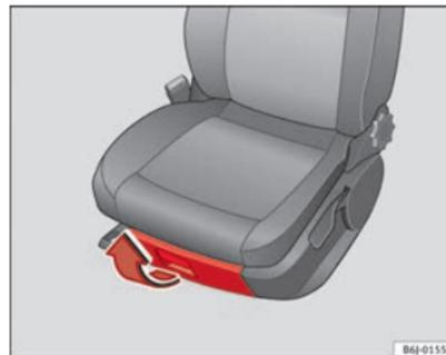
Fig. 80 Rangement sous le siège avant droit
