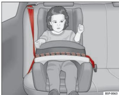
**Fig. 24** Siège pour enfant du groupe 1 monté face à la route sur la banquette arrière.
