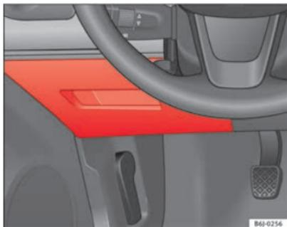
Fig. 142 Côté gauche du tableau de bord : cache du boîtier de fusibles.
