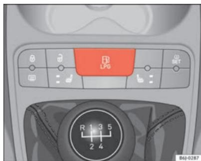
Fig. 99 Console centrale : contacteur de contrôle du système de gaz.
