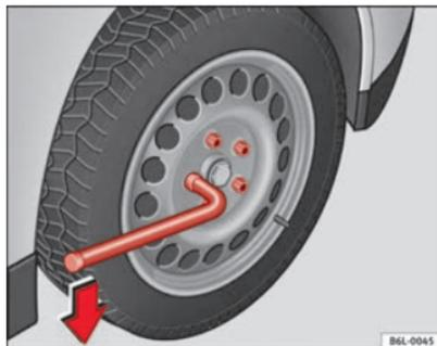
Fig. 138 Cambio de rueda: aflojar los tornillos de rueda
