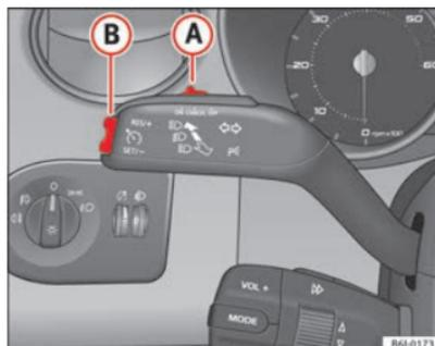
Fig. 117 Palanca de intermitentes y de luz de carretera: mando y tecla basculante para el regulador de velocidad
