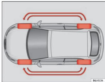
Fig. 136 Esquema para el cambio de ruedas
