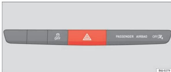
Fig. 58 Tablero de instrumentos: conmutador de los intermitentes de emergencia
