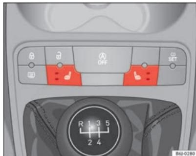
**Fig. 72** Conmutador de la calefacción de los asientos delanteros
