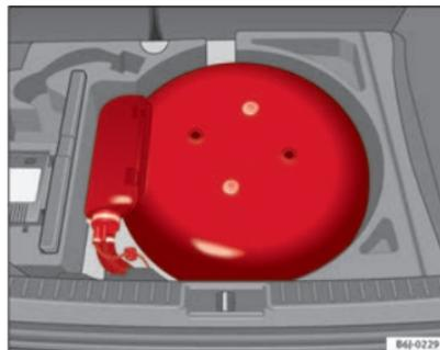
Fig. 122 Depósito de GLP en la cavidad de la rueda de repuesto.
