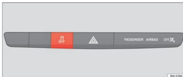
Fig. 97 Detalle del tablero de instrumentos: tecla ESC
