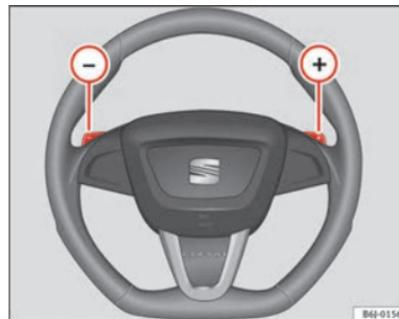
Fig. 108 Volante con levas para cambio automático
