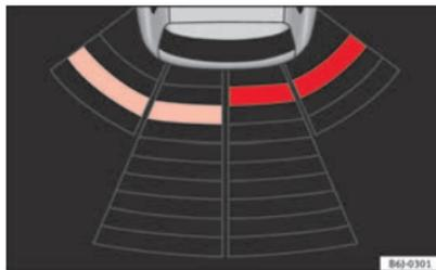
Fig. 111 Visualización de ayuda al aparcamiento en la pantalla del navegador.
