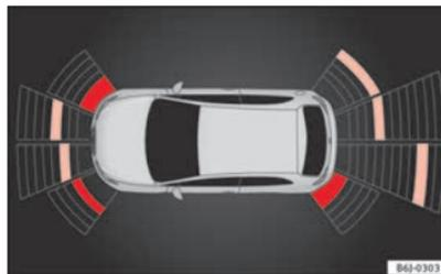
Fig. 112 Visualización de ayuda al aparcamiento en la pantalla del navegador.
