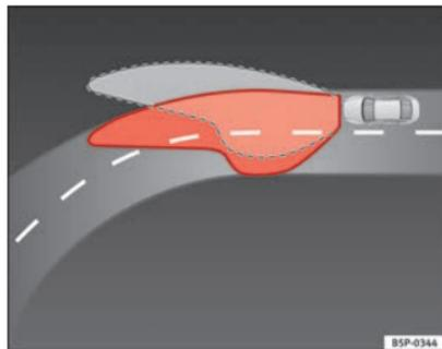
Fig. 56 Iluminación de la curva con faros autodireccionables
