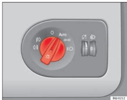
Fig. 54 Encendido automático de luces
