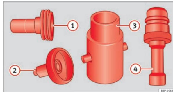
Fig. 123 Cuadro general de los adaptadores para la boca de carga de GLP.
