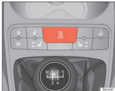
Fig. 99 Consola central: conmutador de control del sistema de gas.
