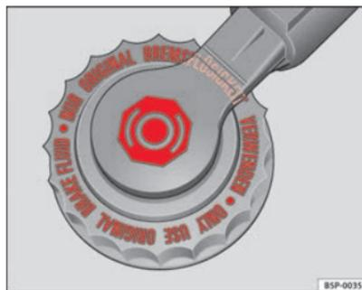
**Fig. 134** Tapón del depósito del líquido de frenos en el vano motor
