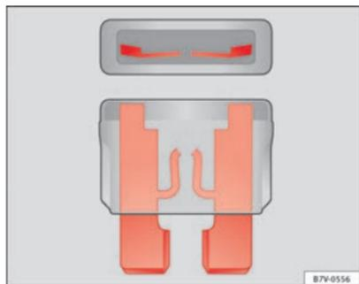
Fig. 144 Representación de un fusible fundido.
