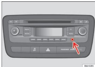
Fig. 87 Conexión AUX en consola central (en función del equipamiento)
