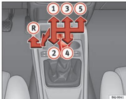
Fig. 102 Consola Central: esquema de un cambio manual de 5 marchas
