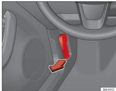
Fig. 124 Palanca apertura capó motor
