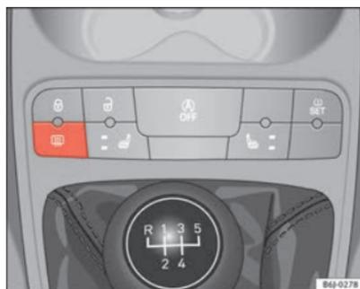
Fig. 57 Consola central: conmutador de luneta térmica
