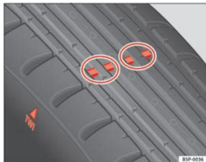
Fig. 135 Indicadores de desgaste del perfil del neumático
