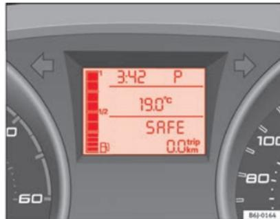
Fig. 105 Cambio automático: pantalla del cuadro de instrumentos
