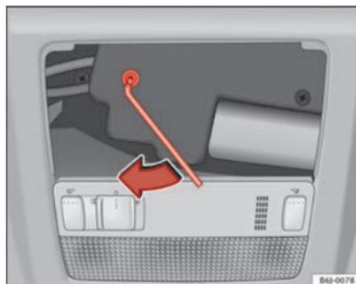
**Fig. 52** Accionamiento de emergencia techo panorámico/deflector
