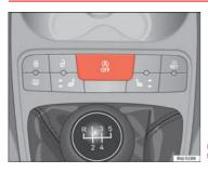
Fig. 100 The Start-Stop function button.
