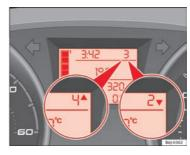
Fig. 33 Gear display
