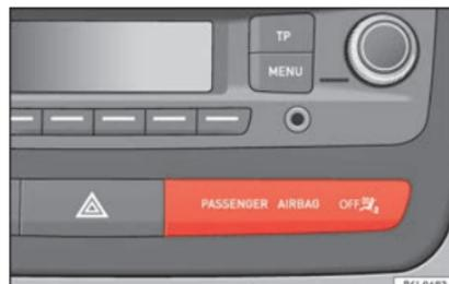
Fig. 62 Sulla parte centrale del quadro strumenti: spia della disattivazione degli airbag del passeggero anteriore.
