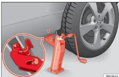
Fig. 161 Posizionamento del cric.
