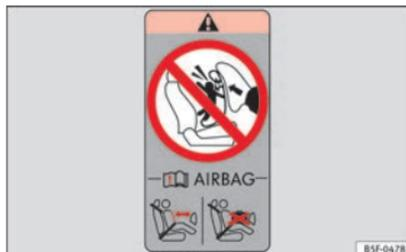
Fig. 64 Nella parte posteriore della porta del passeggero: adesivo relativo all'airbag.
