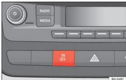
Fig. 140 Dettaglio della plancia portastrumenti: tasto ESC.
