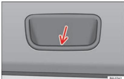
**Fig. 86** Dettaglio del rivestimento interno del portellone posteriore: maniglia di presa ad incavo.
