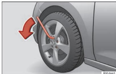
**Fig. 159** Cambio di una ruota: allentare le viti della ruota.
