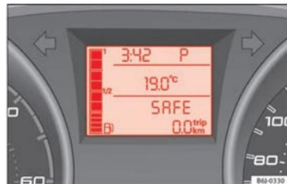
**Fig. 75** Display: Posizione della leva del cambio automatico.
