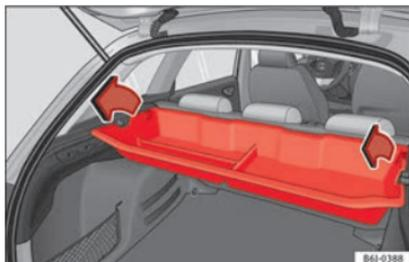
Fig. 121 Bagagliaio: smontaggio del cassetto portaoggetti.
