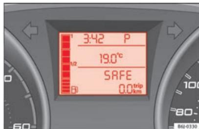
Fig. 134 Cambio automatico: display del quadro strumenti.
