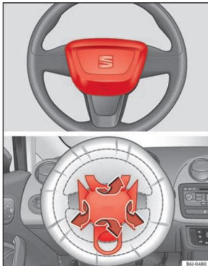
**Fig. 56** Airbag del conducente all'interno del volante.
