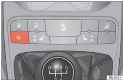
**Fig. 94** Console centrale: interruttore del lunotto termico.
