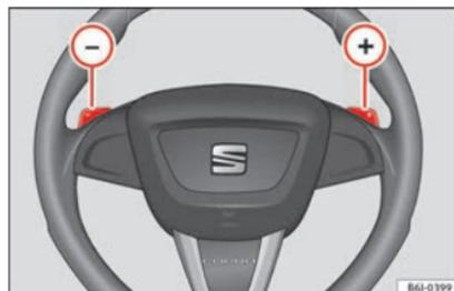
Fig. 137 Volante con leve per il cambio automatico.
