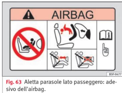
Fig. 63 Aletta parasole lato passeggero: adesivo dell'airbag.
