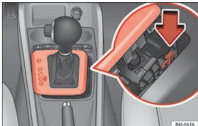
**Fig. 169** Sbloccaggio d'emergenza della leva selettore.
