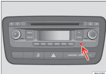
**Fig. 116** Console centrale: collegamento AUX.
