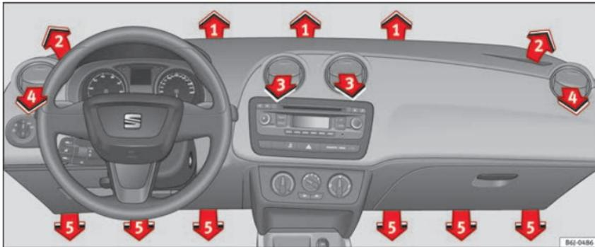
Fig. 127 Bocchette di ventilazione
