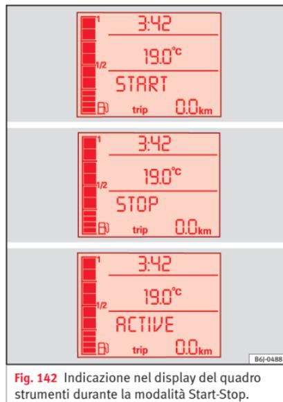
**Fig. 142** Indicazione nel display del quadro strumenti durante la modalità Start-Stop.
