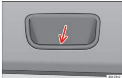
Fig. 86 Detalle del guarnecido interior del portón trasero: cavidad para tirar.
