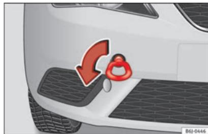
Fig. 166 Argolla de remolque delantera
