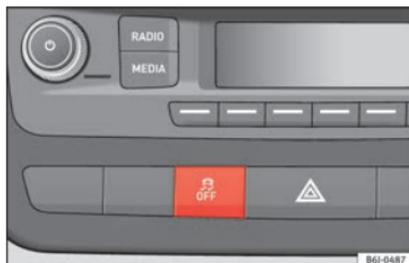
Fig. 140 Detalle del tablero de instrumentos: tecla ESC.
