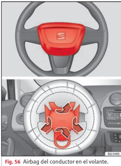
Fig. 56 Airbag del conductor en el volante.
