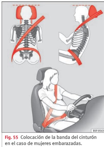
**Fig. 55** Colocación de la banda del cinturón en el caso de mujeres embarazadas.
