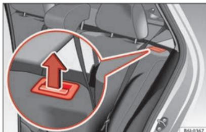
Fig. 102 Tecla de desbloqueo del respaldo trasero.
