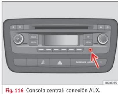
**Fig. 116** Consola central: conexión AUX.
