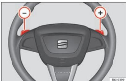
Fig. 137 Volante con levas para cambio automático.
