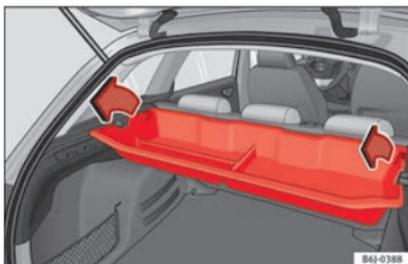
**Fig. 121** Maletero: desmontaje del cajón portaobjetos.
