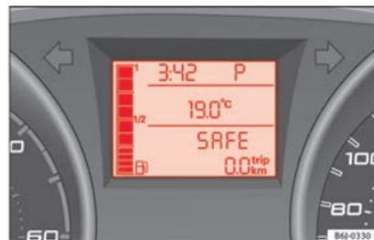
Fig. 75 Pantalla digital: Posición de la palanca del cambio automático.
