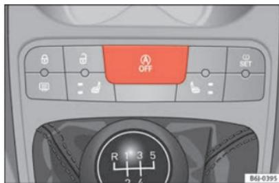
**Fig. 141** Detalle del pulsador del funcionamiento Start-Stop.
