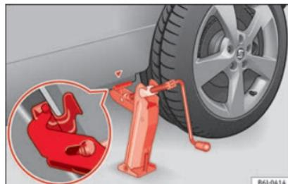
**Fig. 161** Colocación del gato.
