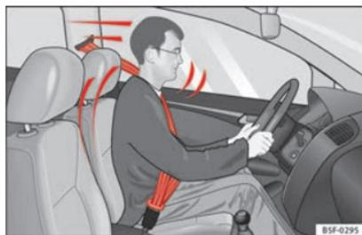
Fig. 51 Los conductores que lleven el cinturón de seguridad correctamente abrochado no saldrán lanzados en caso de un frenazo brusco.
