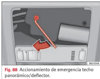
**Fig. 88** Accionamiento de emergencia techo panorámico/deflector.
