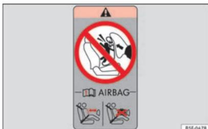
Fig. 64 En el marco posterior de la puerta del acompañante: adhesivo relativo al airbag.
