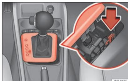
**Fig. 169** Desbloqueo de emergencia de la palanca selectora.
