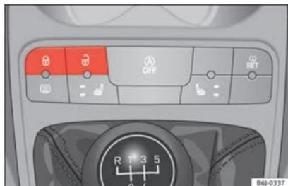
**Abb. 128** Taster für Zentralverriegelung
