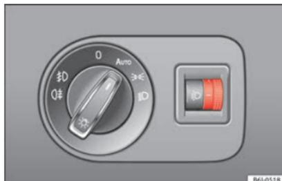
Abb. 134 Instrumententafel: Regler für Leuchtweitenregulierung.
