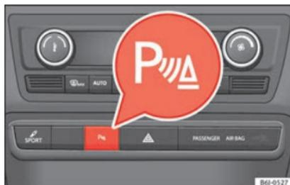
Abb. 177 Mittelkonsole: Taste für Einparkhilfe.
