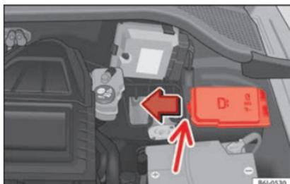
Abb. 58 Im Motorraum: Abdeckung des Sicherungskastens.
