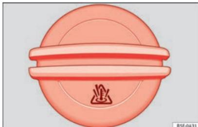
**Abb. 54** Motorraum: Deckel des Motorkühlmittelzugleichbehälters
