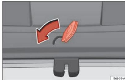
**Abb. 5** IBIZA ST: Notentriegelung der Heckklappe
