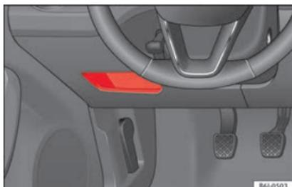
Abb. 57 Auf der Fahrerseite in der Instrumententafel: Abdeckung des Sicherungskastens.
