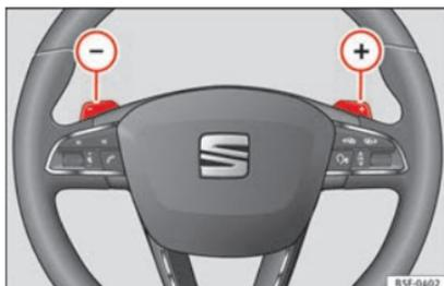
Abb. 172 Lenkrad mit Schaltwippen für Automatikgetriebe.
