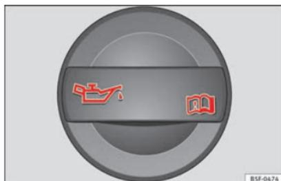
Abb. 53 Deckel der Motoröl-Einfüllöffnung im Motorraum
