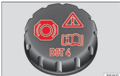
**Abb. 55** Motorraum: Deckel des Bremsflüssigkeitsbehälters
