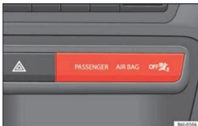
**Abb. 86** Instrumententafel-Mittelteil: Kontrollleuchte für abgeschalteten Beifahrer-Frontairbag.
