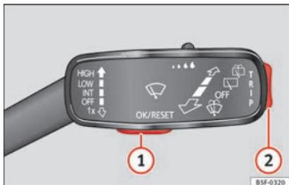
**Abb. 37** Scheibenwischerhebel: Steuertasten.
