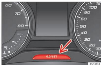
**Abb. 122** Kombi-Instrument: Kilometerzähler und Rückstellaste.
