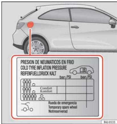
**Abb. 188** Einbauort des Aufklebers für den Reifenfülldruck.
