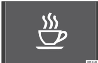
**Abb. 175** Im Display des Kombi-Instruments: Symbol der Müdigkeitserkennung.
