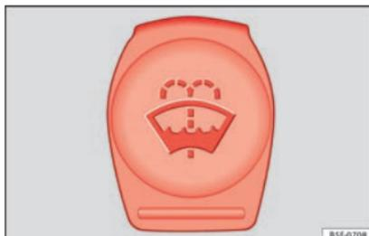
**Abb. 56** Im Motorraum: Deckel des Scheibenwaschbehälters.
