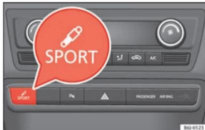
**Abb. 183** In der Mittelkonsole: Taste zur Einstellung des Systems "SEAT Drive Profile"
