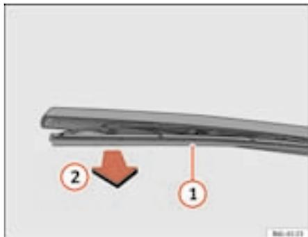
Fig. 130 Sostituzione della spazzola del tergilunotto
