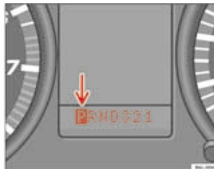
**Fig. 101** Display del quadro strumenti: bloccaggio della leva selettoria in posizione P
