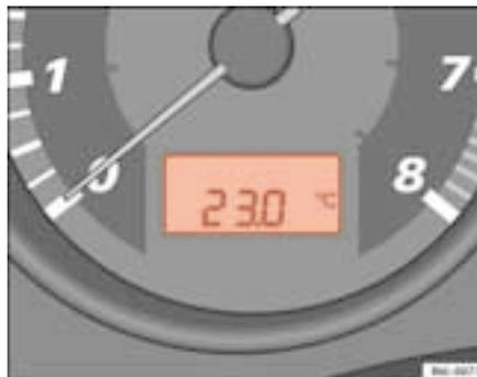
Fig. 37 Display digitale del quadro strumenti: indicatore della temperatura esterna.
