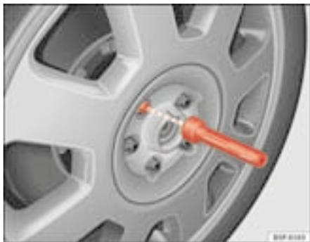
Fig. 139 Cambio della ruota: esagono cavo per svitare le viti
