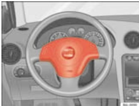
**Fig. 16** Airbag del conducente all'interno del volante
