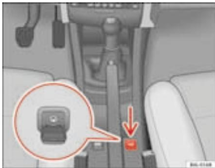
Fig. 86 Connettore per l'ingresso audio ausiliare
