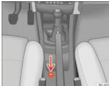
**Fig. 96** Dettaglio della console centrale: il tasto dell'ESP
