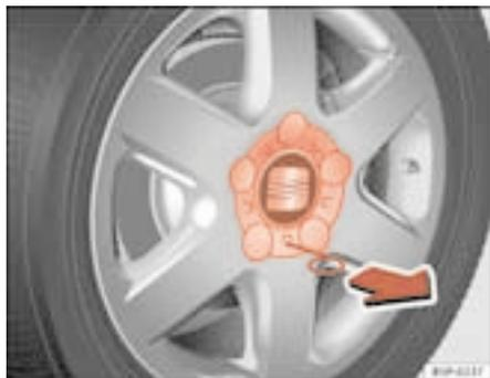
Fig. 134 Cambio di una ruota: rimuovere il coprismozzo della ruota
