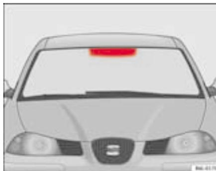
**Fig. 68** Parabrezza con rivestimento in metallo (superficie rossa)
