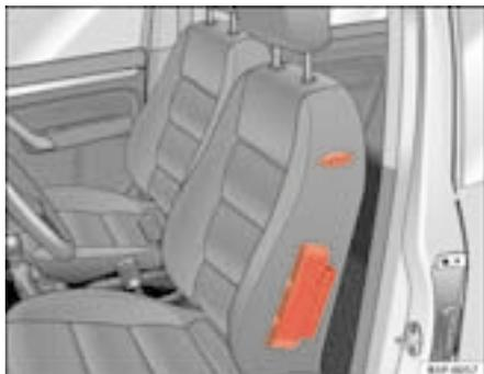
**Fig. 20** Airbag laterale all'interno del sedile del conducente
