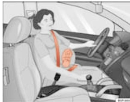
Fig. 14 Posizione della cintura di sicurezza per donne in stato di gravidanza
