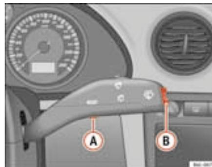
Fig. 34 Leva dei tergilavacrystalli: tasto A ed interruttore B
