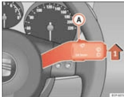
**Fig. 66** Leva dell'impianto tergicristalli
