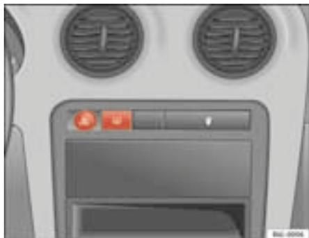
Fig. 58 Plancia degli strumenti: interruttore del lunotto termico
