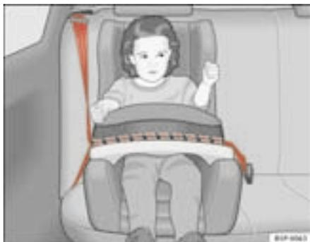
**Fig. 27** Seggiolino del gruppo 1 montato sul sedile posteriore; il bambino siede rivolto verso il senso di marcia
