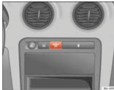
Fig. 25 Spia della disattivazione degli airbag del passeggero anteriore
