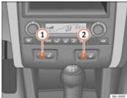
**Fig. 75** Rotelle zigrinate per il riscaldamento dei sedili anteriori
