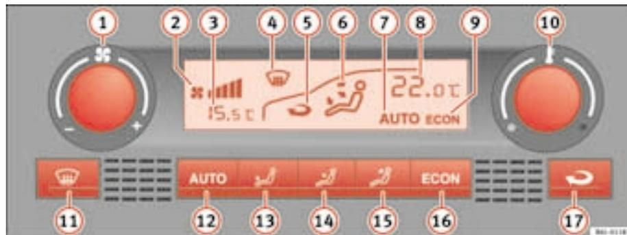
Fig. 93 Sulla plancia della strumentazione: comandi del Climatronic
