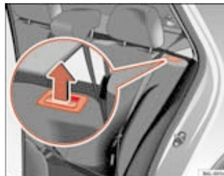
**Fig. 77** Tasto di sbloccaggio dello schienale del sedile posteriore
