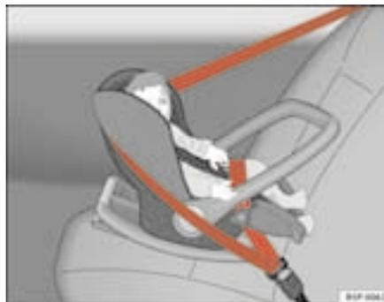
**Fig. 26** Seggiolino per bambini del gruppo 0, montato sul sedile posteriore e disposto nel senso contrario a quello di marcia
