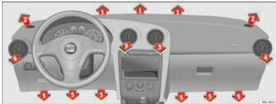
Fig. 90 Bocchette di ventilazione
