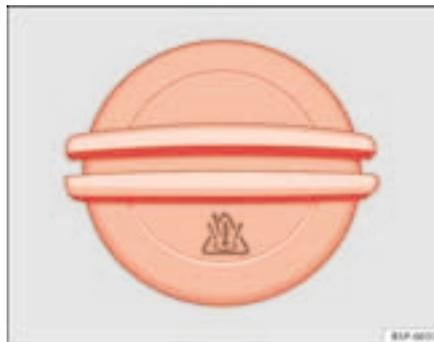
Fig. 127 Vano motore: tappo del serbatoio di compensazione del liquido di raffreddamento
