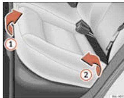
**Fig. 76** Sollevare l'elemento orizzontale del sedile posteriore
