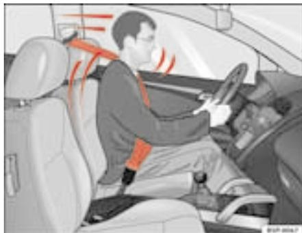
**Fig. 10** Conducente che, durante una frenata brusca, viene trattenuto dalla cintura di sicurezza correttamente allacciata
