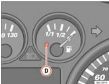
**Fig. 33** Indicatore del livello del serbatoio carburante
