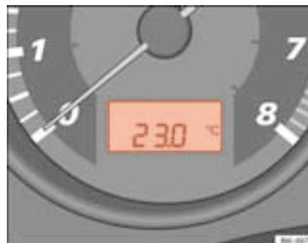
Fig. 35 Display digitale del quadro strumenti: indicatore della temperatura esterna
