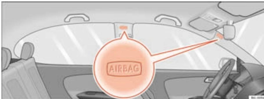
**Fig. 22** Ubicazione degli airbag per la testa, lato sinistro del veicolo
