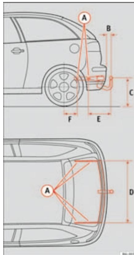
**Fig. 121** Puntos de fijación del dispositivo de remolque
