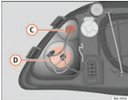
Fig. 144 Lámpara del faro principal
