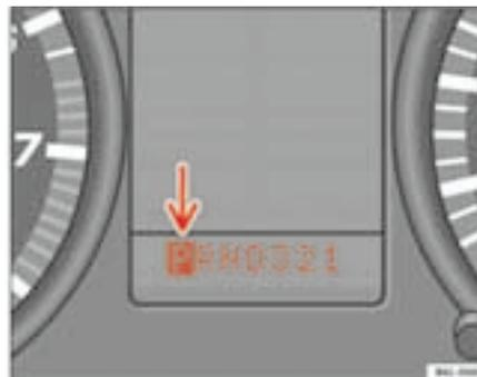
**Fig. 101** Pantalla del cuadro de instrumentos: bloqueo de la palanca selectora en la posición P
