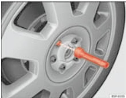
Fig. 139 Cambio de rueda: Útil de hexágono interior para girar los tornillos
