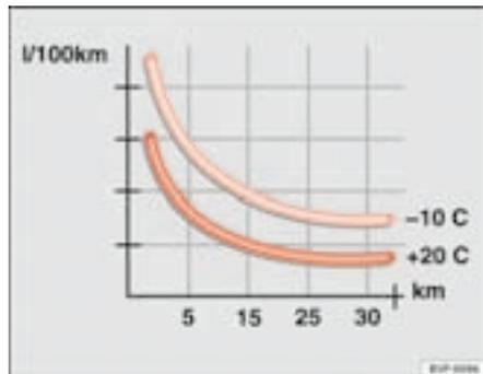
Fig. 120 Consumo de combustible (l/100 km) a dos temperaturas ambiente
