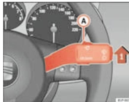
**Fig. 66 Palanca del limpiaparabrisas**
