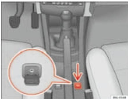
Fig. 86 Conector para la entrada auxiliar de audio
