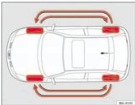
Fig. 133 Esquema para el cambio de ruedas
