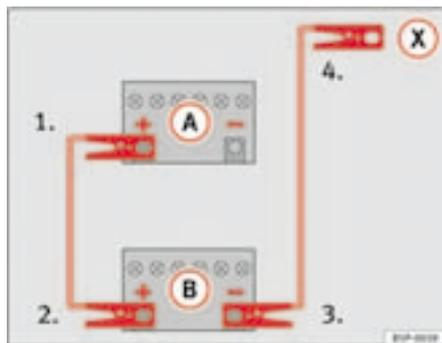
Fig. 165 Esquema de conexión de los cables de emergencia
