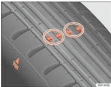
Fig. 132 Indicadores de desgaste del perfil del neumático
