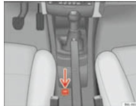
Fig. 96 Detalle de la consola central: tecla ESP
