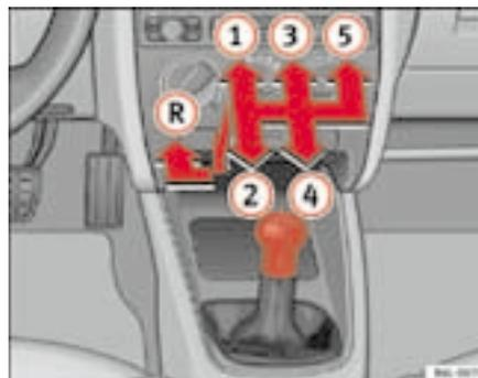
Fig. 98 Consola Central: esquema de un cambio manual de 5 marchas
