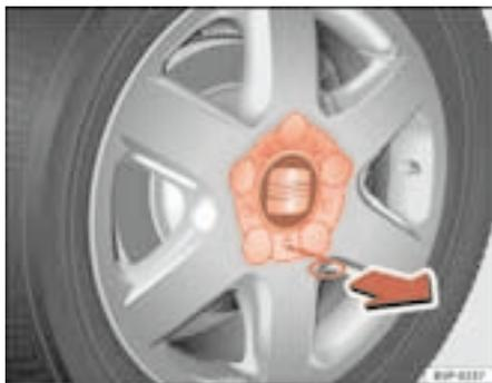
**Fig. 134** Cambio de rueda: Retirar el embellecedor de la rueda
