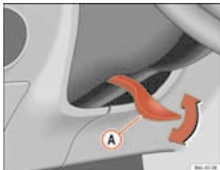
Fig. 94 Ajuste de la posición del volante
