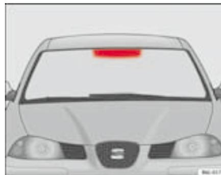
**Fig. 68** Parabrisas con revestimiento de metal (superficie roja)
