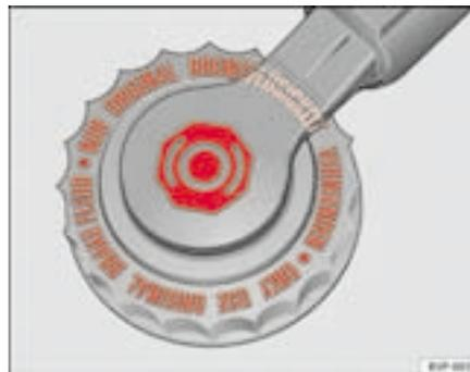
Fig. 131 Tapón del depósito del líquido de frenos en el vano motor
