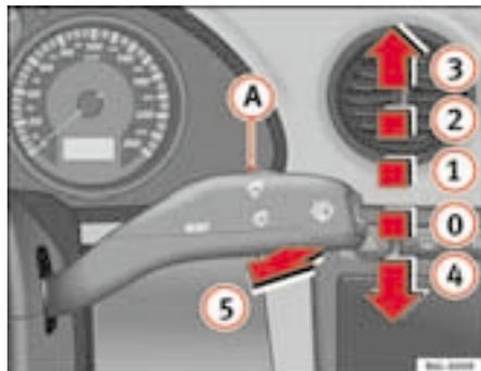
Fig. 65 Palanca del limpia-lavacristales
