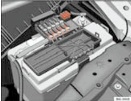
Fig. 142 Caja de fusibles sobre la batería
