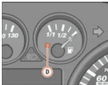
Fig. 33 Indicador de nivel del depósito de combustible
