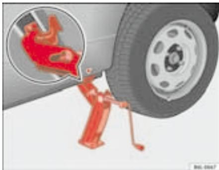
Fig. 138 Colocación del gato
