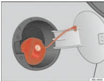
**Fig. 122** Tapa del depósito abierta
