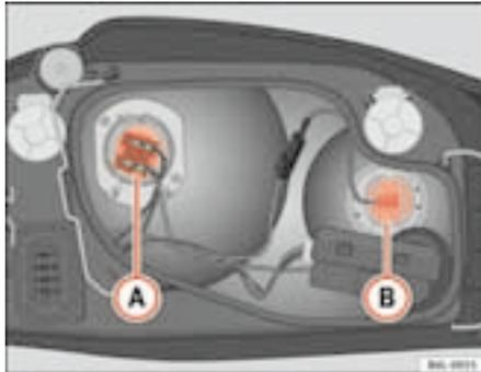
Fig. 143 Lámpara del faro principal
