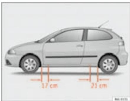
Fig. 137 Puntos de apoyo del gato
