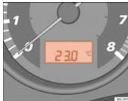
Fig. 35 Pantalla digital del cuadro de instrumentos: indicador de la temperatura exterior
