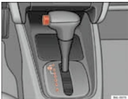
**Fig. 100** Consola central: palanca selectora del cambio automático
