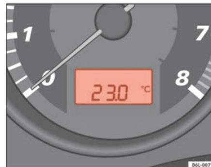
Fig. 36 Visor digital do painel de instrumentos: indicador da temperatura exterior
