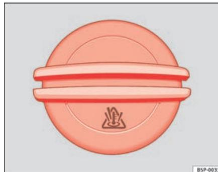
**Fig. 130** Tampão do reservatório de expansão do líquido de refrigeração no compartimento do motor
