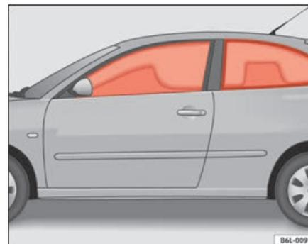
**Fig. 24 Airbags da cabeça activados**
