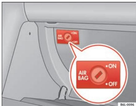
Fig. 25 No porta-luvas: interruptor com chave para activar e desactivar o airbag do acompanhante
