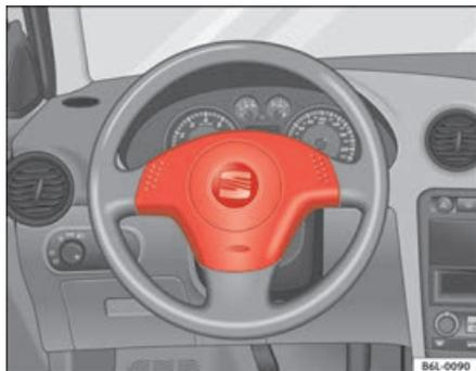
**Fig. 17** Airbag do condutor no volante
