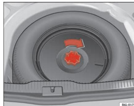
Fig. 139 Fixar a roda substituída
