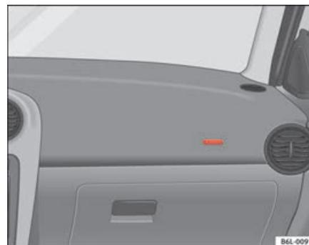
**Fig. 18** Airbag do passageiro no painel de instrumentos
