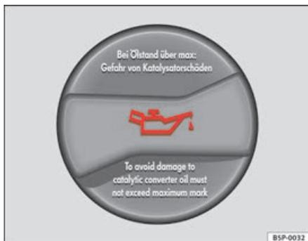
**Fig. 129** Tampão da abertura de enchimento do óleo do motor no compartimento do motor
