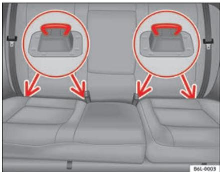
**Fig. 30** Anéis de fixação ISOFIX
