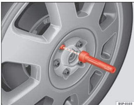
Fig. 145 Troca da roda: utensílio de sextavado interior para desapertar e apertar os parafusos
