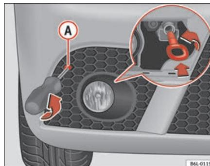
Fig. 172 Argola de rebocagem dianteira
