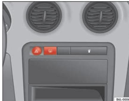
Fig. 60 Painel de instrumentos: interruptor das luzes de emergência
