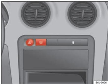
Fig. 59 Painel de instrumentos: interruptor do desembaciador do vidro traseiro
