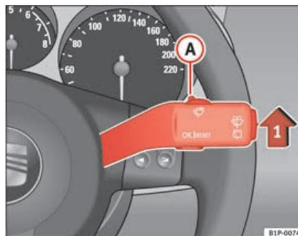
Fig. 67 Alavanca do limpa-vidros
