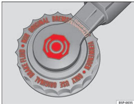
**Fig. 134** Tampão do reservatório do líquido de travões no compartimento do motor
