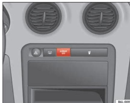
Fig. 26 Luz avisadora da desactivação do airbag do acompanhante
