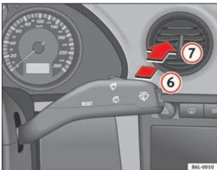
Fig. 68 Alavanca do limpa/lava-vidros: limpa-vidros traseiro
