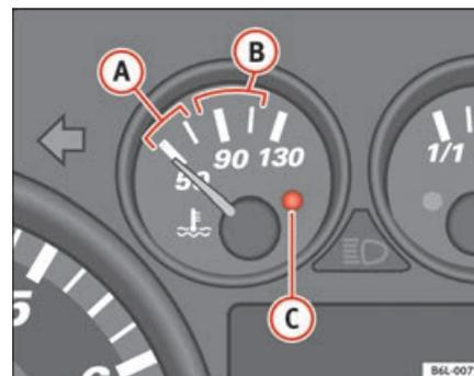
Fig. 33 Indicador da temperatura do líquido de refrigeração do motor
