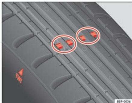
Fig. 135 Perfil do pneu: indicador de desgaste
