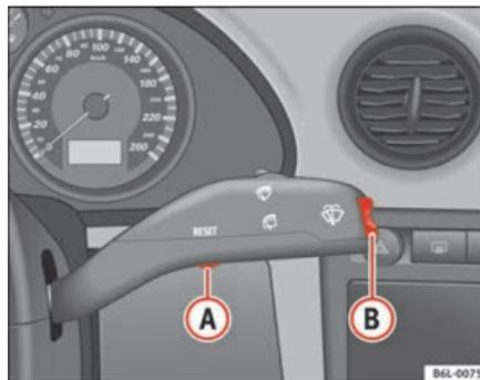
Fig. 37 Alavanca do limpa/lava-vidros: botão A e botão basculante B
