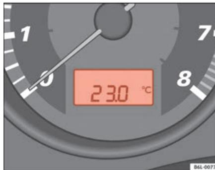
Fig. 38 Visor digital do painel de instrumentos: indicador da temperatura exterior.
