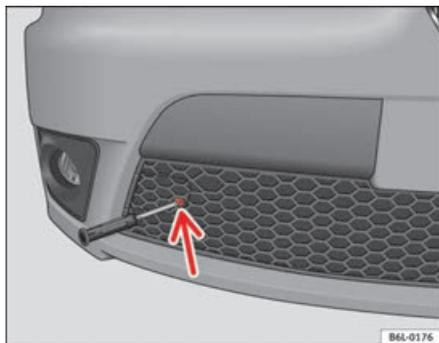
**Fig. 173** Tampa da argola situada na grelha central inferior
