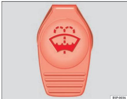
Fig. 131 Tampa do depósito do limpa-vidros no compartimento do motor.
