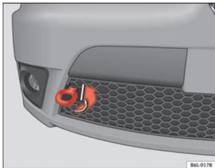
Fig. 175 Argola de rebocagem dianteira
