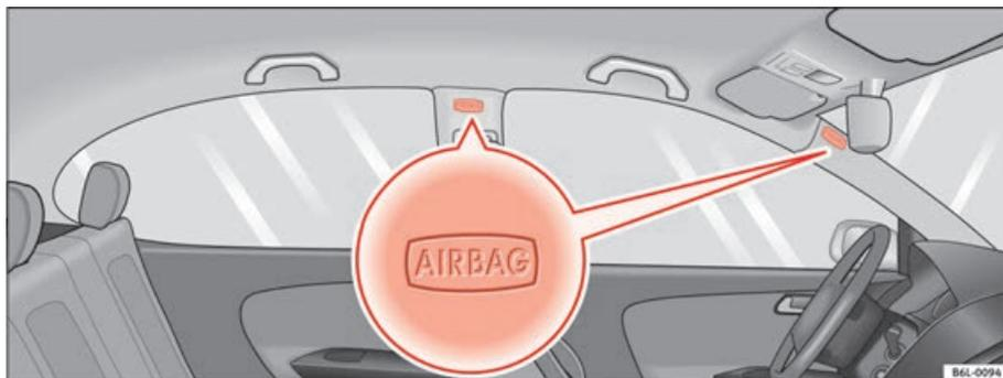
**Fig. 23** Localização de montagem dos airbags da cabeça do lado esquerdo do veículo
