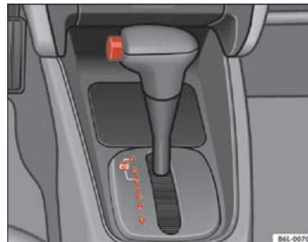
Fig. 102 Consola central: alavanca selectora da caixa de velocidades automática
