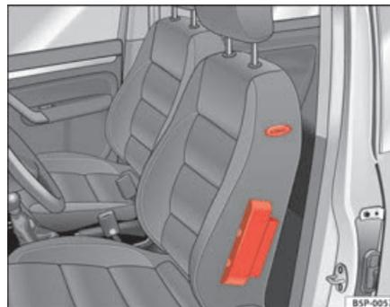
**Fig. 21** Airbag lateral no banco do condutor
