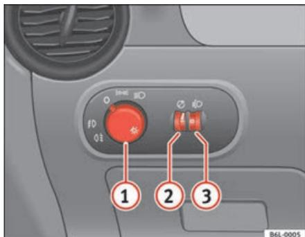
Fig. 57 Dettaglio della plancia portastrumenti: interruttore luci, fari fendinebbia e retronebbia
