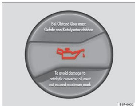
**Fig. 129 Vano motore: tappo del bocchettone di rifornimento dell'olio motore**
