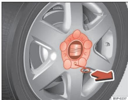
Fig. 140 Cambio di una ruota: rimuovere il coprimozzo della ruota
