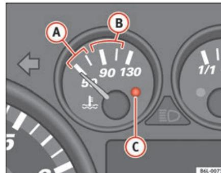
Fig. 33 Liquido di raffreddamento, temperatura del ~
