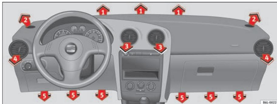
Fig. 93 Bocchette di ventilazione
