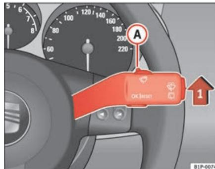
Fig. 67 Leva dell'impianto tergicristalli
