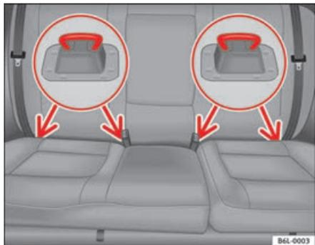
**Fig. 30** Maniglie di fissaggio del sistema ISOFIX
