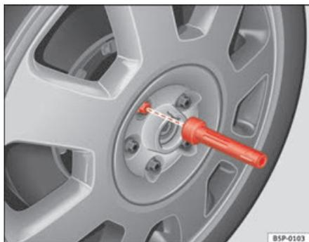
Fig. 145 Cambio di una ruota: utensile ad esagono cavo per svitare le viti
