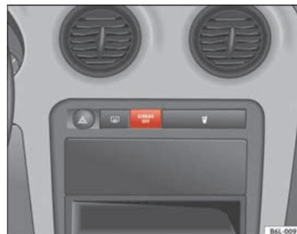
Fig. 26 Spia della disattivazione degli airbag del passeggero anteriore
