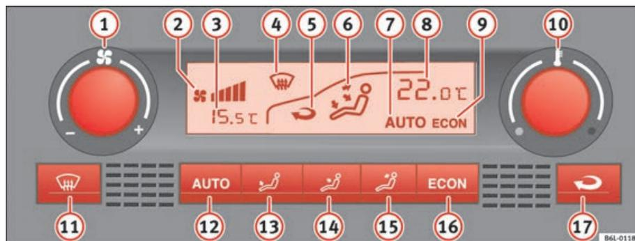
Fig. 96 Sulla plancia della strumentazione: comandi del Climatronic
