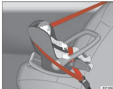
**Fig. 27** Seggiolino per bambini del gruppo 0, montato sul sedile posteriore e disposto nel senso contrario a quello di marcia
