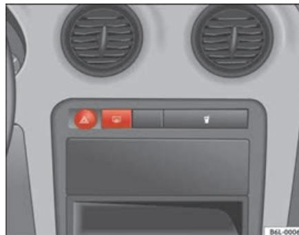
**Fig. 60** Plancia portastrumenti: interruttore lampeggio di emergenza
