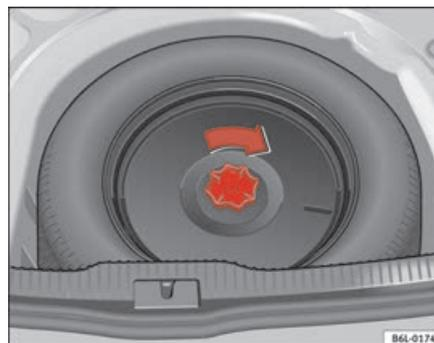
Fig. 139 Fissaggio della ruota sostituita
