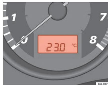
Fig. 36 Display digitale del quadro strumenti: indicatore della temperatura esterna
