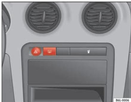
**Fig. 59** Plancia portastrumenti: interruttore del lunotto termico
