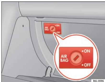
Fig. 25 Cassetto ripostigli: interruttore a chiave per la disattivazione e la riattivazione degli airbag del passeggero
