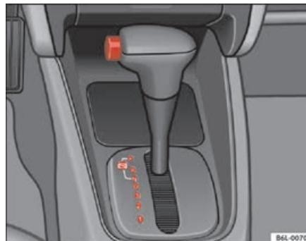
**Fig. 102 Console centrale: leva selettore del cambio automatico**
