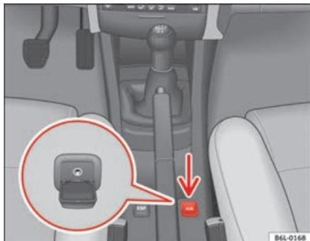
Fig. 87 Connettore per l'ingresso audio ausiliare
