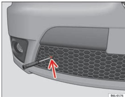
**Fig. 173** Coperchio situato nella griglia centrale inferiore
