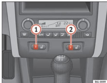
**Fig. 76** Rotelle zigrinate per il riscaldamento dei sedili anteriori
