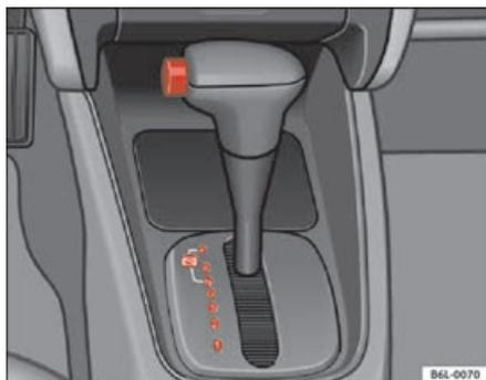
**Fig. 103 Console centrale : Levier sélecteur de boîte de vitesses automatique**
