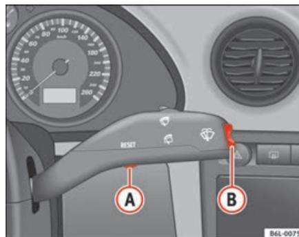
Fig. 37 Levier d'essuie-glace et de lave-glace : touche A et commande à bascule B
