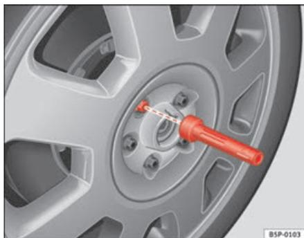
Fig. 145 Changement d'une roue : Outil à six pans creux pour tourner les boulons
