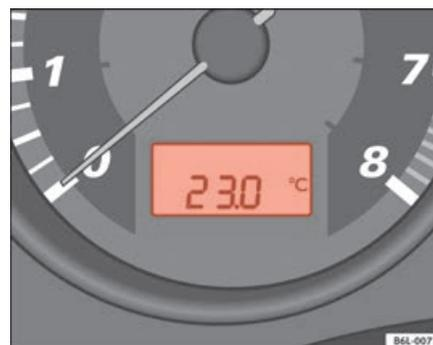
Fig. 36 Afficheur numérique du combiné d'instruments : affichage de la température extérieure
