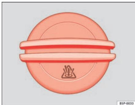
Fig. 130 Dans le compartiment-moteur : bouchon du vase d'expansion du liquide de refroidissement
