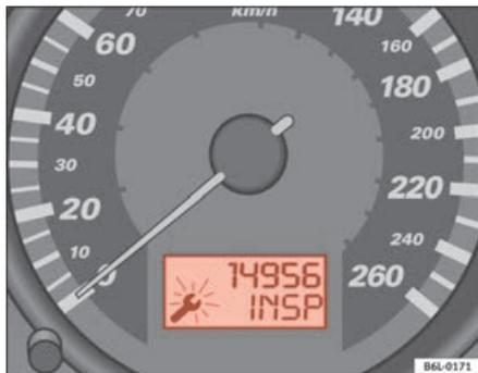
Fig. 39 Indicateur de maintenance
