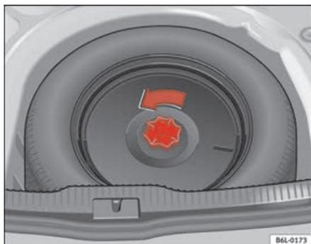
**Fig. 138** Accès à la roue de secours
