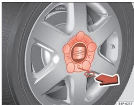
Fig. 140 Changement d'une roue : Retirer l'enjoliveur de roue
