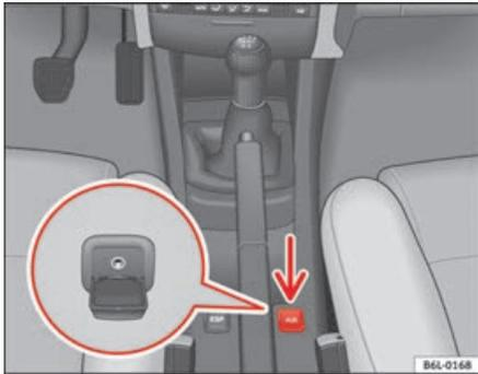
Fig. 87 Connecteur pour l'entrée auxiliaire audio
