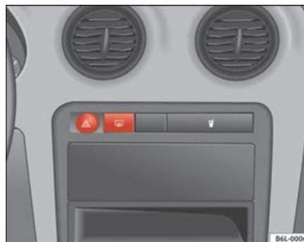
Fig. 60 Tableau de bord : touche d'activation du signal de détresse.
