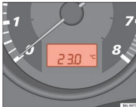
Fig. 38 Afficheur numérique du combiné d'instruments : affichage température extérieure.
