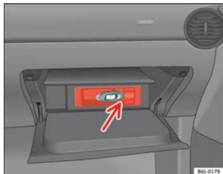
Fig. 89 Connexion USB\* dans la boîte à gants côté passager.
