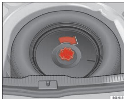
**Fig. 139** Fixation de la roue remplacée
