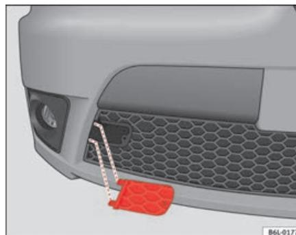
**Fig. 174** Cache-œillet situé dans la grille centrale inférieure
