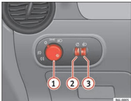
Fig. 57 Vue partielle du tableau de bord : commande des feux, feux antibrouillards avant et arrière
